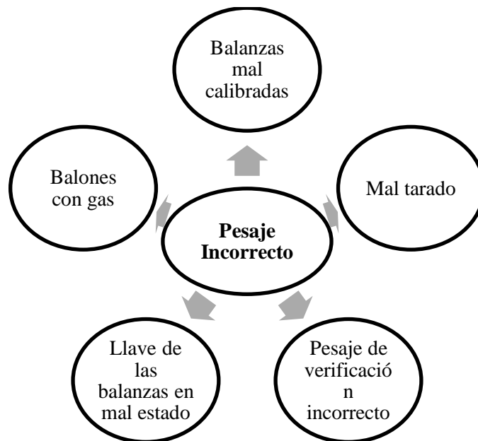
Figura 12. Posibles Causas del Pesaje Incorrecto en un Balón de Gas.
