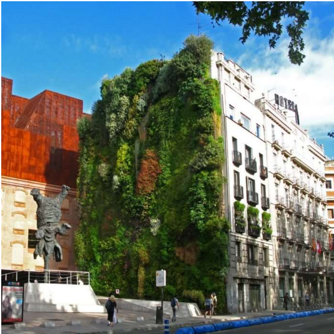
Una fachada vegetal se comporta como una superficie menos reflectante que otros acabados convencionales.
