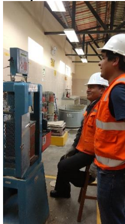
Fotografía 18: Ensayo de resistencia a compresión.
