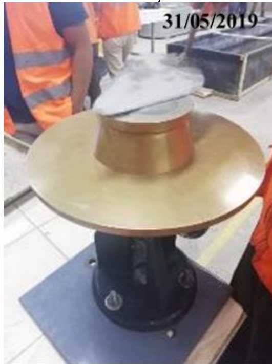
Fotografía 32: Enrasado de mezcla de agua con cemento
