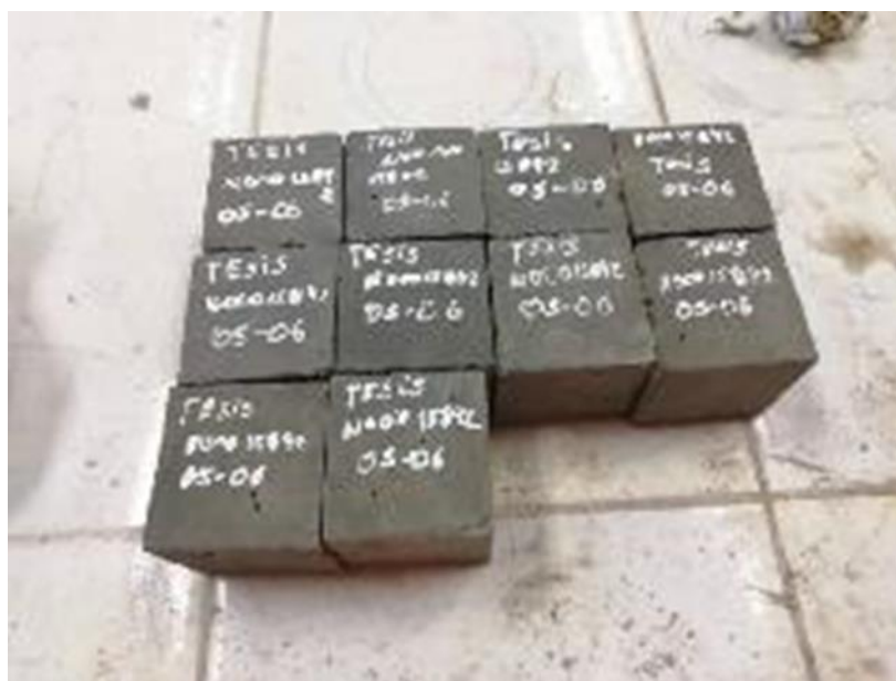
Figura 2: Cubos de mortero; según el instituto del cemento y del hormigón de Chile en 2010, el mortero es utilizado para pegar unidades de albañilería entre sí. En ocasiones, es recomendable utilizar aditivos para mejorar propiedades de consistencia, retención de agua, tiempo de fraguado, etc. Puede ser fabricado en obra o predosificado.
