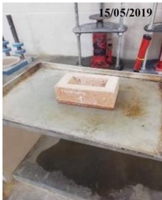
Fotografía 33: Succión de agua del ladrillo de arcilla
