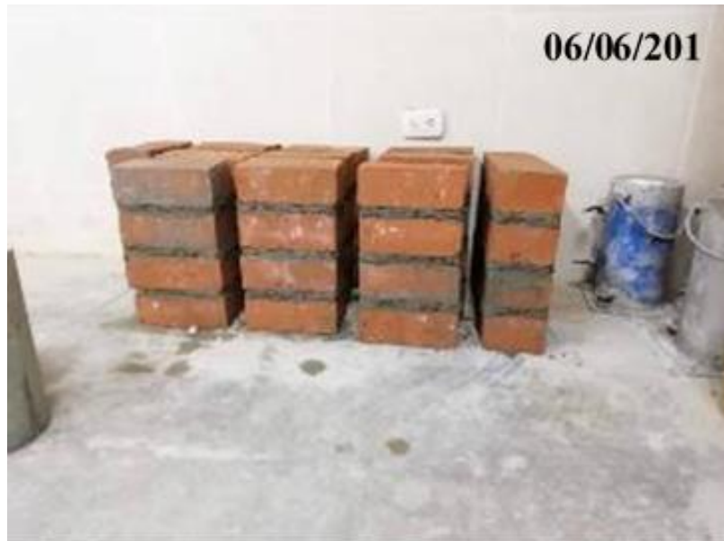
Fotografía 38: Elaboración de pilas de albañilería en relación 1:2.8
