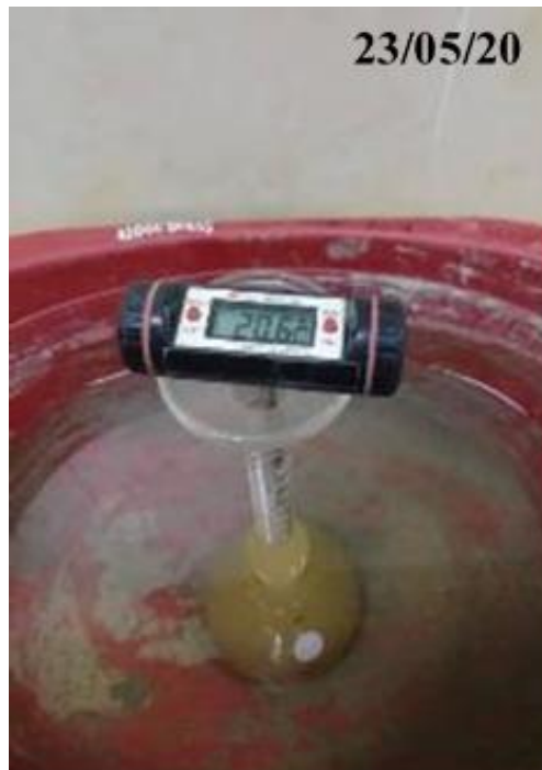
Fotografía 29: Baño maría con muestra de cemento y nafta
