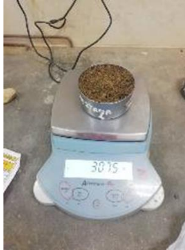
Fotografía 4: Peso de tara + muestra húmeda
