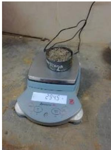
Fotografía 5: Peso de tara + muestra seca
