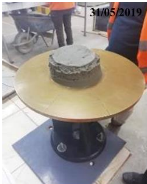
Fotografía 31: Mezcla al retirar el molde
