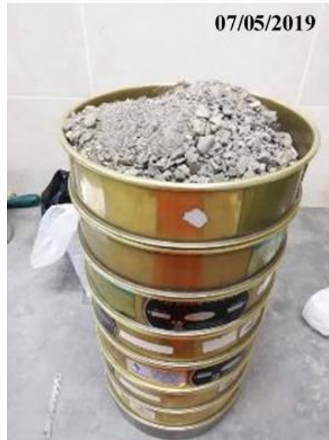
Fotografía 21: Tamizado de la arena gruesa de río
