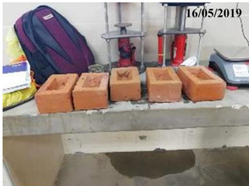
Fotografía 35: Unidades de albañilería saturados en agua durante 24 horas
