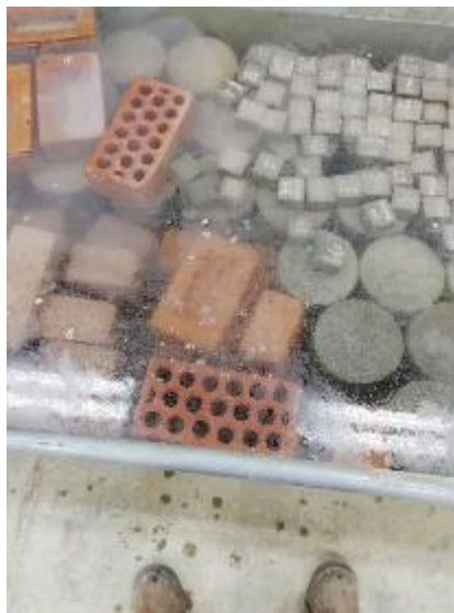
Fotografía 16: Saturado de las unidades de albañilería para ensayo de Absorción.
