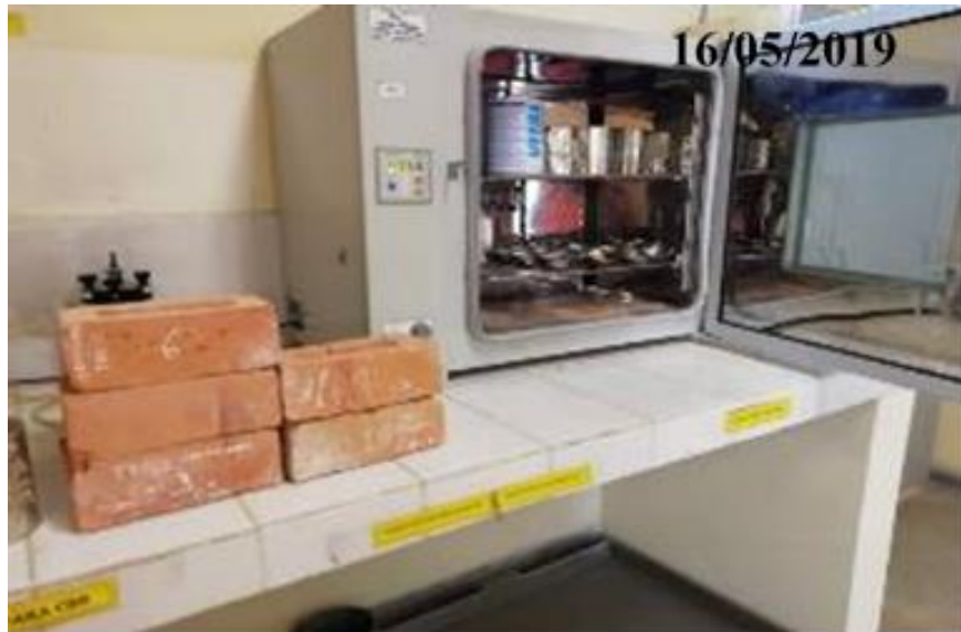
Fotografía 34: Secado de unidades de albañilería en horno
