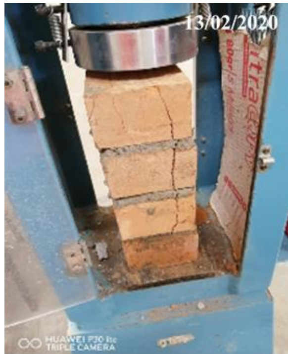
Fotografía 39: Pila de albañilería con fibra de acero trefilado cortado, siendo aplicado a compresión
