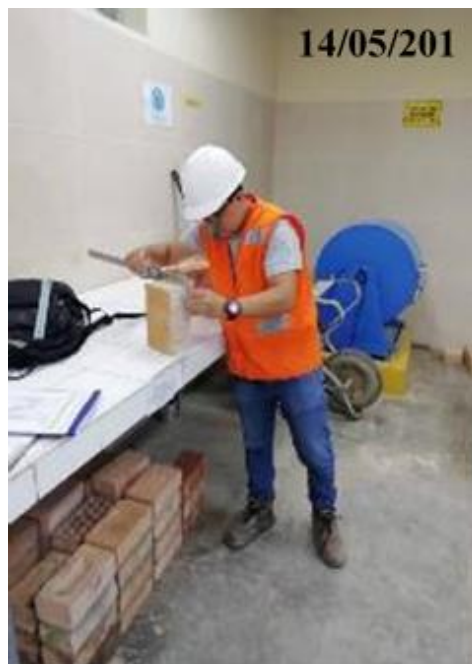
Fotografía 27: Tomando medidas de la unidad de albañilería
