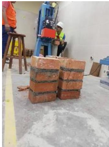
Fotografía 19: Pilas de albañilería, luego de ser aplicadas a compresión.
