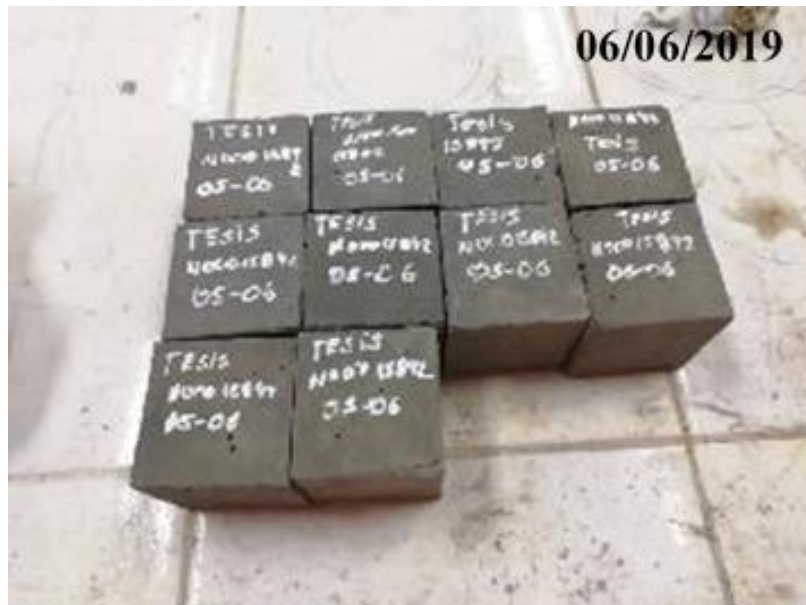
Fotografía 36: Cubos de mortero en relación 1:2.8
