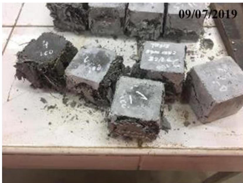
Fotografía 37: Morteros con fibra de acero trefilado luego de ser aplicados a compresión
