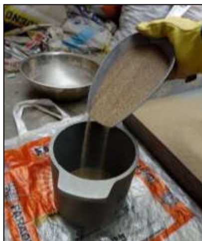
Figura 4. Ensayo de Peso unitario suelto de la arena fina
