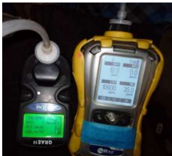
Figura 21. Medición de los gases contaminantes de la muestra M1
