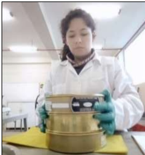
Figura 3. Ensayo de Análisis granulométrico
