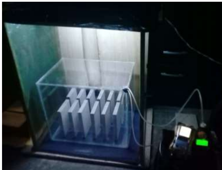
Figura 28. Especímenes de la muestra M2 dentro de la urna con los gases contaminantes
