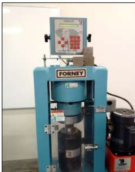
Figura 37. Ensayo de resistencia a la compresión de la muestra M6
