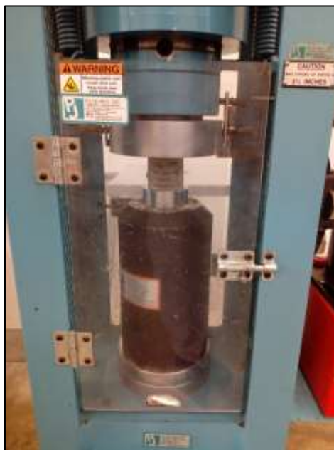
Figura 36. Ensayo de resistencia a la compresión de la muestra M5
