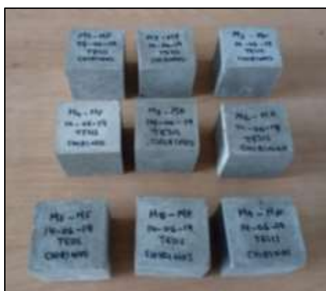
Figura 13. Cubos de mortero fotocatalítico (10%)
