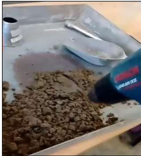
Figura 6. Ensayo de Peso específico y absorción de la arena fina
