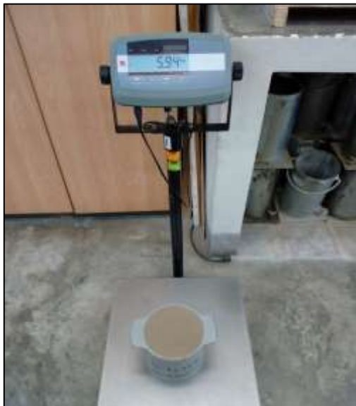
Figura 5. Ensayo peso unitario compactado
