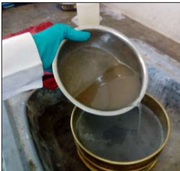
Figura 1. Ensayo de finos pasantes de la malla N°200
