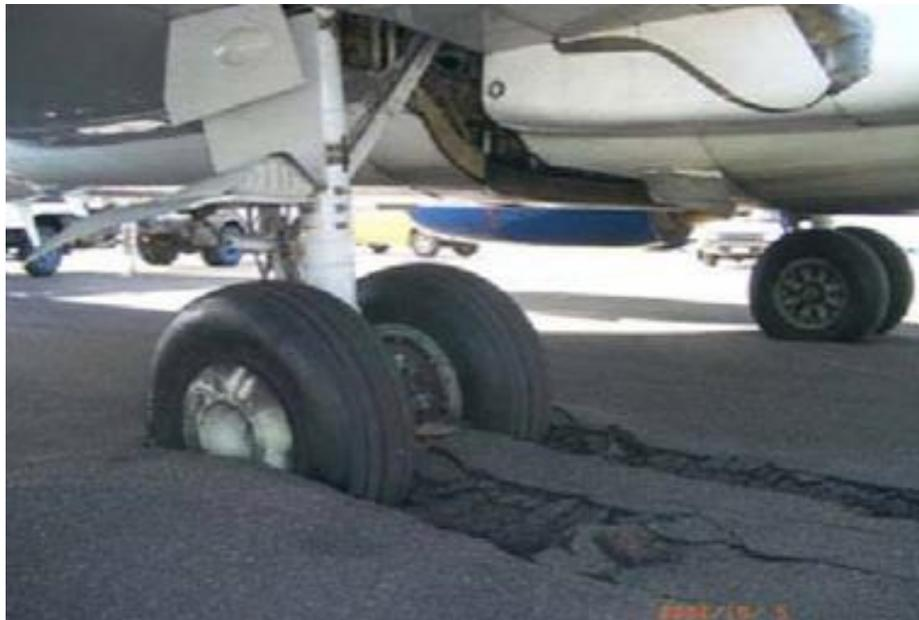
**Figura 14** Falla de un pavimento flexible causada por un mal diseño.
