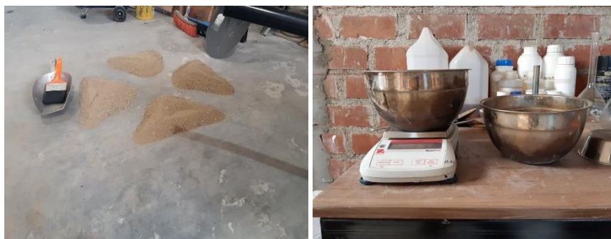
Figura 19. Muestra representativa y lectura de pesos para el contenido de humedad.
