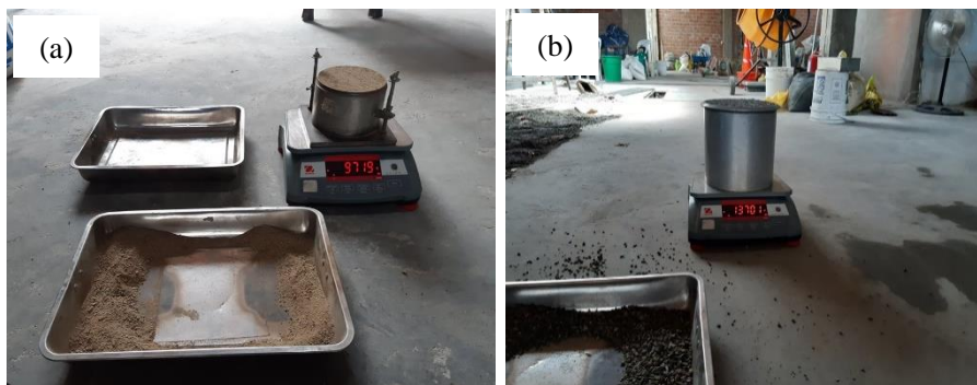
Figura 16. Ensayo de peso unitario, (a) para el agregado fino y, (b) agregado grueso.
