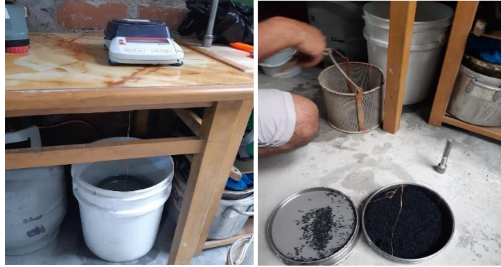
Figura 09. Peso específico del caucho mediante el principio de Arquímedes.
