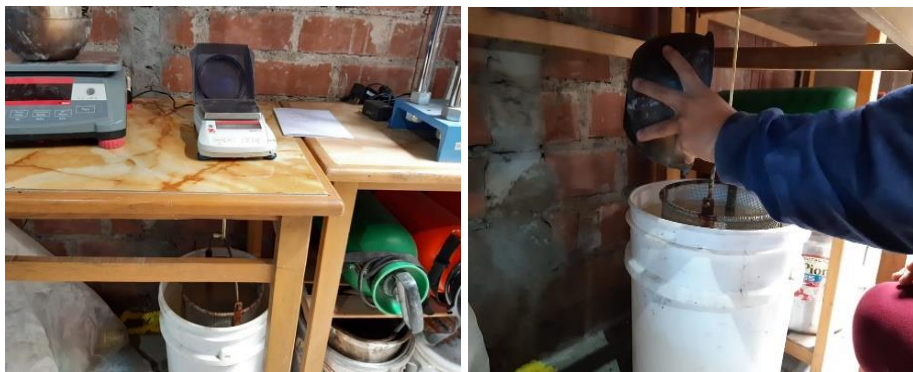
Figura 23. Procedimiento de ensayo de peso específico para el agregado grueso.
