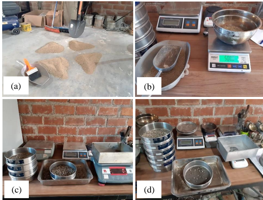
Figura 13. Ensayo de granulometría, (a) cuarteo, (b) muestra representativa y, (c-d) tamizado de los agregados gruesos y finos.
