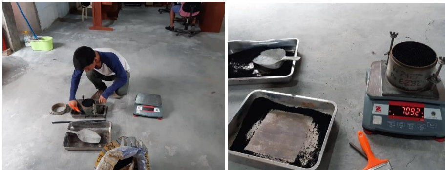
Figura 10. Peso unitario suelto y compactado del caucho mediante el estándar ASTM.
