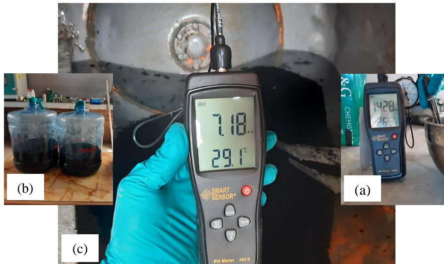
Figura 11. Pretratamiento del caucho, (a) visualización de pH inicial (pH=14), (b) agitación de las partículas en solución 1N NaOH y, (c) reducción del pH (pH=7) mediante lavado con agua.
