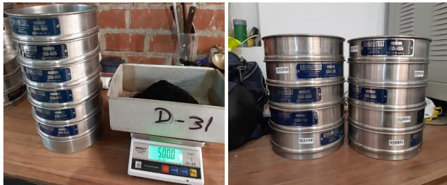
Figura 08. Ensayo granulométrico, se procedió a pesar la muestra representativa para posteriormente ser tamizado por las mallas correspondientes para un agregado fino
