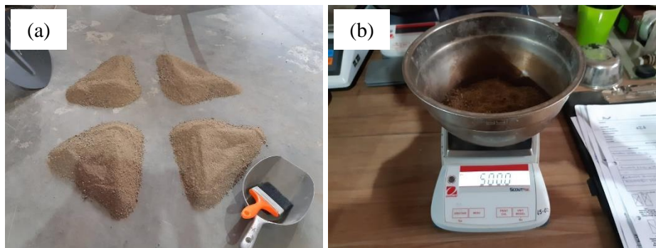
Figura 15. Material fino pasante la malla N° 200, (a) cuarteo y, (b) muestra representativa para el procedimiento correspondiente.
