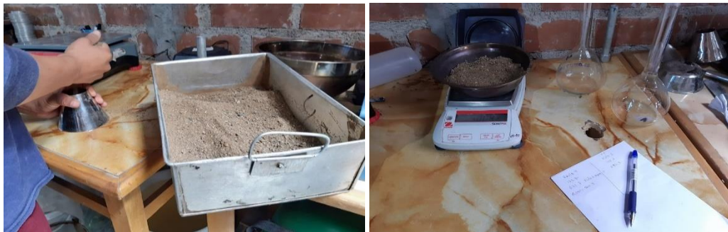
Figura 21. Procedimiento de ensayo de peso unitario del agregado fino.
