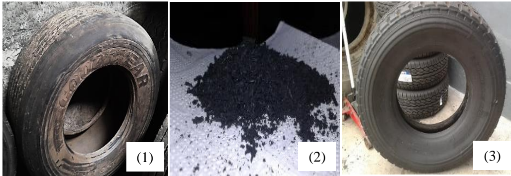
Figura 07. Adquisición del caucho, (1) neumático en desuso, (2) reencauche y adquisición del caucho durante el proceso de raspado y, (3) segunda vida del neumático.
