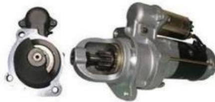
*Figura 4. Motor de arranque*
