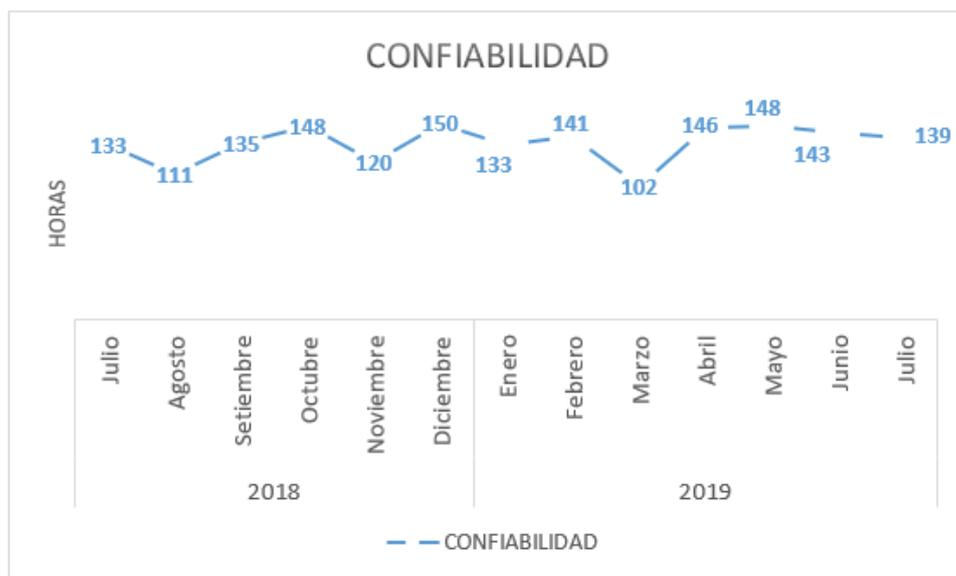
Figura 39. Confiabilidad de los grupos electrógenos
