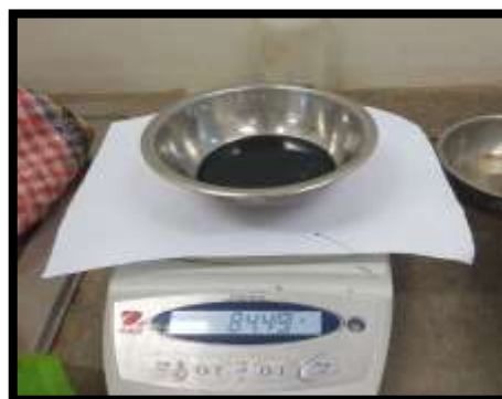
Figura 15. Asfalto para la elaboración de briquetas.
