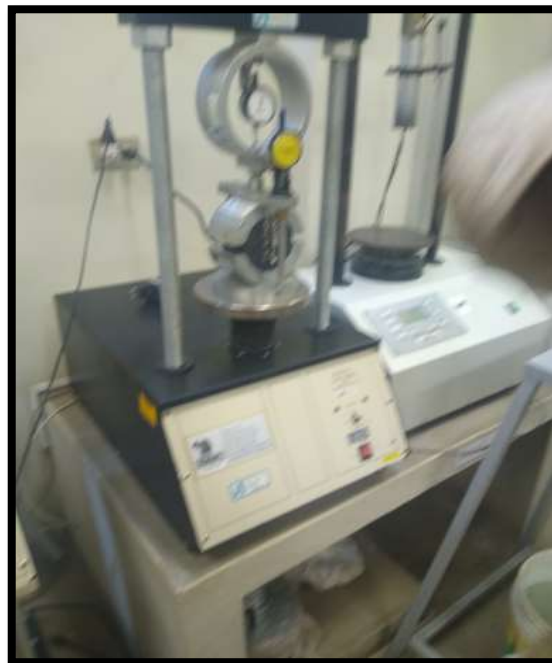
Figura 27. Briqueta en el aparato Marshall
