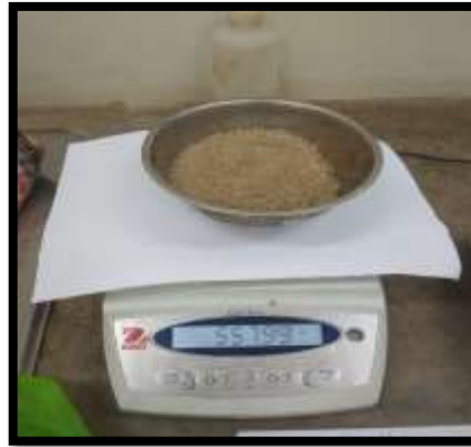
Figura 13. Agregado fino pesado para la elaboración de briquetas.
