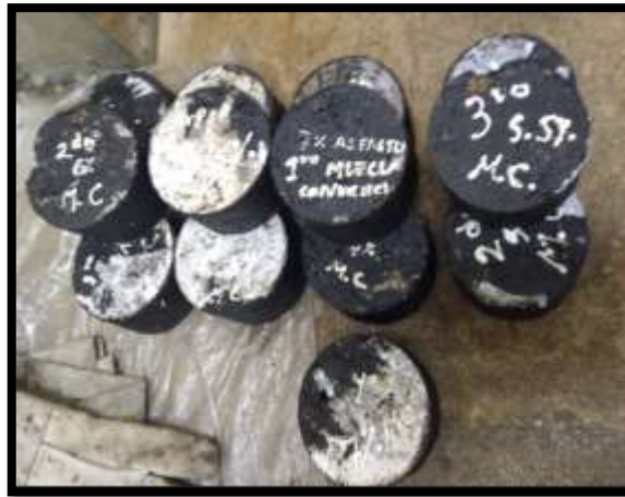
Figura 20. Briquetas listas para el ensayo Marshall.
