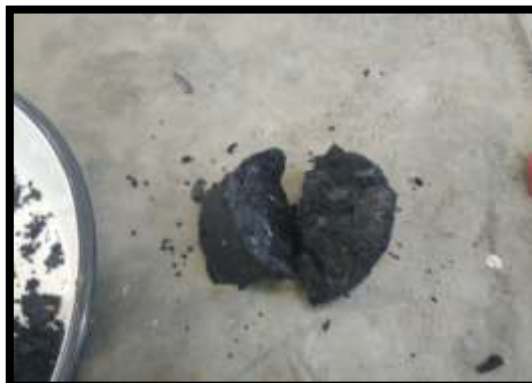
Figura 35. Estado final de las briquetas por ensayo a tracción.
