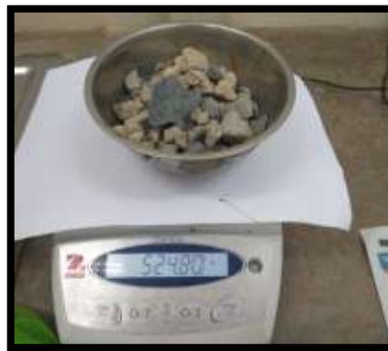
Figura 14. Agregado grueso para la elaboración de briquetas.
