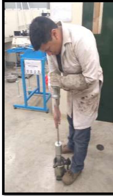
Figura 19. Compactación de la mezcla asfáltica para la briqueta.
