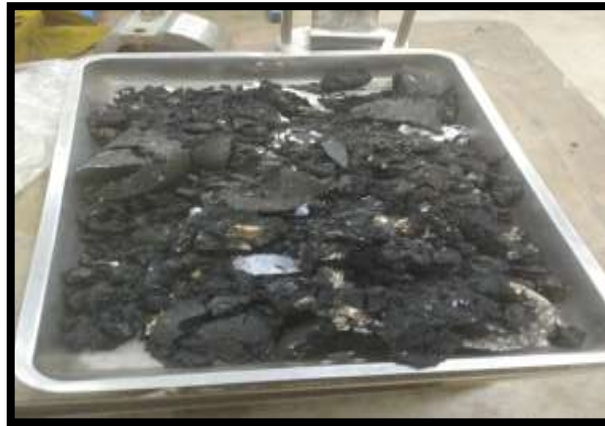
Figura 29. Briquetas rotas después del ensayo Marshall.
