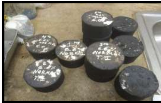
Figura 31. Briquetas para el ensayo de tracción indirecta
