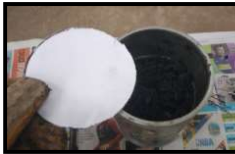
Figura 18. Colocación de papel filtro para el iniciado del compactado.
