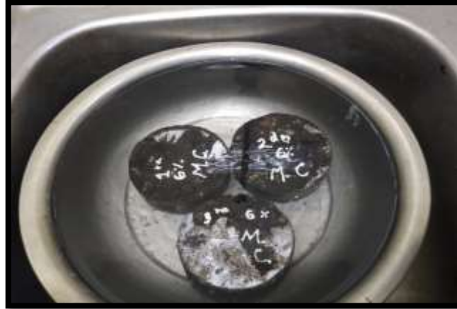
Figura 22. Briquetas sumergidas en agua a 25°C por 5 minutos.
