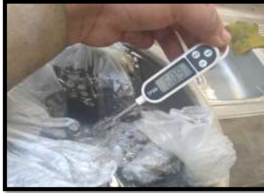
Figura 33. Colocación de las briquetas acondicionadas en baño maría a 60°C.
