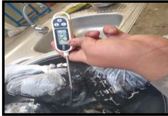
Figura 34. Colocación de las briquetas acondicionadas a baño maría a 25°C.
