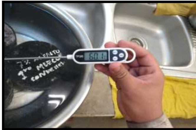
Figura 25. Temperatura a 60°C del Baño María hacia las briquetas.
