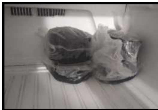
Figura 32. Briquetas acondicionadas a congelamiento.
