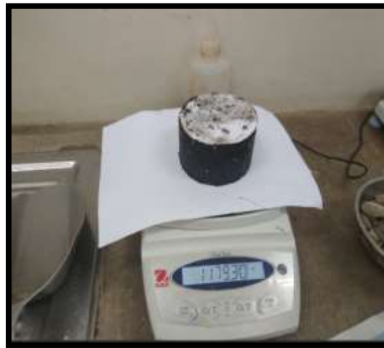
Figura 21. Peso seco de la briqueta.
