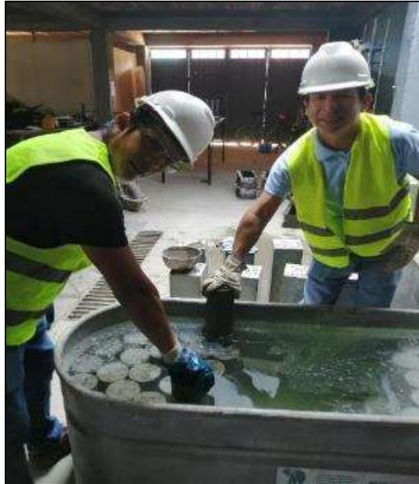
Figura 17. Curado del concreto.
