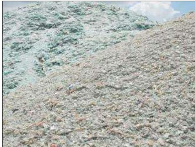
Figura 9. Foto Fibra de vidrio reciclado utilizado en las probetas
