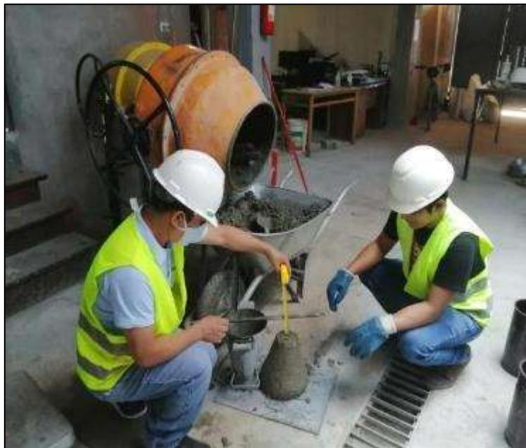
Figura 16. Medida del asentamiento del concreto.
