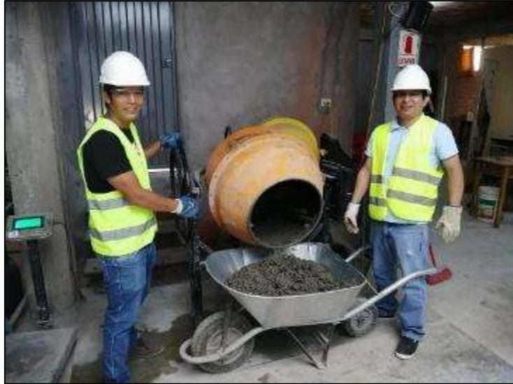
Figura 15. Concreto en estado fresco con añadido de fibra de vidrio
