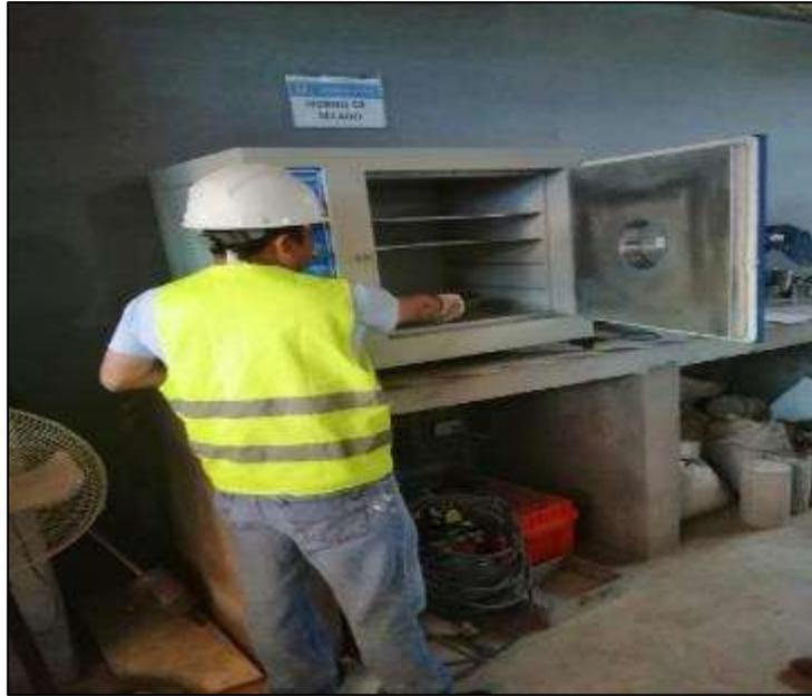
Figura 11. Foto horneando de agregados para la elaboración de las probetas de concreto.
