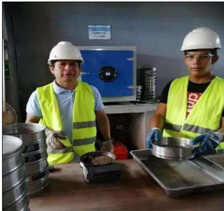
Figura 12. Foto tamizado de agregados para la elaboración de las probetas de concreto.
