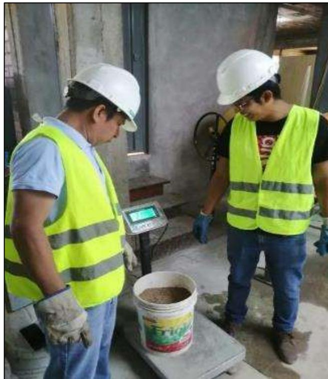
Figura 10. Foto Preparación pesado de materiales para elaboración de las probetas de concreto
