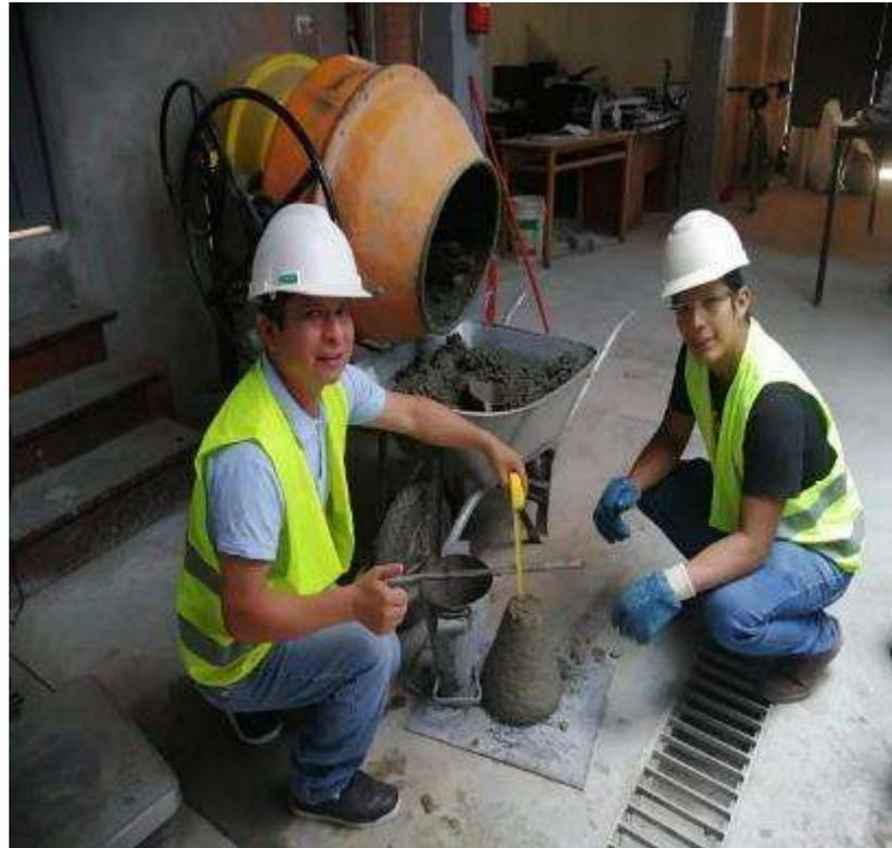
Figura 5. Foto de cono de Abrams para ensayo de revenimiento
