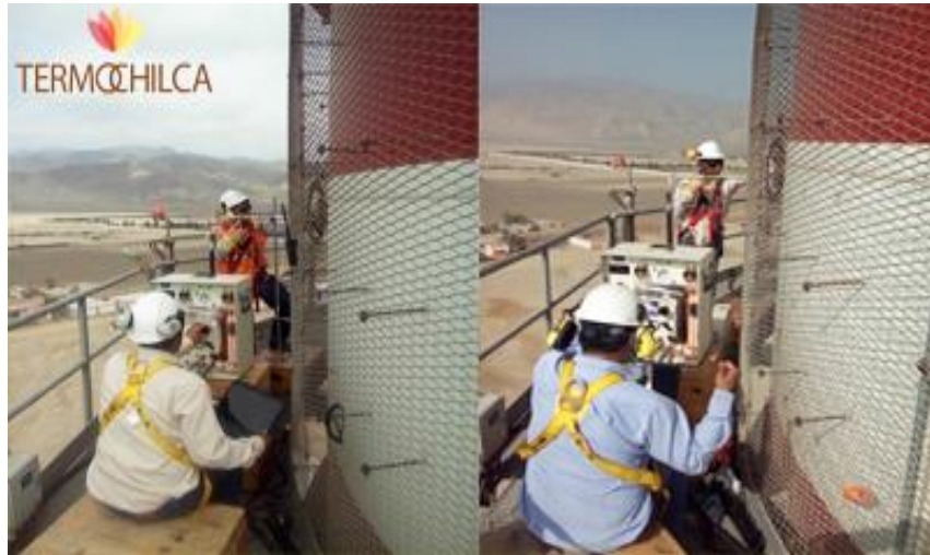
Figura N° 4. Monitoreo gases en la chimenea de salida de gases de la turbina. Fuente: Informe anual 2019 Termochilca S.A
