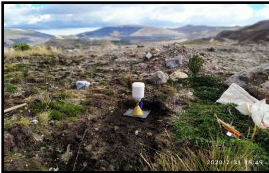
Figura 52. Ensayo de densidad Natural en stock 2 del material orgánico
