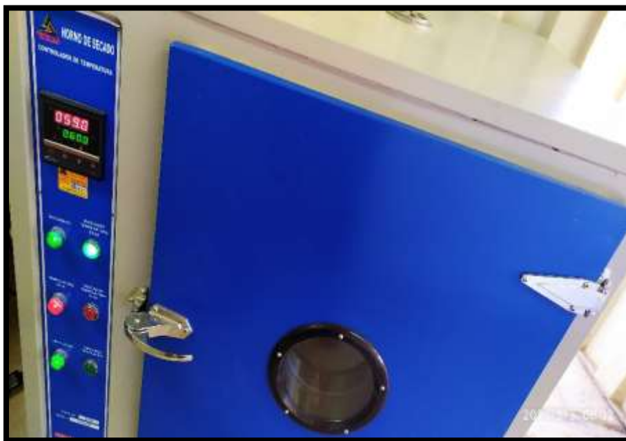
Figura 54. Temperatura controlada de secado de muestras de ensayos de material orgánico.
