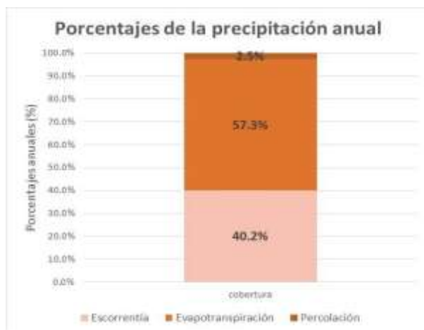
Figura 9. Porcentajes anuales medios de Escorrentía – Evapotranspiración – Percolación para la Cobertura tipo I
