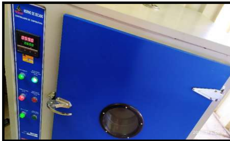
Figura 20. Temperatura controlada de secado de muestras de Ensayos de material orgánico.
