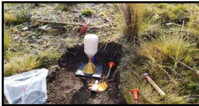
Figura 22. Ensayo de densidad Natural en stock 1 del material orgánico
