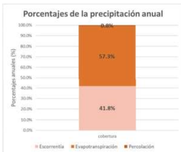
Figura 10. Porcentajes anuales medios de Escorrentía – Evapotranspiración – Percolación para la Cobertura tipo II.
