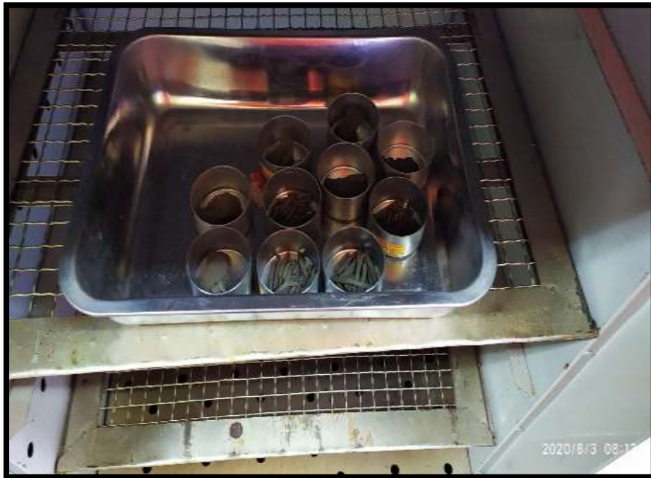
Figura 55. Secado de Limites de atterberg del material orgánico
