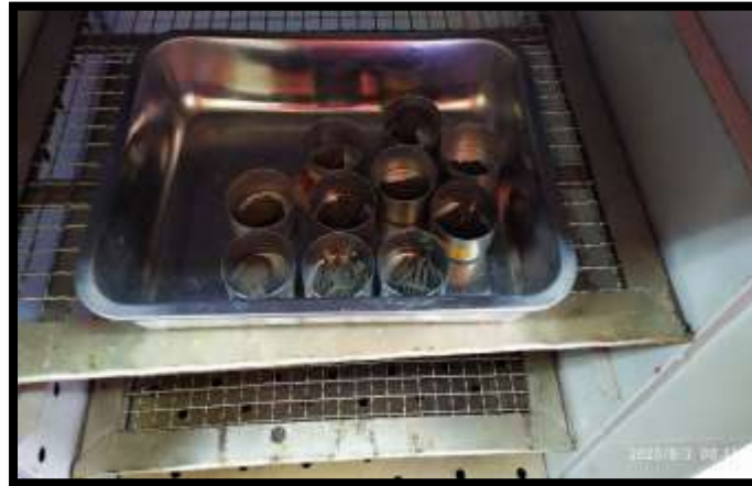
Figura 21. Secado de Limites de atterberg del material orgánico.
