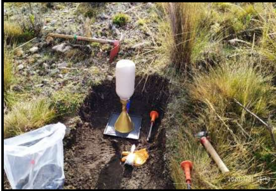
Figura 51. Ensayo de densidad Natural en stock 1 del material orgánico
