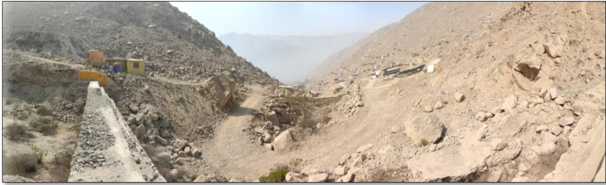
Foto 11 Vista panorámica de la quebrada Chacrasana Se observa material suelto residual coluvial, este material es susceptible de arrastre al reactivarse la geodinámica externa en épocas de precipitación pluvial.
