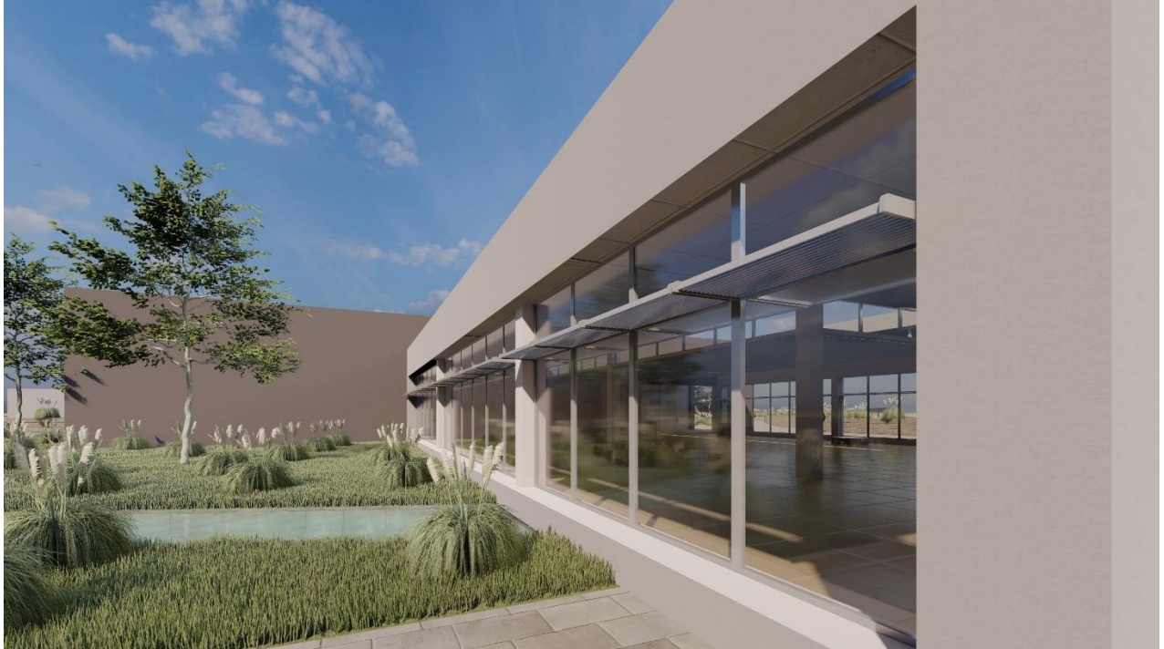
Render 5: Vista de fachada en zona administrativa, repisas solares.
