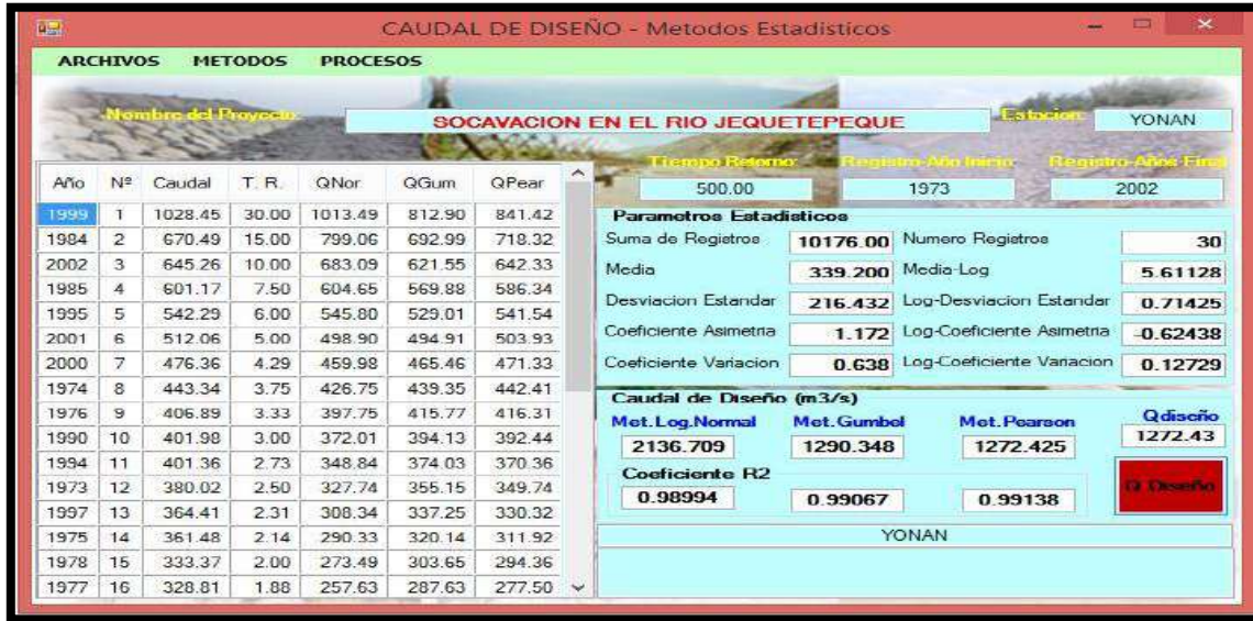
Figura II.12. Cálculo del Caudal de Diseño con el programa River (Fuente: Elaboración propia)
