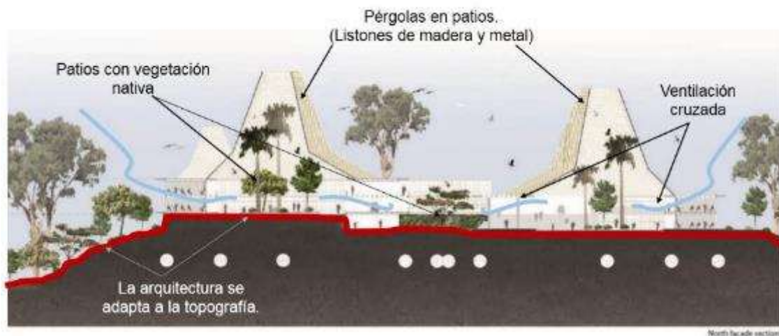
Figura 14: Análisis de la dimensión de estrategias de enfriamiento pasivo del Colegio Pies Descalzos, Colombia.
