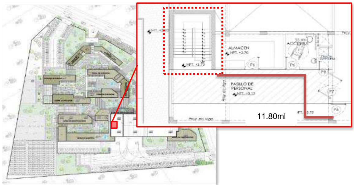
Figura n°91 Escaleras de evacuación de la zona de producción del CITE VID
