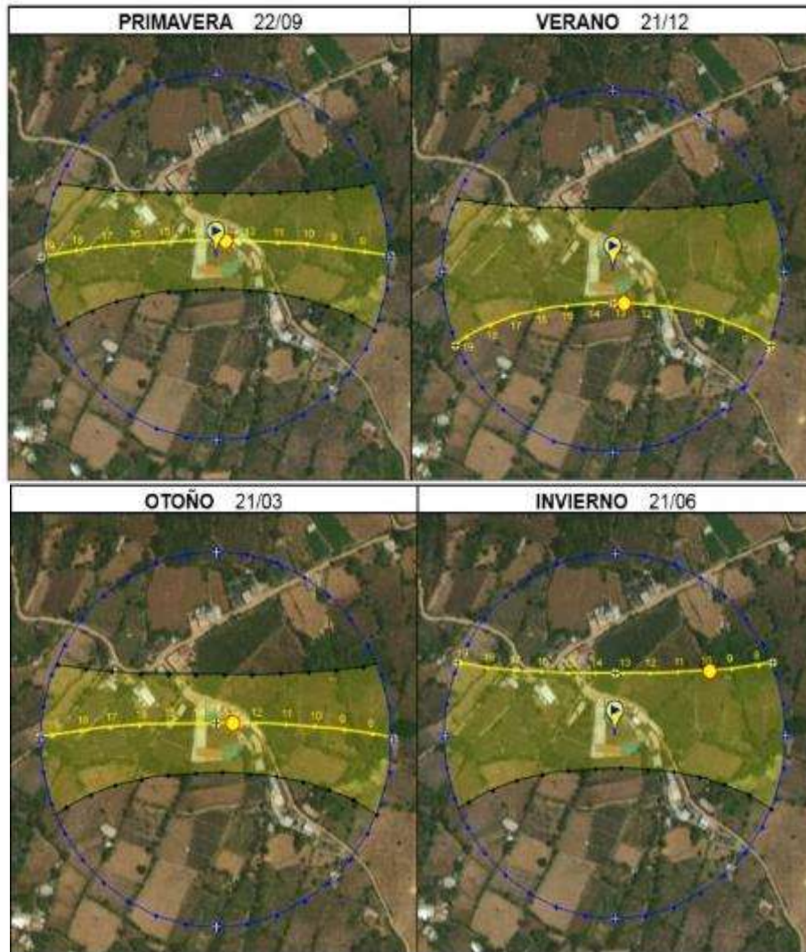
Figura 39: Asoleamiento del terreno según la estación del año
