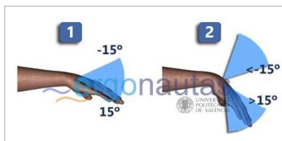
Figura 33. REBA, Medición de la puntuación de la muñeca.
