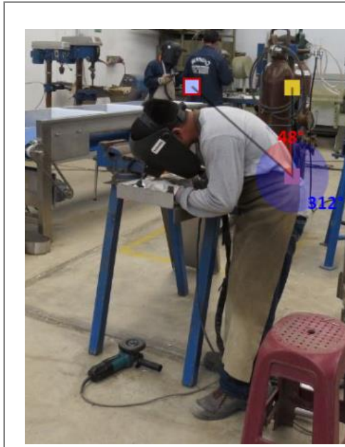
Figura 62. Medición de flexión del tronco.
