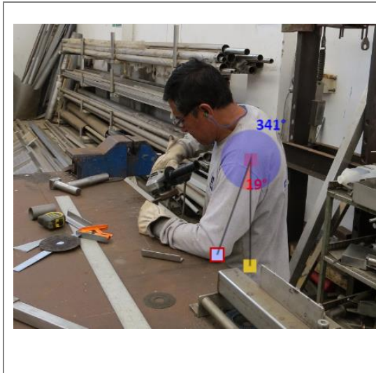
Figura 38. Medición de flexión del brazo izquierdo.
