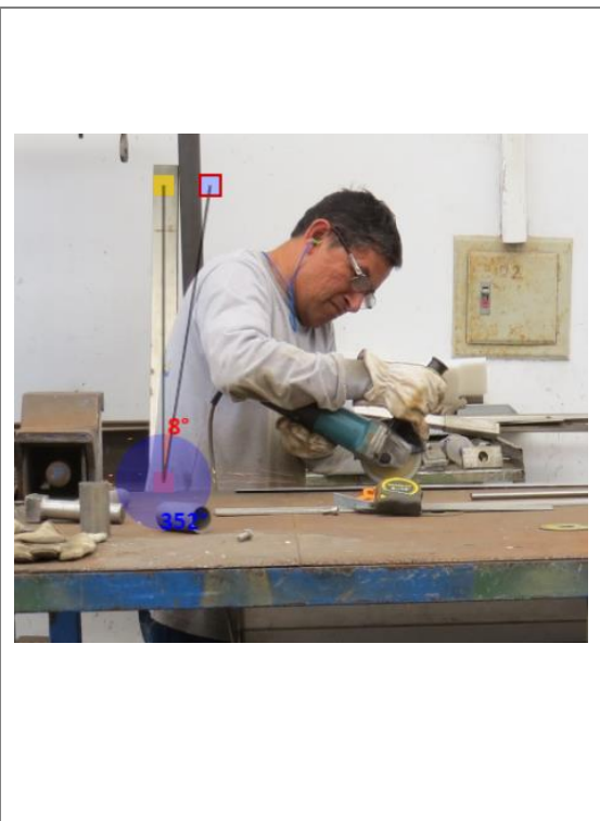
Figura 41. Medición de flexión del tronco.
