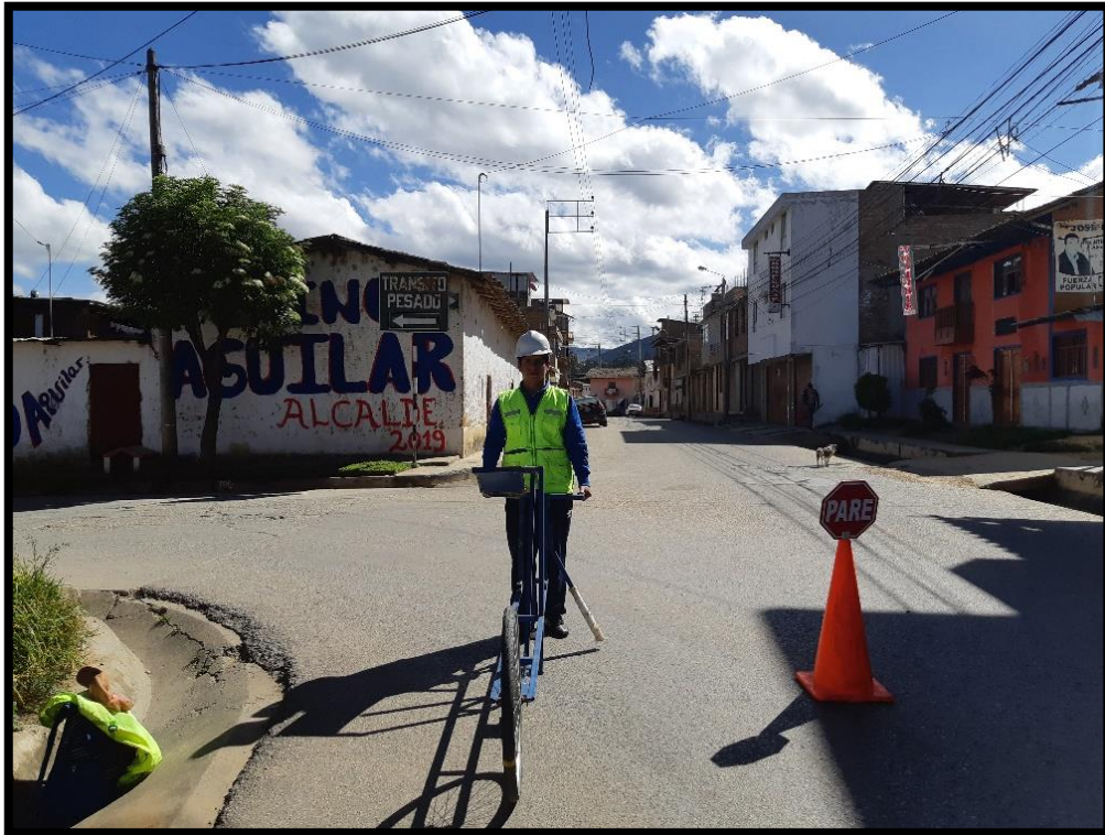
FOTOGRAFÍA 4: Inicio de toma de datos con el rugosímetro MERLIN, Carril Derecho.
