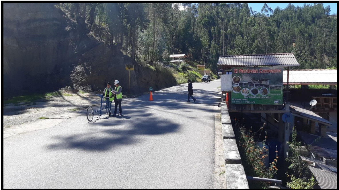
FOTOGRAFÍA 7: Toma de datos con el rugosímetro MERLIN, Carril Izquierdo. Zona del parqueo
