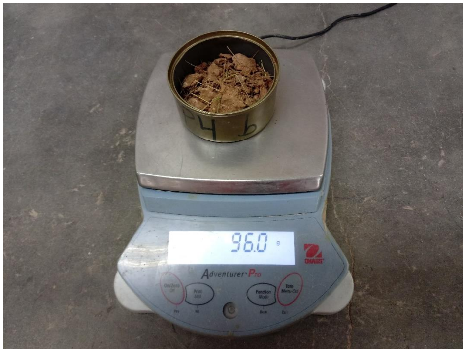
Figura 31. Pesando la tara para Proctor modificado.
