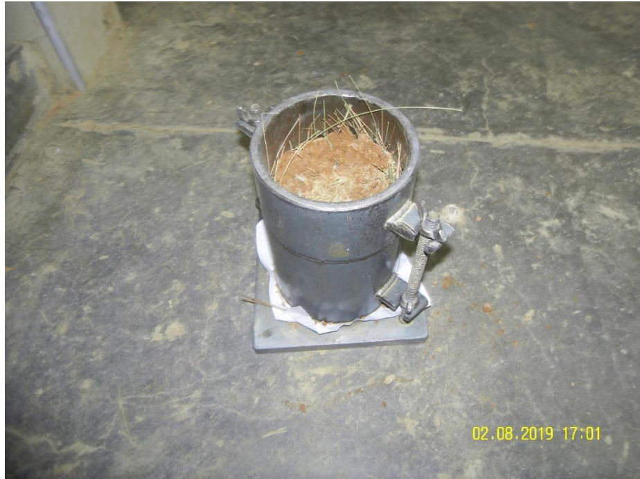
Figura 27. Ensayo de Proctor modificado con material con paja.
