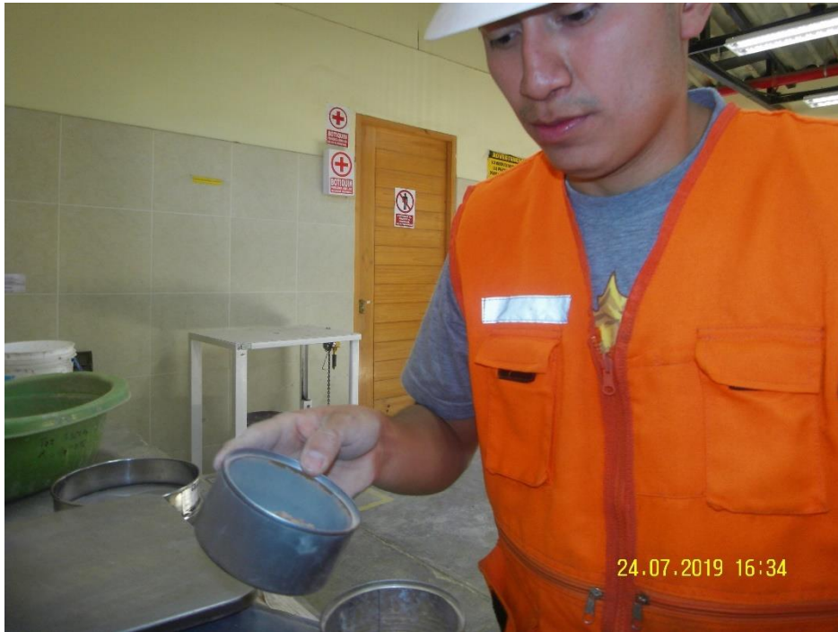
Figura 20. Pesando los materiales para el ensayo de Proctor modificado.
