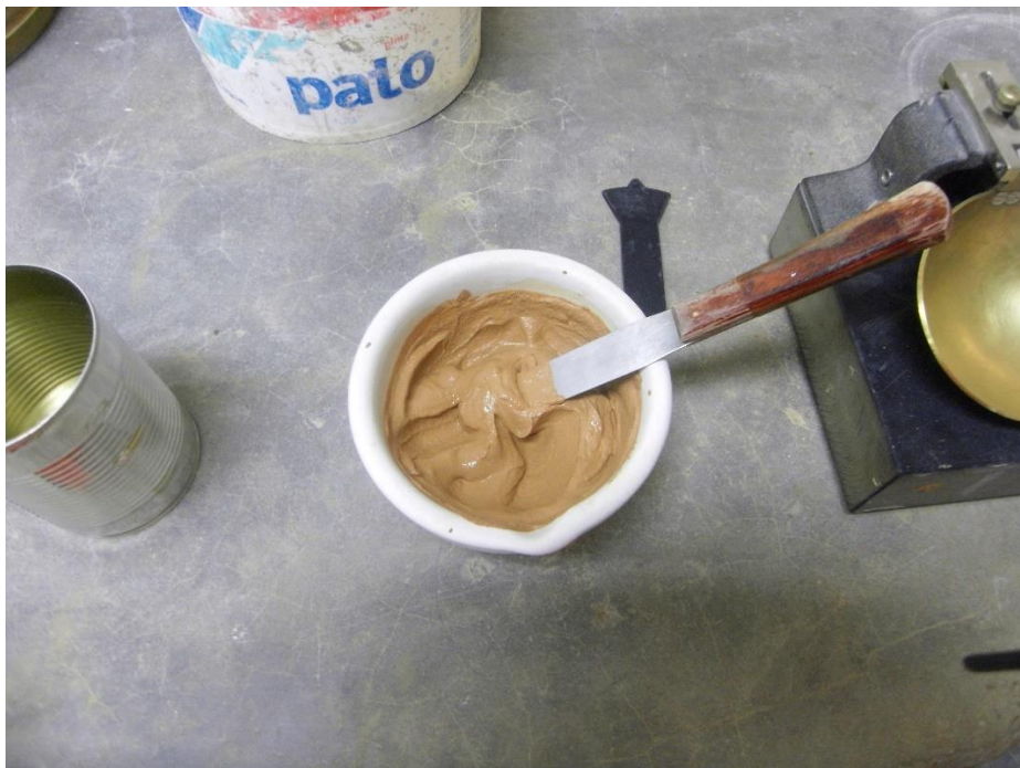
Figura 21. Mezcla para el ensayo de límite líquido.
