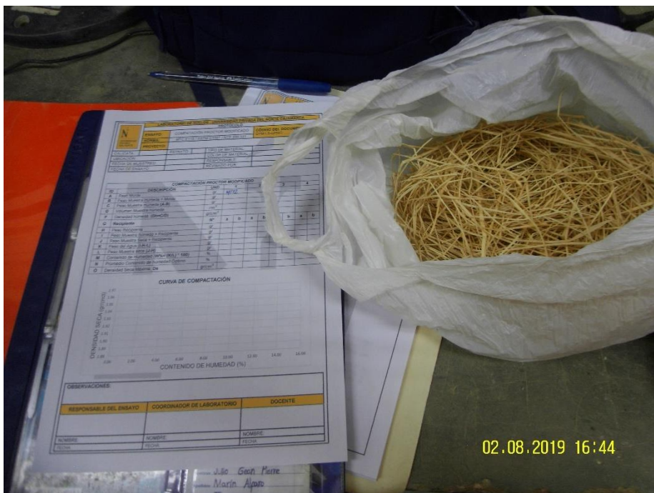
Figura 25. Seleccionando el material para el ensayo de Proctor modificado.
