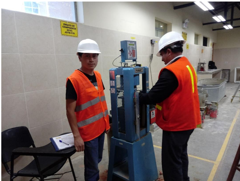
Figura 33. Ensayo de resistencia a compresión axial en Laboratorio UPN.
