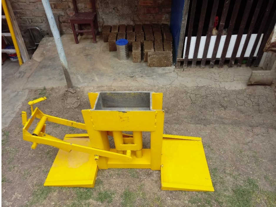
Figura 32. Máquina CINVA RAM para la elaboración de adobes.
