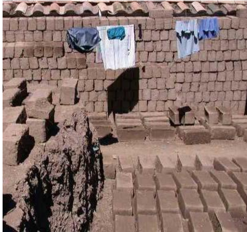
Figura 1. Adobes en proceso de secado. Fuente: Edificaciones antisísmicas de adobe, 2010.
