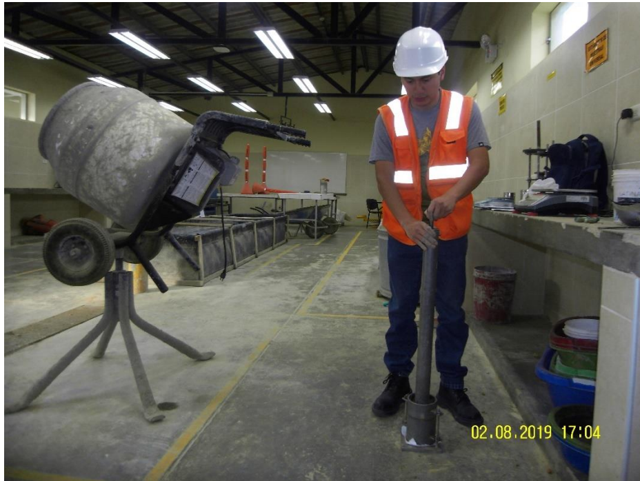
Figura 28. Compactando el material con el martillo en el proctor modificado.
