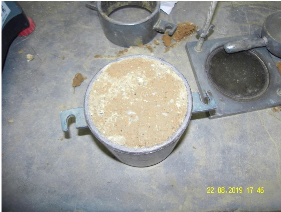
Figura 30. Muestra del peso y del volumen del ensayo.
