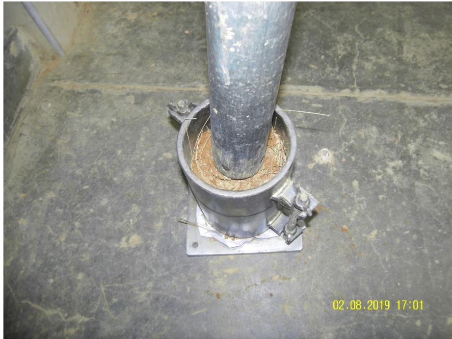
Figura 26. Usando el martillo para el compactado para el Proctor modificado.
