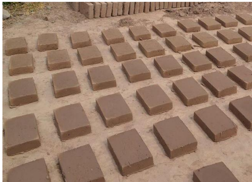
Figura 3. Adobes hechos de forma manual. Fuente: Edificaciones antisísmicas de adobe, 2010.
