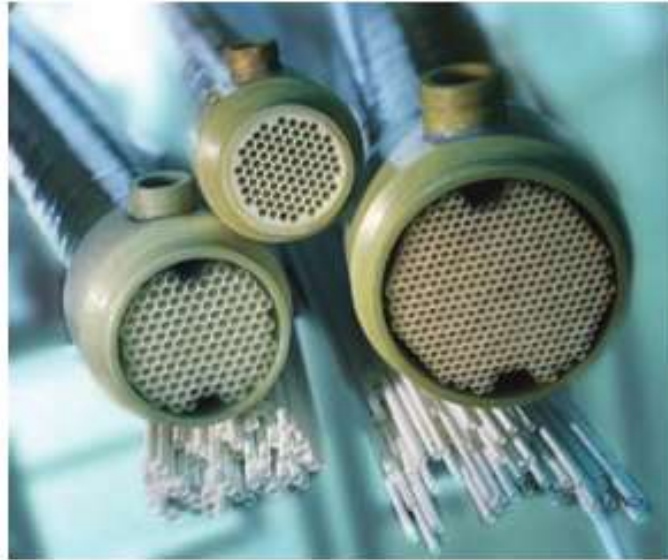
Figura 13. Cada tipo de configuración interna membrana tubular de ultrafiltración
