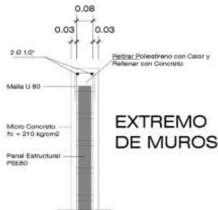
Figura 12 – Detalle Refuerzo en bordes
