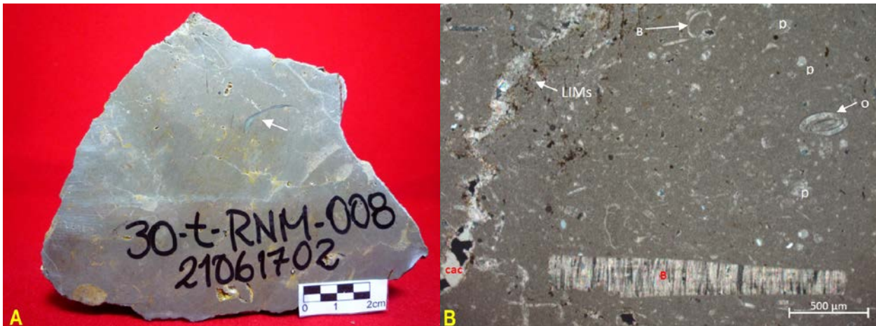
Fotografía 3.11 (A) Muestra de mano caliza Vaquería. (B) Fotomicrografía en luz transmitida y nicoles cruzados: se destaca bioclasto (B) de forma alargada (zona inferior) y otros más pequeños inmersos en micrita. También se observa peloides (p) y hacia la derecha oolito. Hacia la izquierda al parecer estilolito compuesto por granos de calcita (cac) de tamaño menor, pigmentado en sus bordes por limonitas (LIMs).
