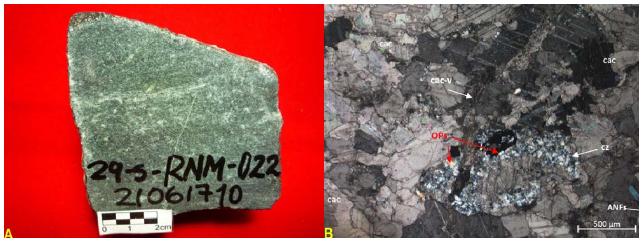
Fotografía 3.32 (A) Muestra de mano caliza de Livitaca. (B) Fotomicrografía en luz transmitida y nicoles cruzados: Se destaca fina venilla de calcita (cac-v), atravesando microagregado de cuarzo (cz). Obsérvese también minerales opacos (OPs)
