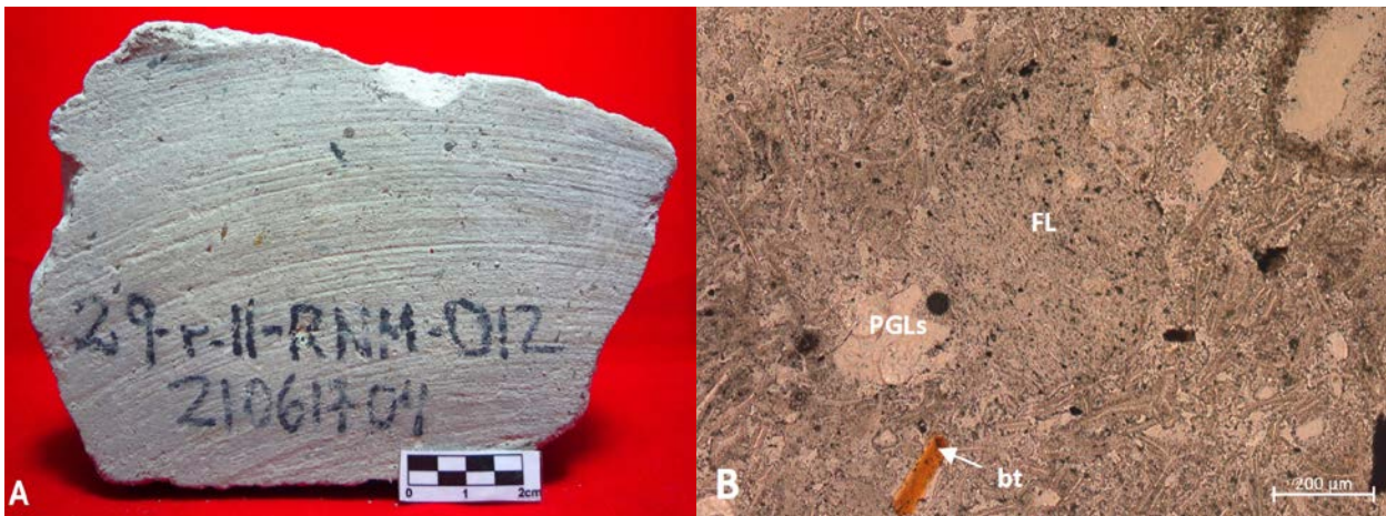
Fotografía 3.34 (A) Muestra de mano toba Llusco I. (B) Fotomicrografía en luz transmitida y nicoles paralelos: Se observa fragmentos líticos (FL), plagioclasas (PGLs) y biotita (bt) en matriz fina.
