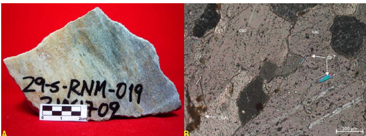
Fotografía 3.30 (A) Muestra de mano caliza de Cancahuaycco. (B) Fotomicrografía en luz transmitida y nicoles cruzados: se destaca cristales euhedrales de diópsido (dp) en agregado de calcita (cac). Obsérvese hacia el lado inferior derecho granoblasto de calcita con maclado polisintético.
