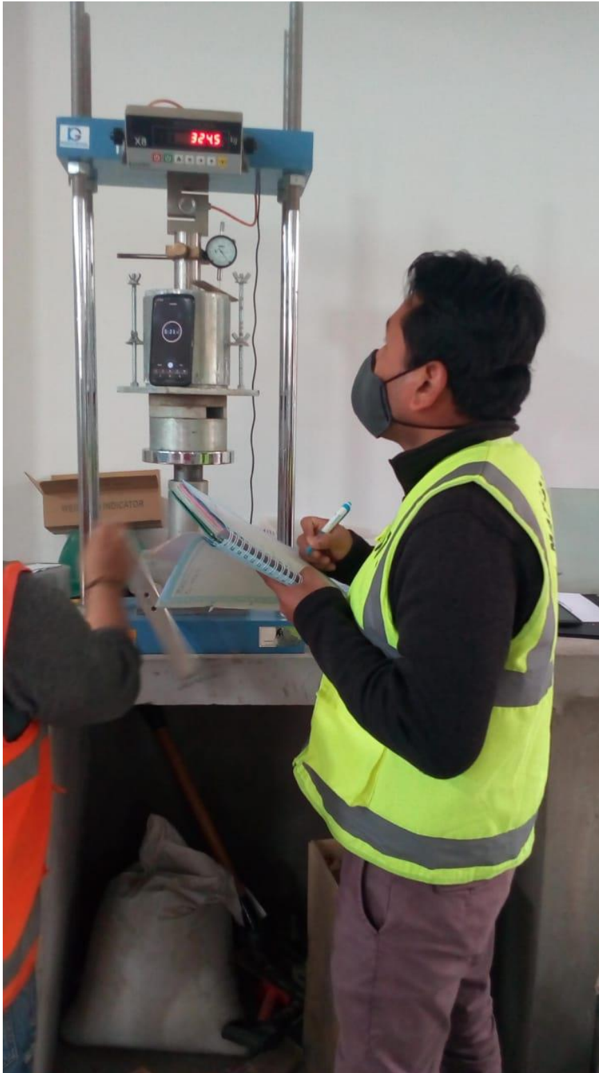
Figura 60. Registro de Penetración Fuente elaboración propia
