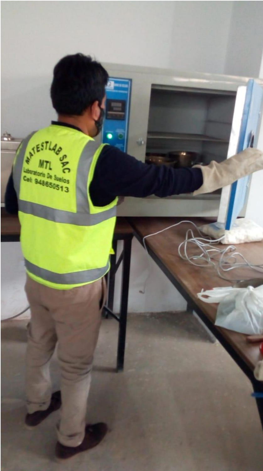
Figura 55. Colocación de Muestra en Horno Fuente elaboración propia
