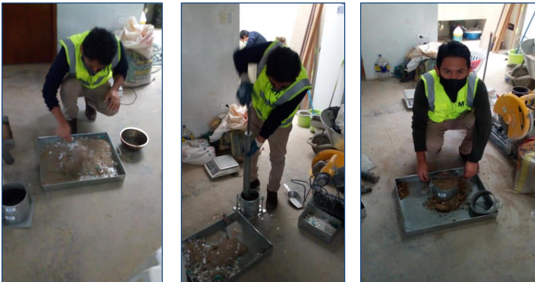
Figura 30. Ensayo de Proctor Elaboración Propia
