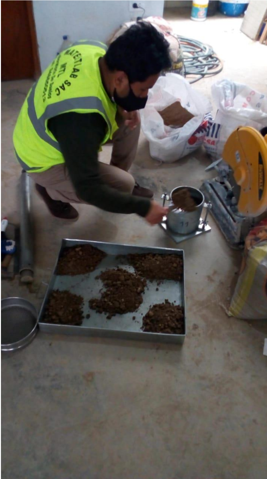
Figura 51. Colocación del Afirmado en el Molde
