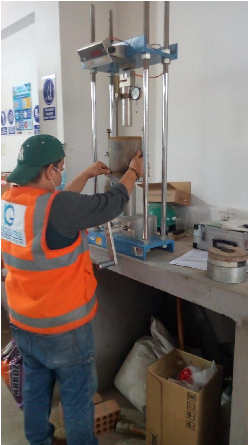
Figura 59. Colocación de Moldes en Equipo CBR
