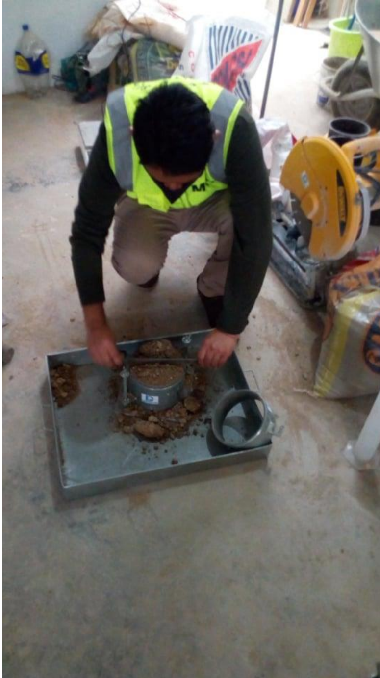
Figura 53. Nivelación del Molde Fuente elaboración propia
