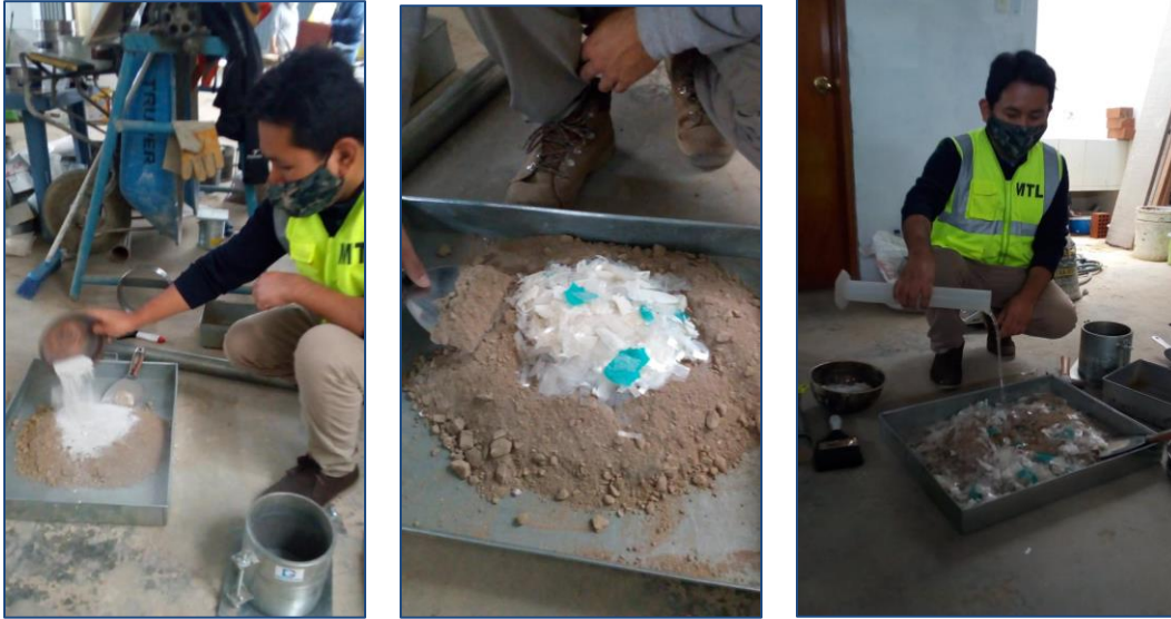
Figura 29. Colocación de Ceniza de Cascara de Arroz, Látex Reciclado Molido y agua Elaboración Propia
