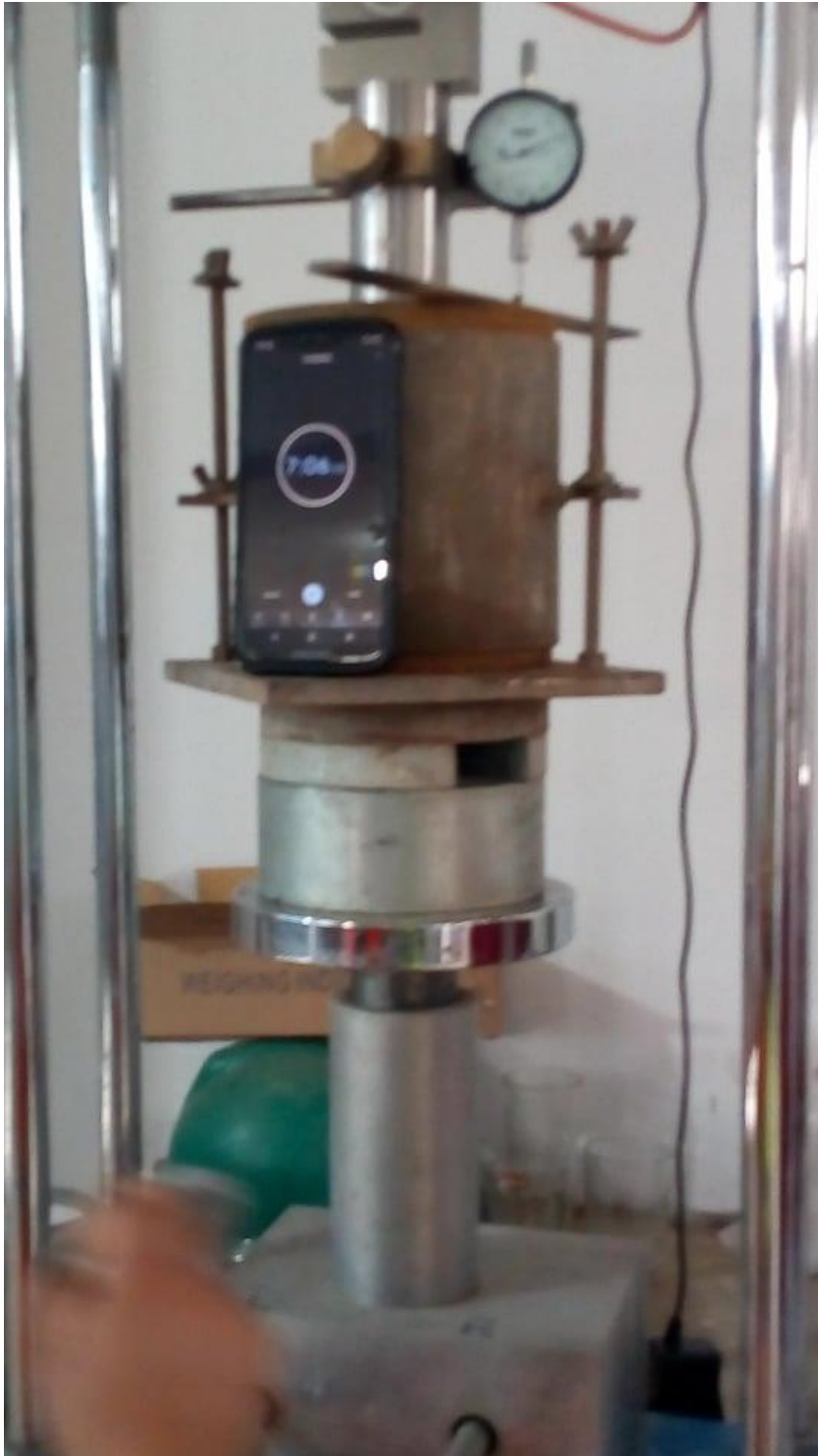
Figura 57. Registro de Deformación Ensayo CBR Fuente elaboración propia
