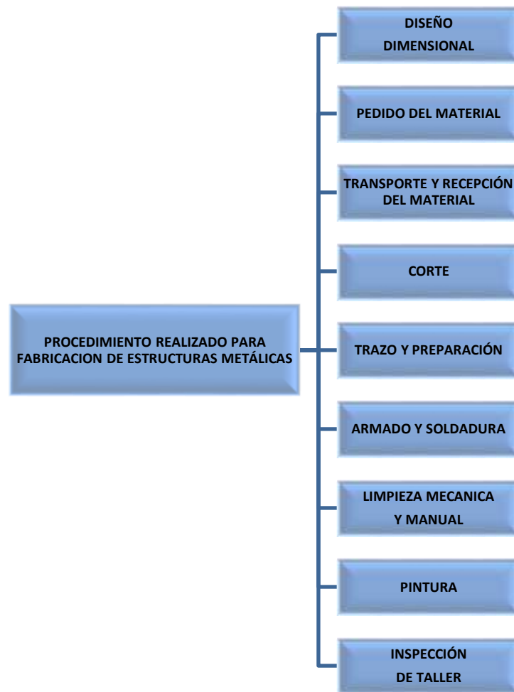
Figura 12. Procedimientos Ejecutados en la Fabricación de Estructuras Metálicas de la Obra
