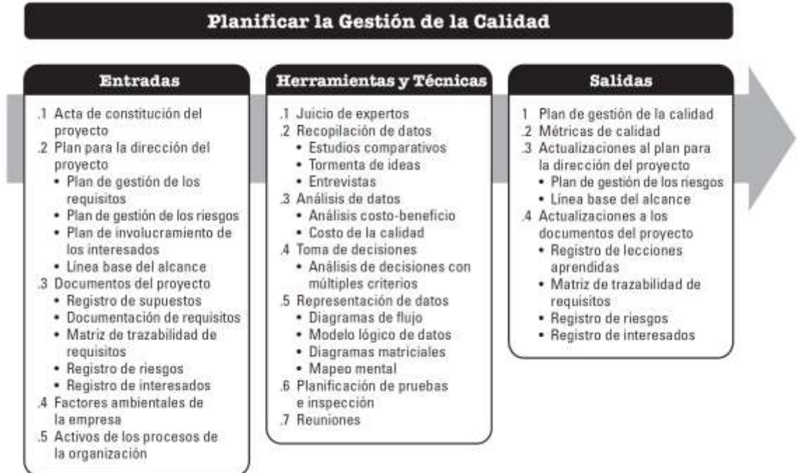
Figura 14. Planificar la Gestión de la Calidad: Entradas, Herramientas Técnicas y Salidas
