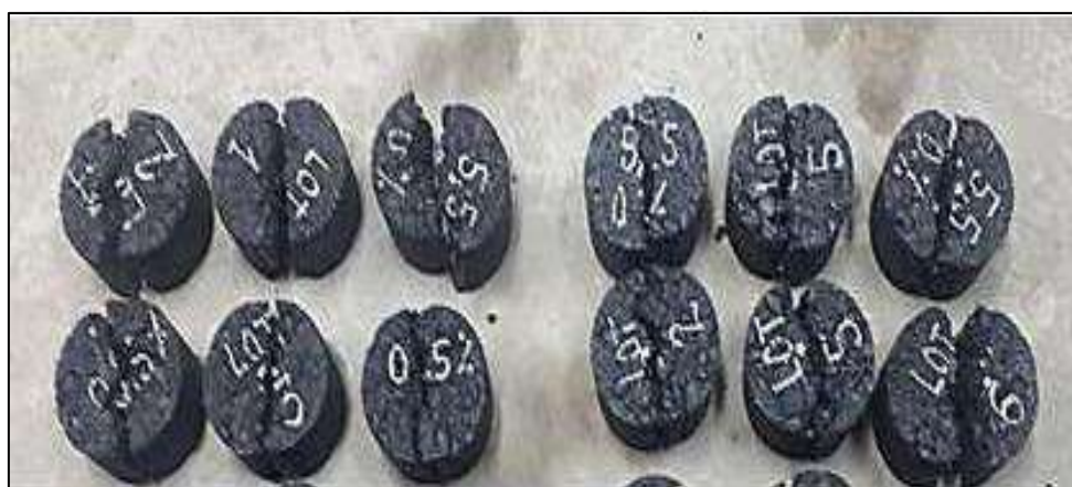
Figura 48 Probetas después de realizar el ensayo de compresión diametral al daño inducido por humedad.
