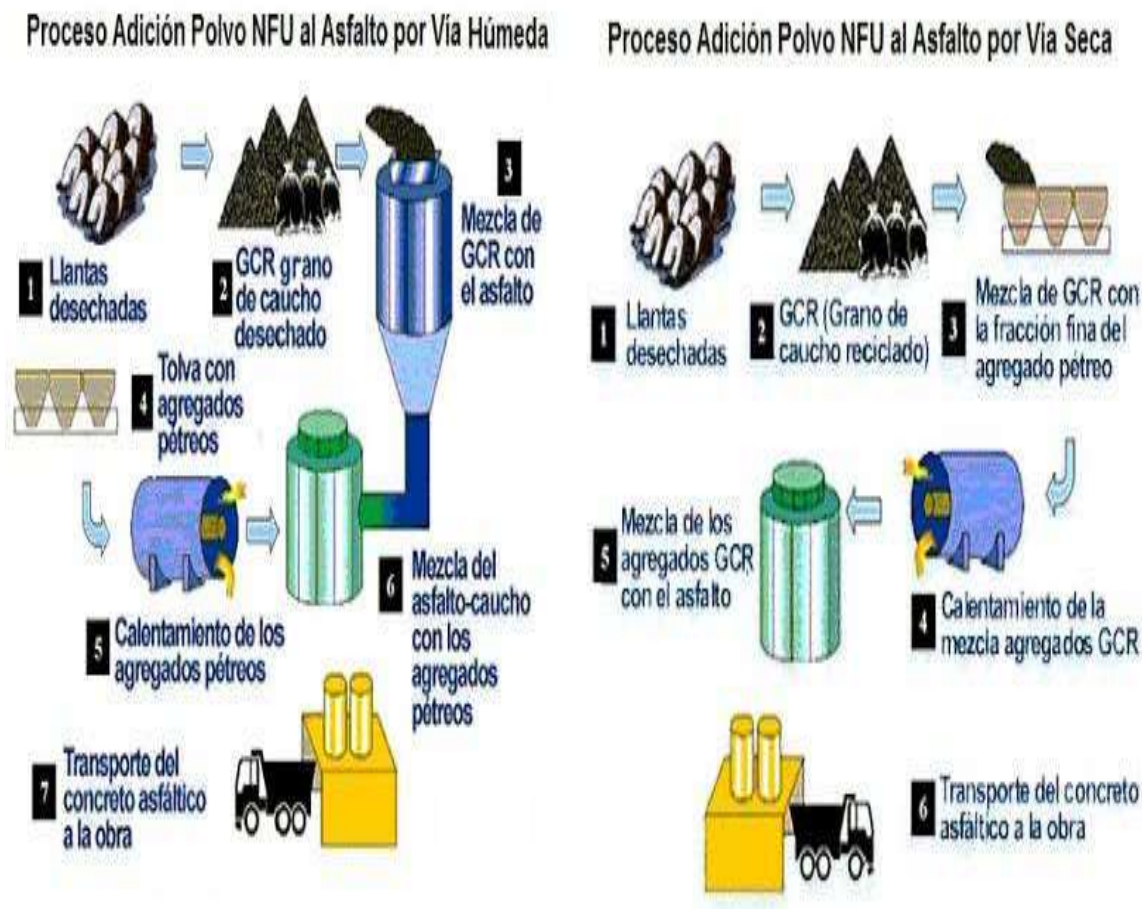
Figura 8 Proceso de preparación de una mezcla asfáltica
