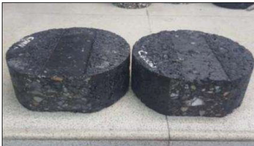
Figura 52 Probetas ensayadas en la Rueda de Hamburgo (con y sin caucho).
