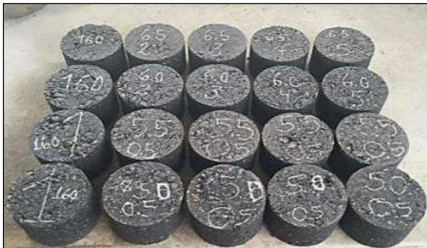
Figura 40 Probetas de mezcla asfáltica modificada a temperatura de 158°C.
