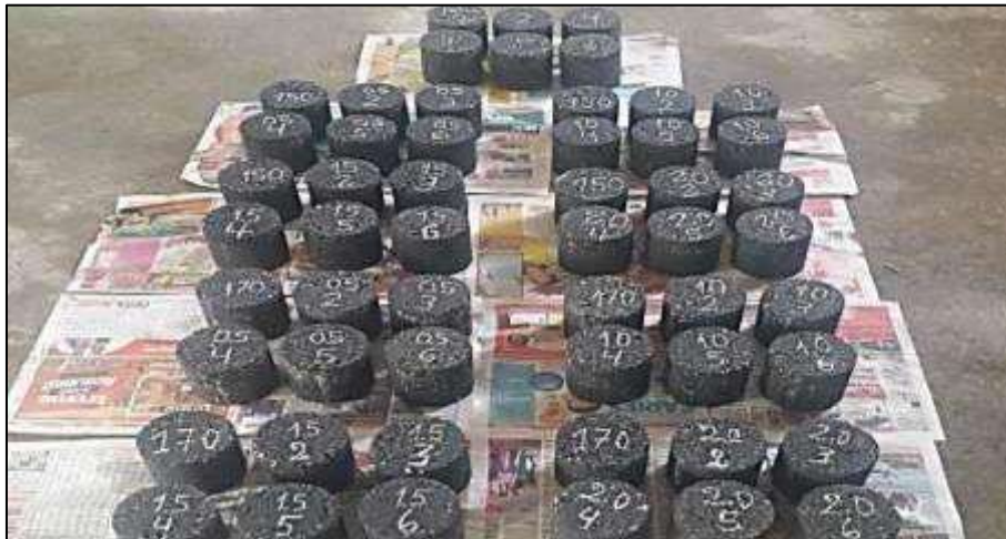
Figura 37 Probetas a temperaturas de 153°C, 158°C, 170°C y 180°C.
