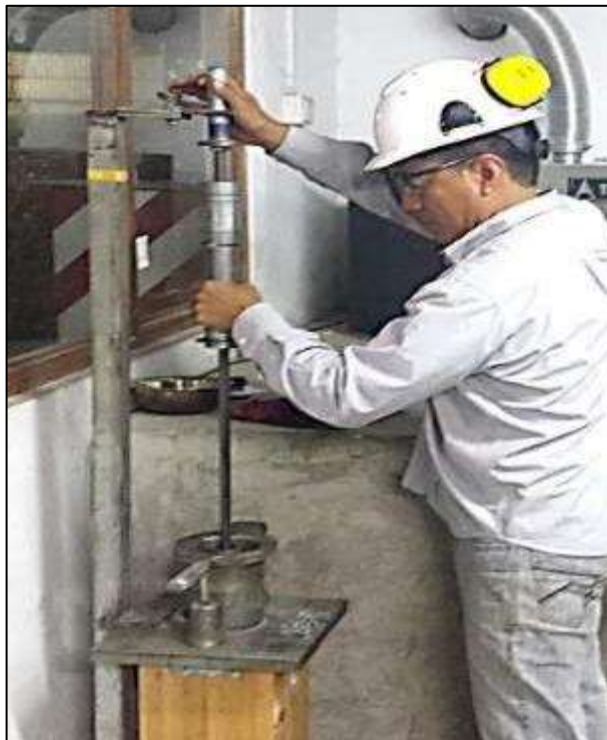
Figura 35. Compactación de la mezcla asfáltica modificada.
