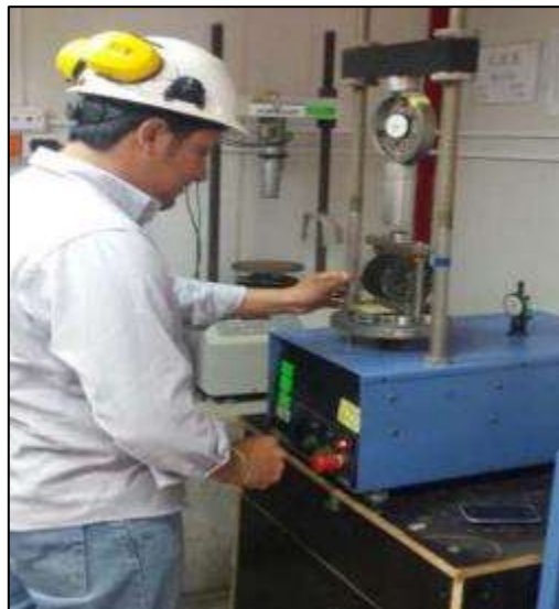
Figura 47 Ensayo de compresión diametral.
