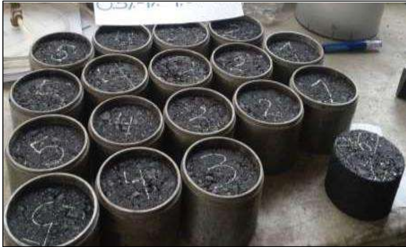
Figura 39 Probetas de mezcla asfáltica modificada a temperatura de 153°C.
