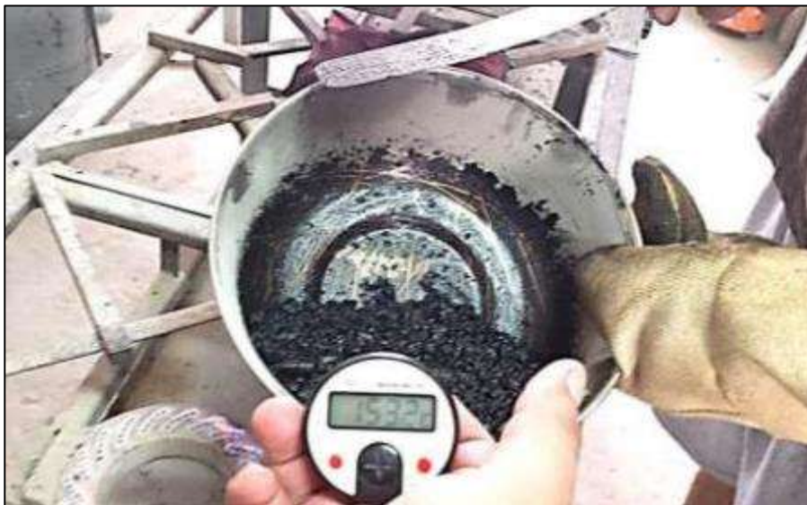
Figura 34 Mezcla de agregados, caucho y cemento asfáltico.
