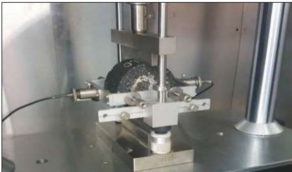
Figura 53 Probeta acondicionada en el equipo de ensayo de Módulo Resiliente.
