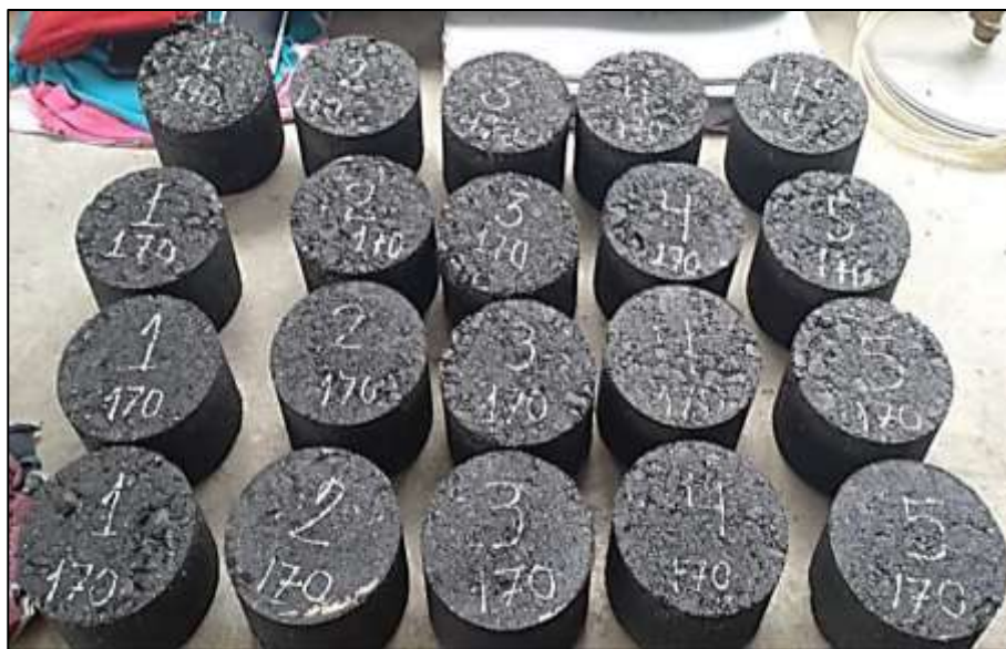
Figura 41 Probetas de mezcla asfáltica modificada a temperatura de 170°C.
