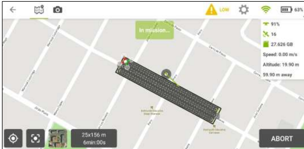
Figura 14. Toma fotografías programadas con el software PIX4D y posicionamiento del drone.
