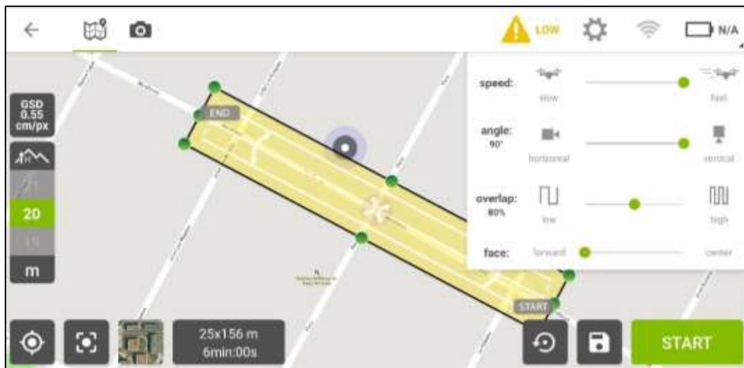
Figura 13. Programación de vuelo con el aplicativo PIX4D.
