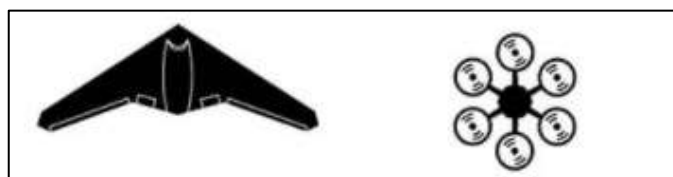
Figura 8.A la izquierda drone tipo ala Fija, al derecha drone tipo multirroto.
