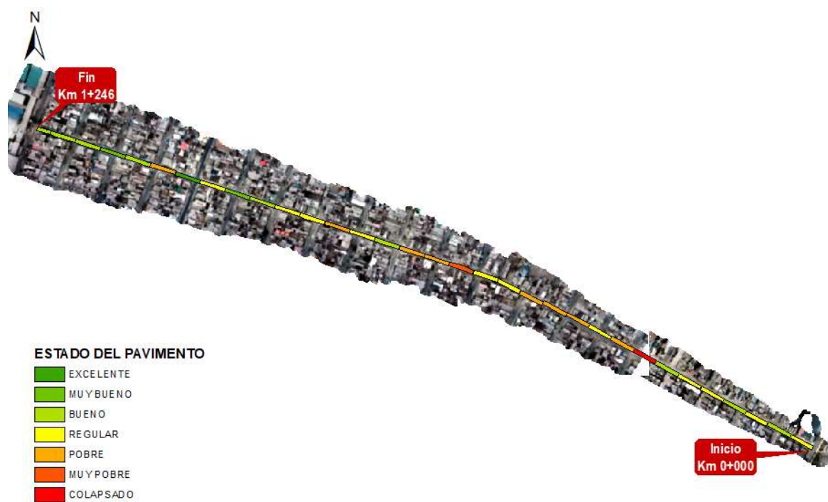
Figura 35. Ubicación de los estados de PCI en el tramo de estudio.
