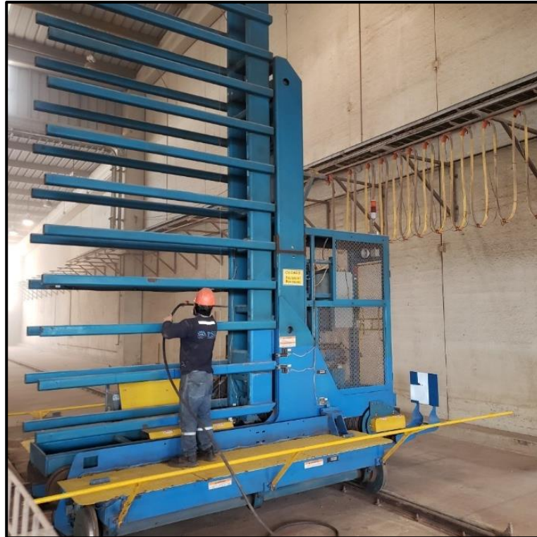
Figura 55. Limpieza e inspección del LOCAR/UPCAR.
