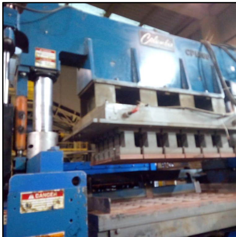
Figura 48. Limpieza de la viga de moldeo, CPM 60.
