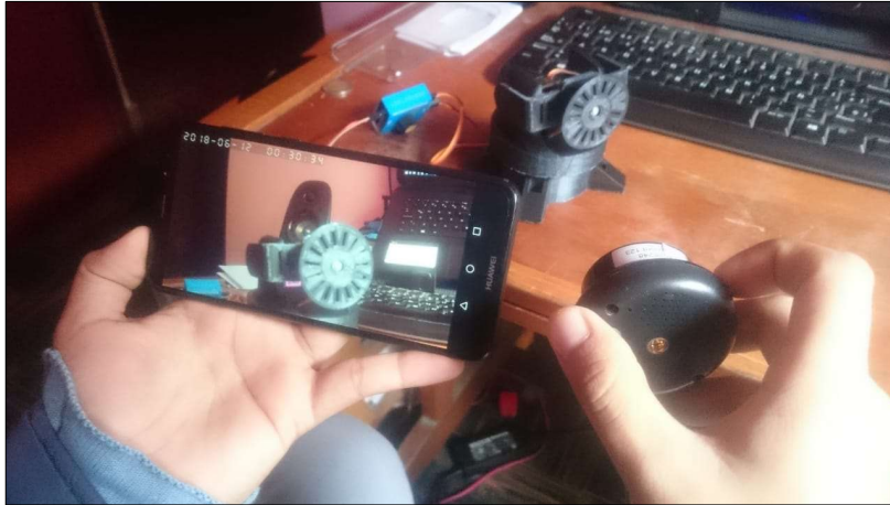
Figura 42. Prueba de conexión de Cámara IP con protocolo de transporte en tiempo real (RTP).
