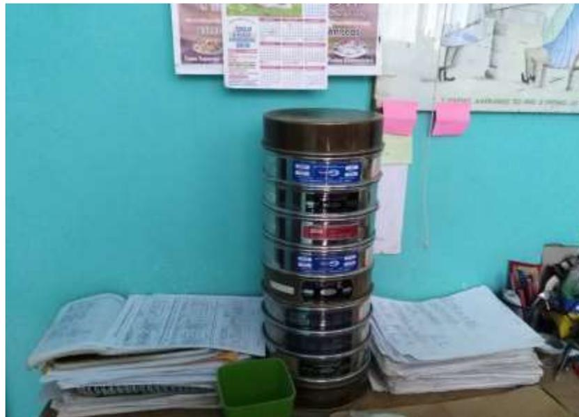
**Figura 14.** Instrumentos para realizar los diferentes tamizados N° 40, 60, 80.
