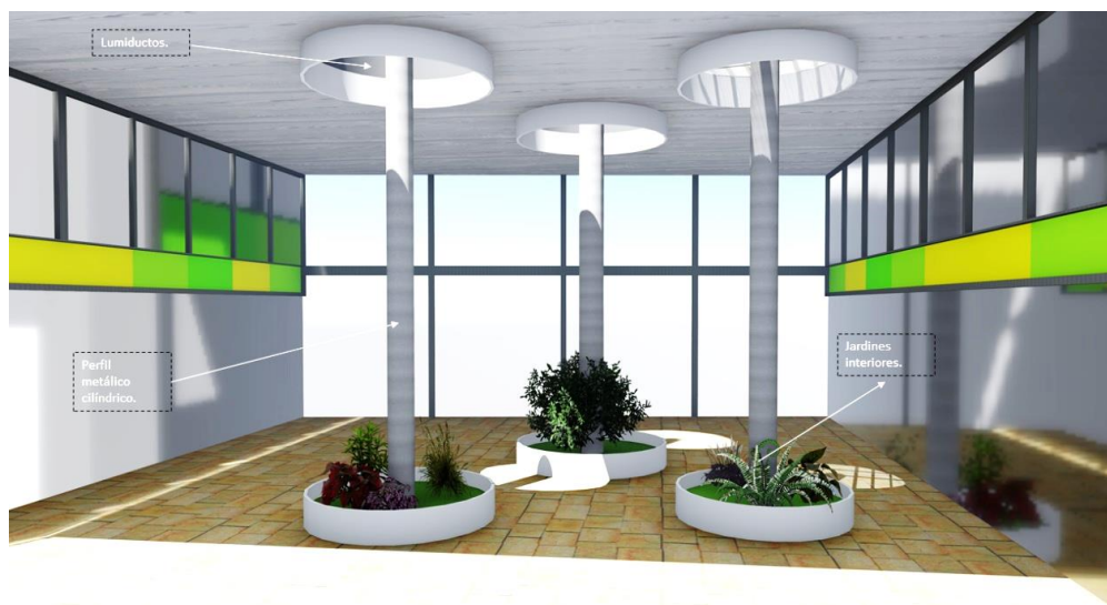
Figura 16. Imagen de lumiductos.
