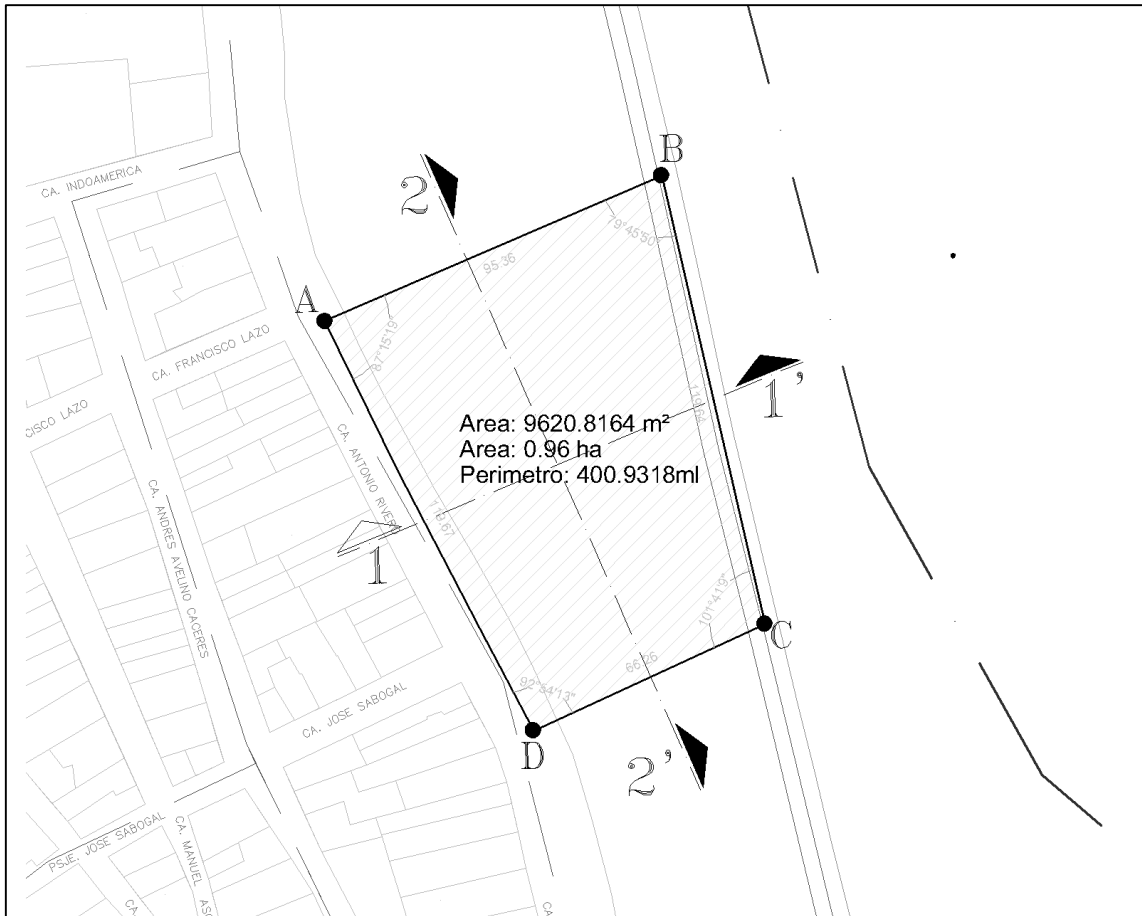
Figura 38. Area y medidas perimétricas del terreno No 01.
