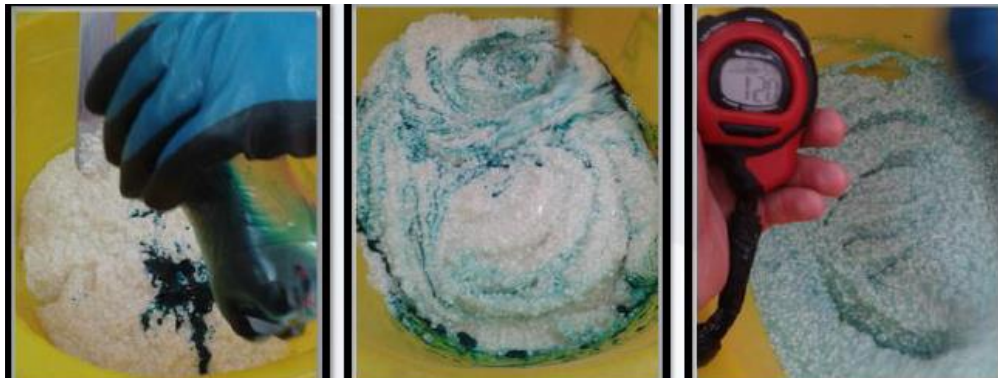
Ilustración 3: Reacción de gasificación (esponjamiento) de ME Quantex 73.
