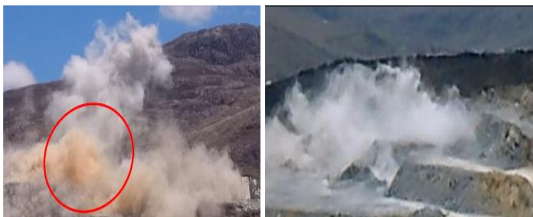
Ilustración 13. Generación de gases nitrosos con HA 46 y ME Quantex 73 a la izquierda y derecha respectivamente
