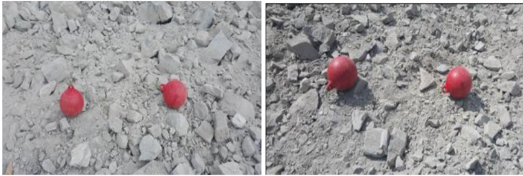
Ilustración 9. Fragmentación post voladura con HA 64 y ME Quantex a la izquierda y derecha respectivamente
