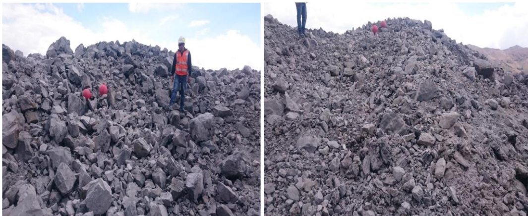
Ilustración 10. Fragmentación post voladura con HA 46 y ME Quantex 73 a la izquierda y derecha respectivamente
