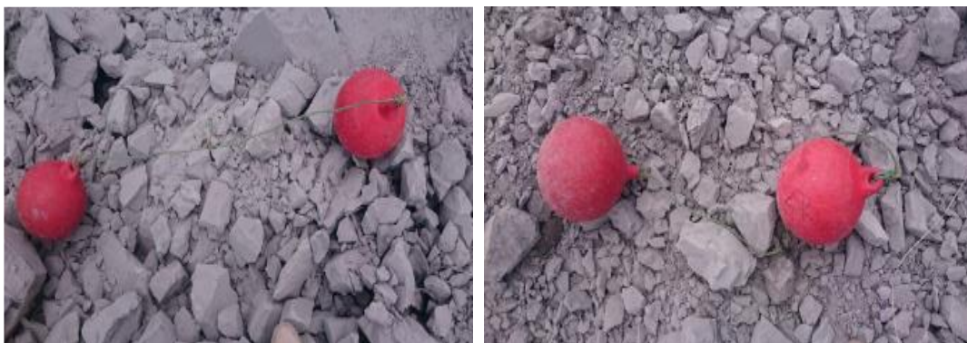
Ilustración 11. Fragmentación post voladura con HA 46 y ME Quantex 73 a la izquierda y derecha respectivamente
