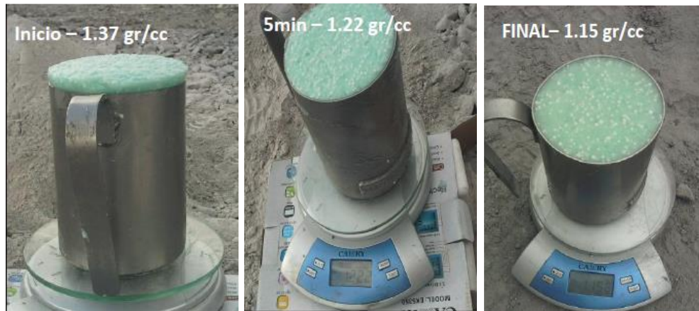
Ilustración 5: Control de esponjamiento y densidades de ME Quantex 73.
