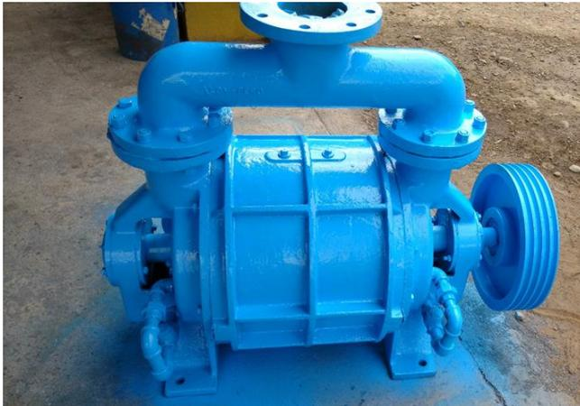
Figura 28. Bomba de vacío, Marca Ral-dy, luego del mantenimiento.
