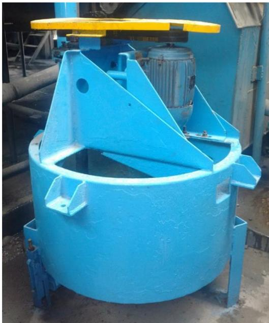
*Figura 22.* Celdas de Pb N° 01. Luego del mantenimiento.
