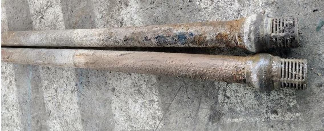
*Figura 29.* Tubería de succión de la bomba antes del mantenimiento.
