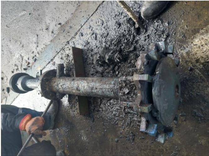
*Figura 23.* Mecanismo de agitación de la celda de Zn antes del mantenimiento.
