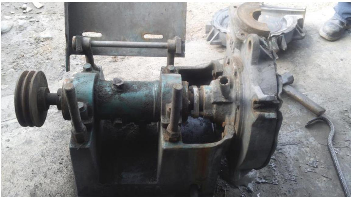
*Figura 19.* Bomba Espiasa antes del mantenimiento
