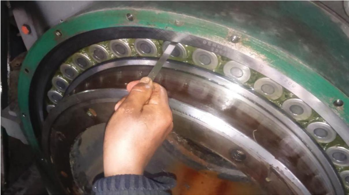
*Figura 17.* Medición de desgaste de rodamientos del molino de bolas.
