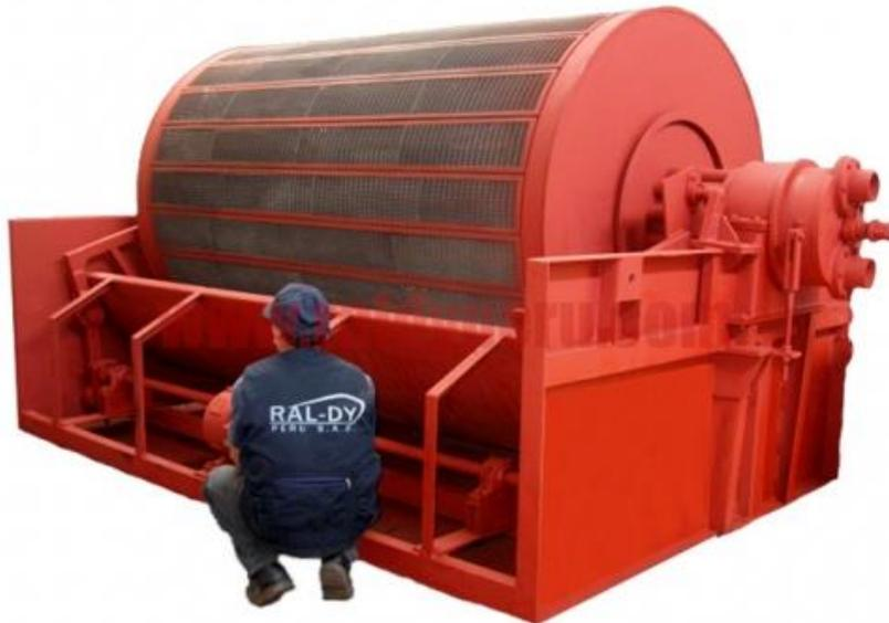
*Figura 27.* Filtro de Discos 8' X 5 Discos, Marca Ral-dy.
