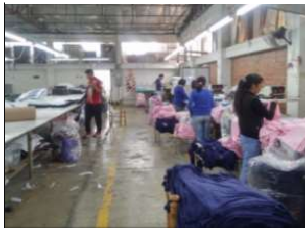
Figura 1. Uso inadecuado de las mesas de tendido - corte
