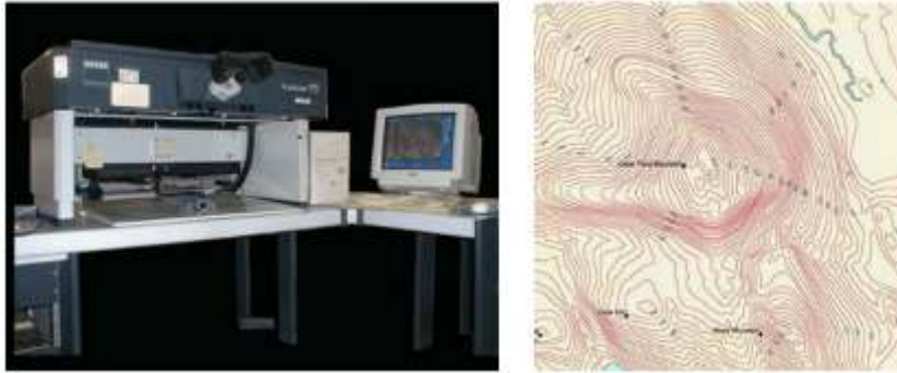
Figura n.º 24. Un trazador estéreo analítico generando diagramas de contorno. fuente: (Szeliski, 2010, p. 534)
