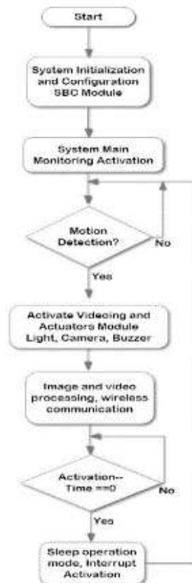
Figura n.º 50. Diagrama de flujo del sistema de detección de intrusos. fuente: (Sabri et al., 2018, p.5)
