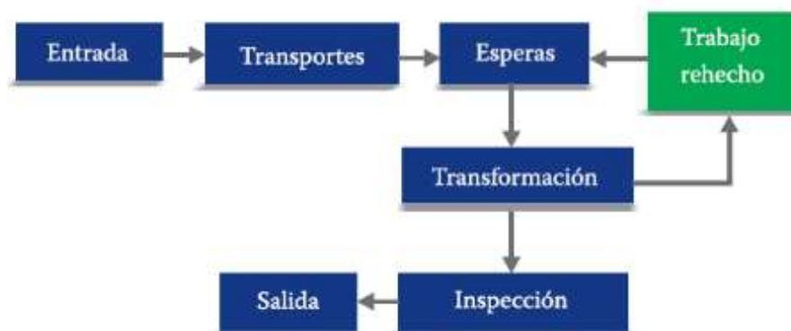
**Figura IV.** Modelo de producción Lean o TFV. Tomado de *Productividad en la Construcción de un condominio aplicando conceptos de la filosofía Lean Construction*.
