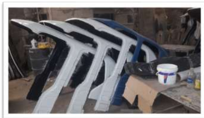
Figura 23. Desmoldado de Techos.
