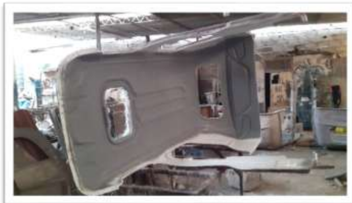
Figura 21. Laminado de techo de fibra de vidrio.
