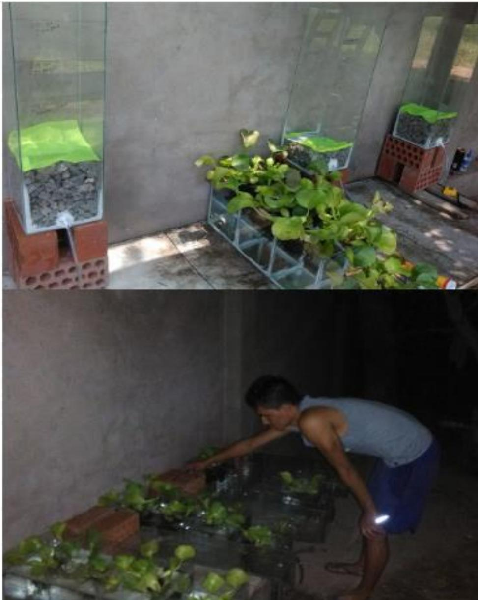
*Anexo 12: Operación de las columnas de vermifiltración*
