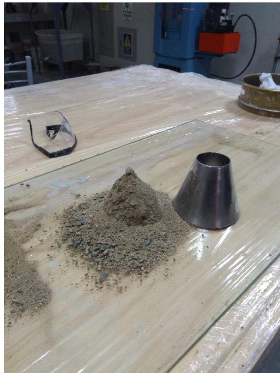
Fotografía N° 10: Agregado fino en condición saturada superficialmente seca
