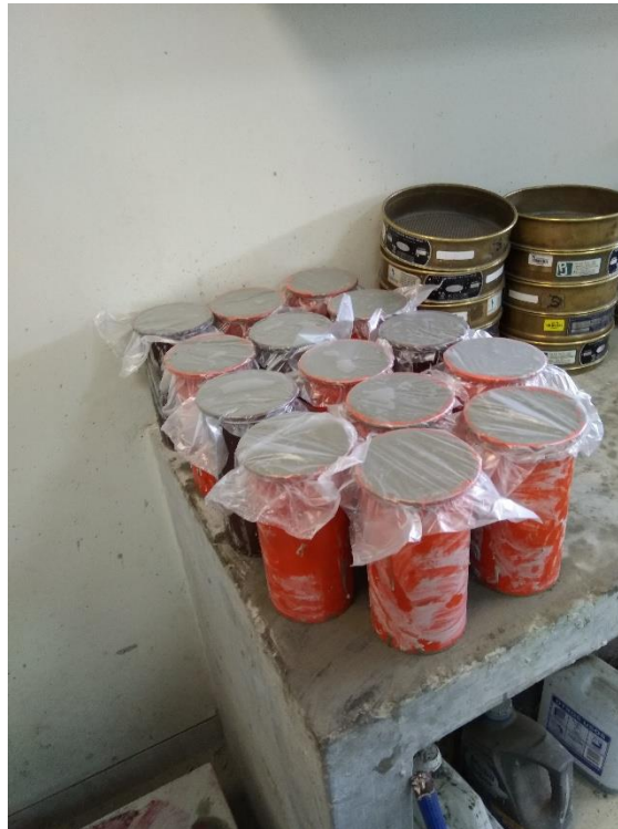
Fotografía N° 23: Vaciado y encofrado de probetas patrón
