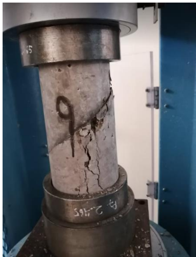
Fotografía N° 36: Probeta con lechada cementicia después de ser sometida a ensayo de compresión
