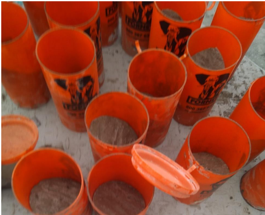
Fotografía N° 26: Encofrado de la primera mitad de probetas para las lechadas
