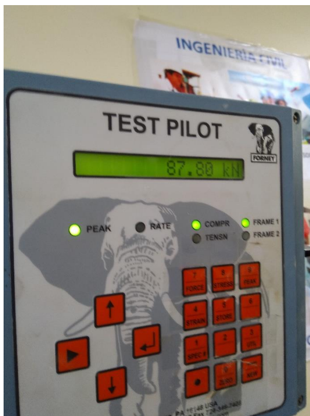
Fotografía N° 43: Resultado de probeta con lechada cementicia sometida a tracción
