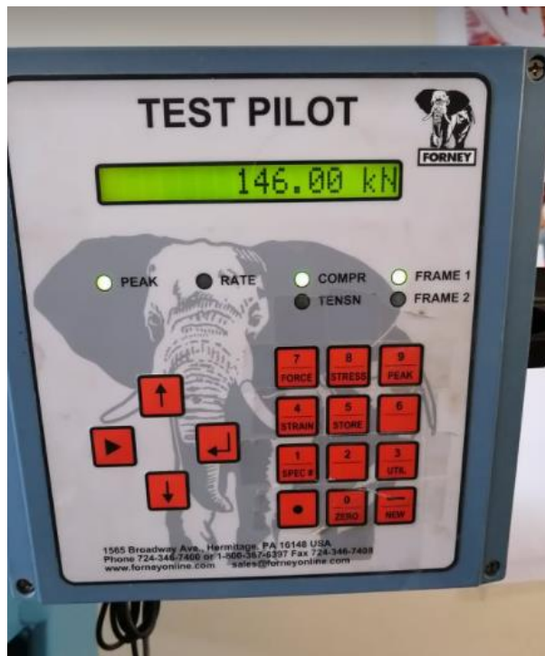
Fotografía N° 37: Resultados de probeta con lechada cementicia sometida a ensayo de compresión
