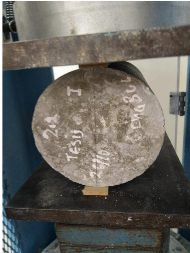
Fotografía N° 41: Probeta con lechada cementicia sometida a fuerza de tracción
