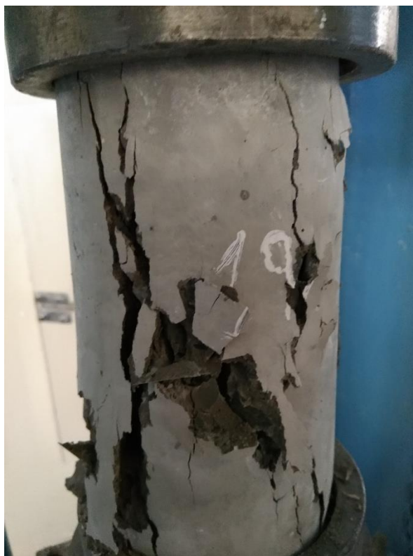
Fotografía N° 33: Probeta patrón después de haber sido sometida a compresión
