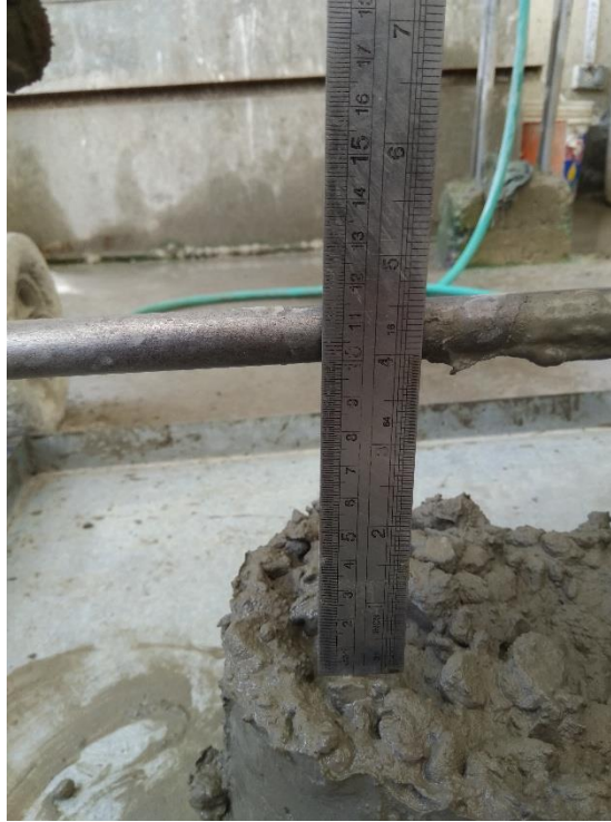
Fotografía N° 21: Cono de Abrahams - Asentamiento 4"
