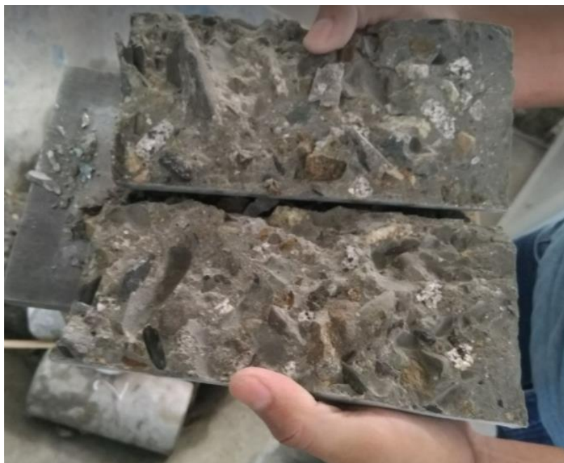
Fotografía N° 44: Vista interna de probeta patrón sometida a tracción
