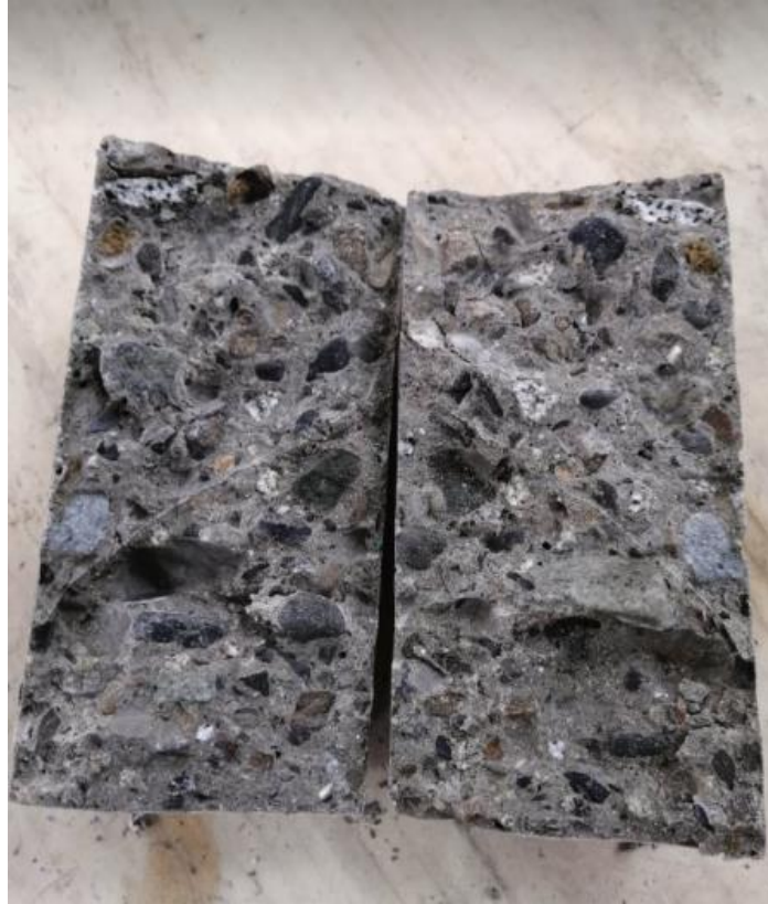
Fotografía N° 45: Vista interna de probeta con lechada cementicia sometida a tracción
