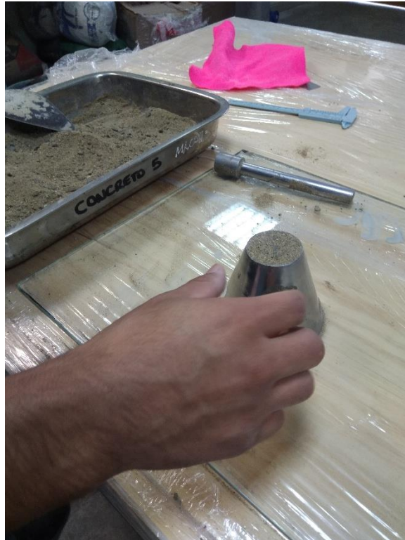
Fotografía N° 9: ensayo para humedad superficial
