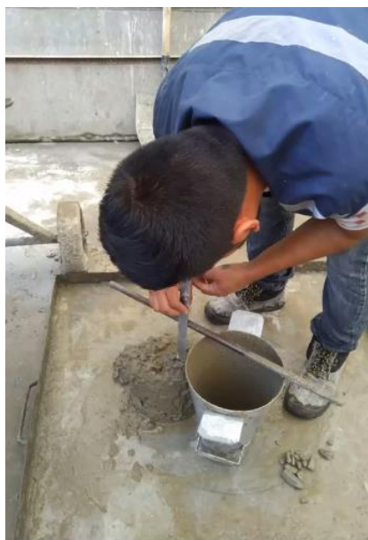
Figura N° 8: Ensayo de Asentamiento
