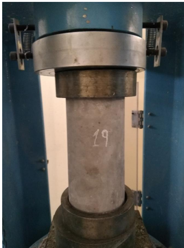
Fotografía N° 32: Probeta patrón sometida a ensayo de compresión
