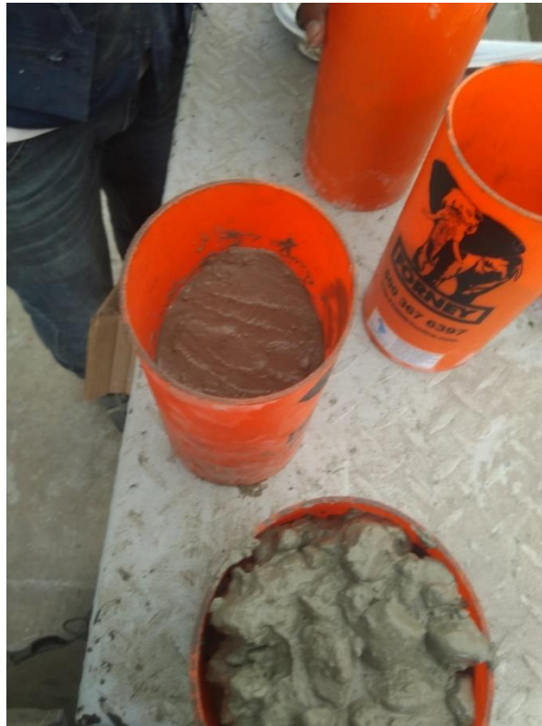
Fotografía N° 29: Vaciado y llenado de probetas - segunda mitad
