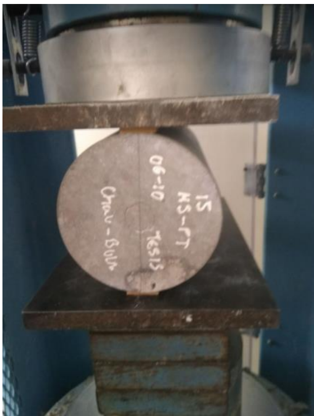
Fotografía N° 38: Probeta patrón sometida a ensayo de tracción
