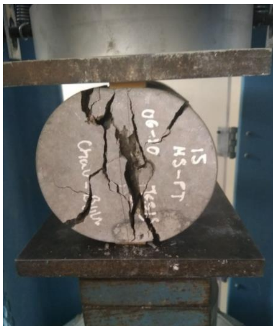
Fotografía N° 39: Probeta patrón después de ser sometida a ensayo de tracción
