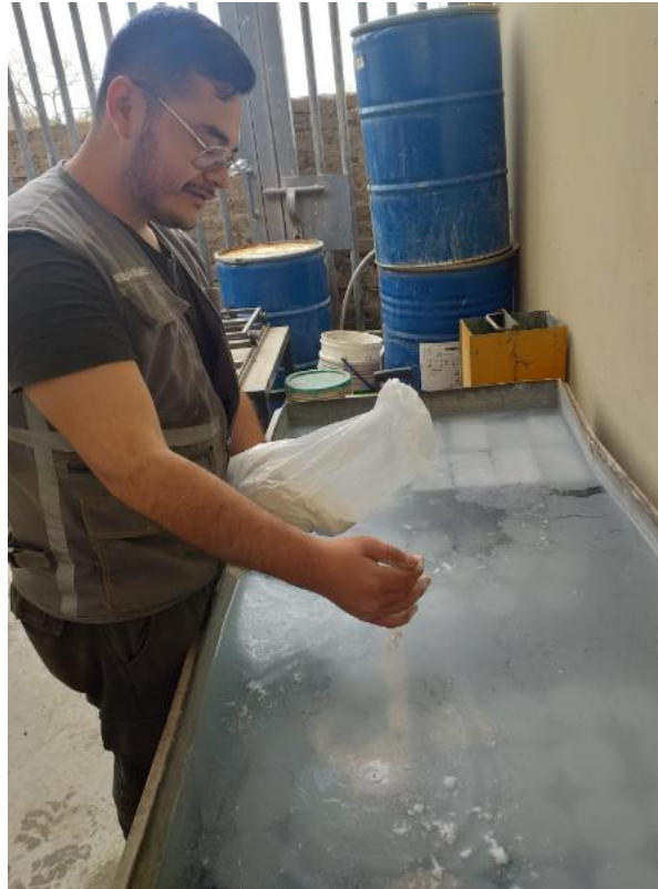
Fotografía N° 19: Rociado de cal a la fosa de curado
