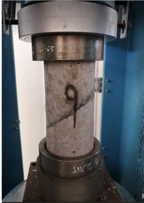
Fotografía N° 35: Probeta con lechada cementicia sometida ensayo de compresión
