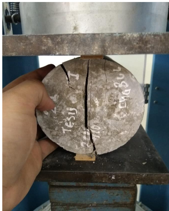
Fotografía N° 42: Probeta con lechada cementicia después de haber sido sometida a tracción
