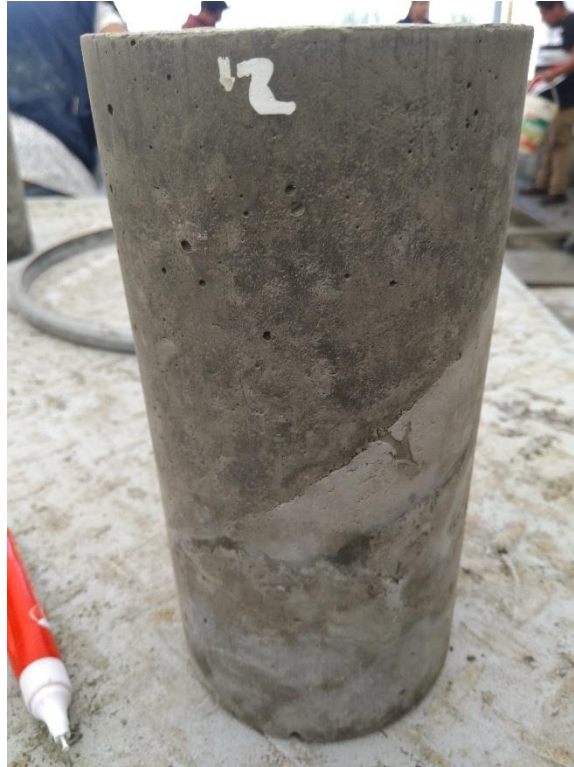
Fotografía N° 31: Probeta con lechada cementicia desencofrada
