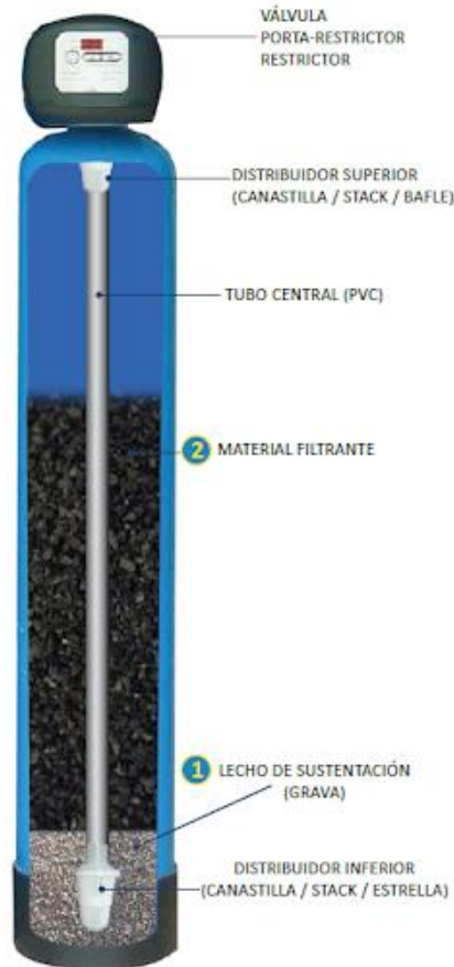
Figura 12. vista interna del filtro de carbón, merinsac, Perú, 2019
