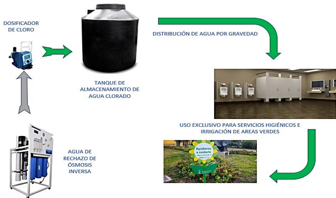
Figura 19. Instalación de conexiones para el aprovechamiento del agua residual, Hospital Víctor Lazarte Echegaray, 2020.
