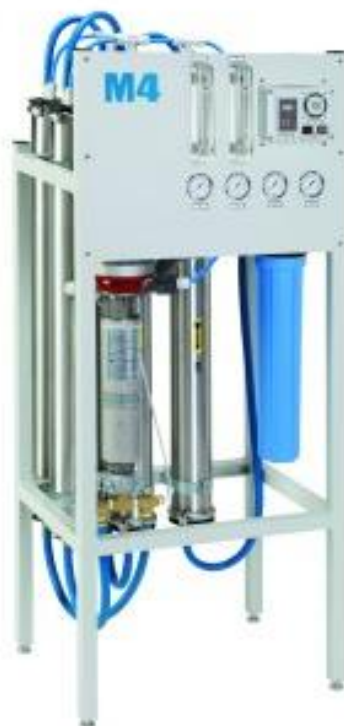
Figura 16. equipo de ósmosis inversa, merinsac, Perú, 2019
