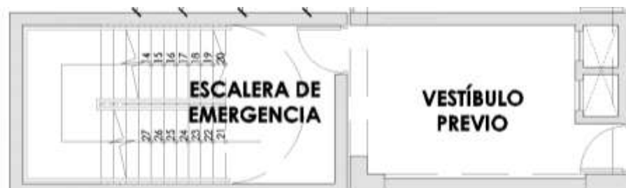
Figura N°125: Escalera de evacuación del proyecto
