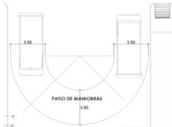
Figura N°124. Patio de maniobras del proyecto
