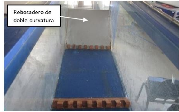
Figura 6: Rebosadero de doble curvatura y cuenco amortiguador por resalto hidráulico.
