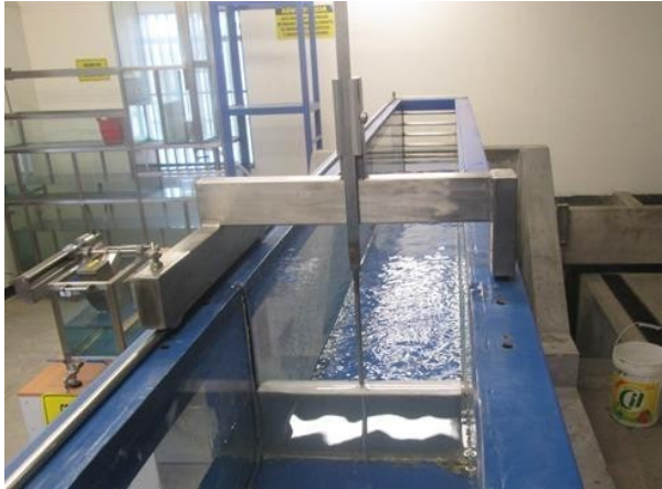
Figura 11: Medición de tirantes en modelo de laboratorio.
