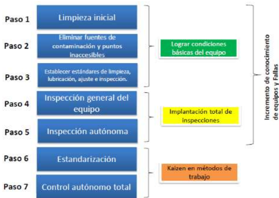
Figura 62. Pasos del mantenimiento autónomo sugerido por JIPM
