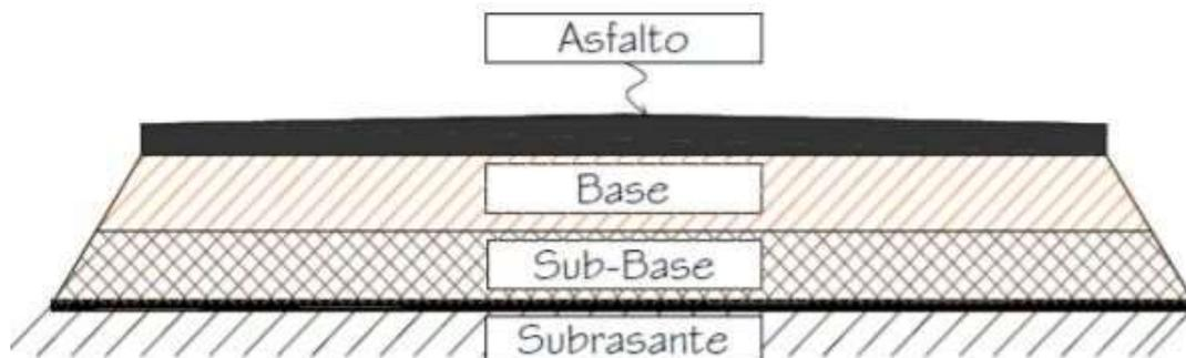
Figura 1. Sección típica transversal pavimento flexible
