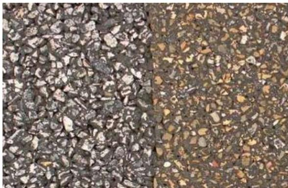
*Figura 11: Pulimiento de Agregado*
