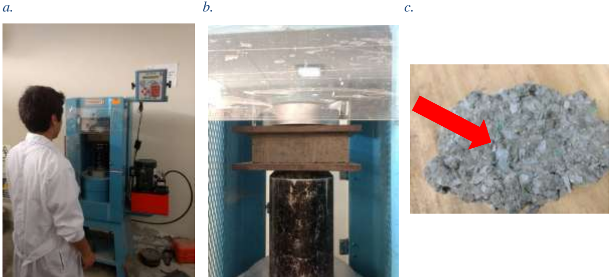
Figura 15. Ensayo de compresión. a. Prueba de resistencia a la compresión, b. Resistencia a la compresión de un adoquín, c. Muestra del adoquín con plástico
