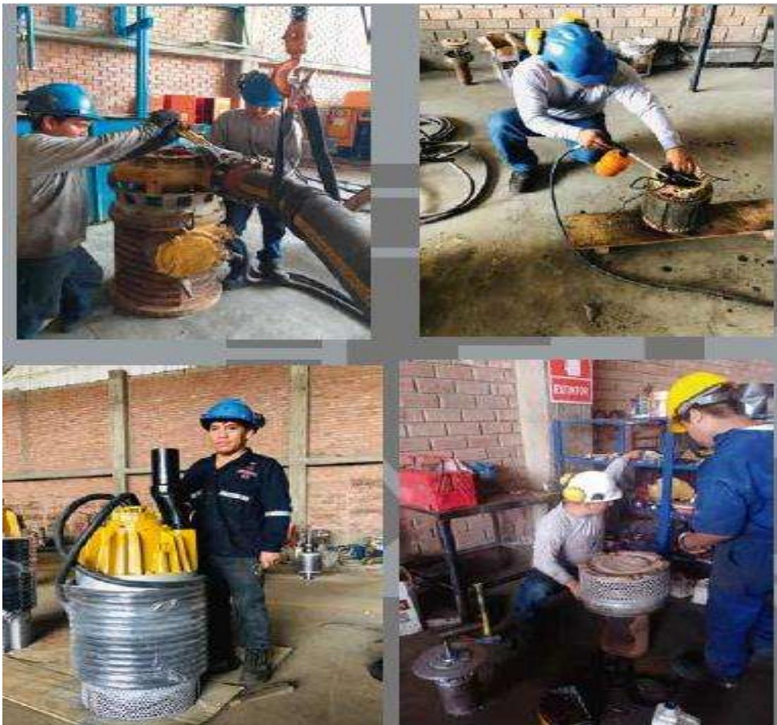
*Figura 4:* Personal de operaciones, haciendo mantenimiento y reparaciones a las bombas sumergible, de marca Grindex y modelo Maxi 60HP, Matador 33HP.
