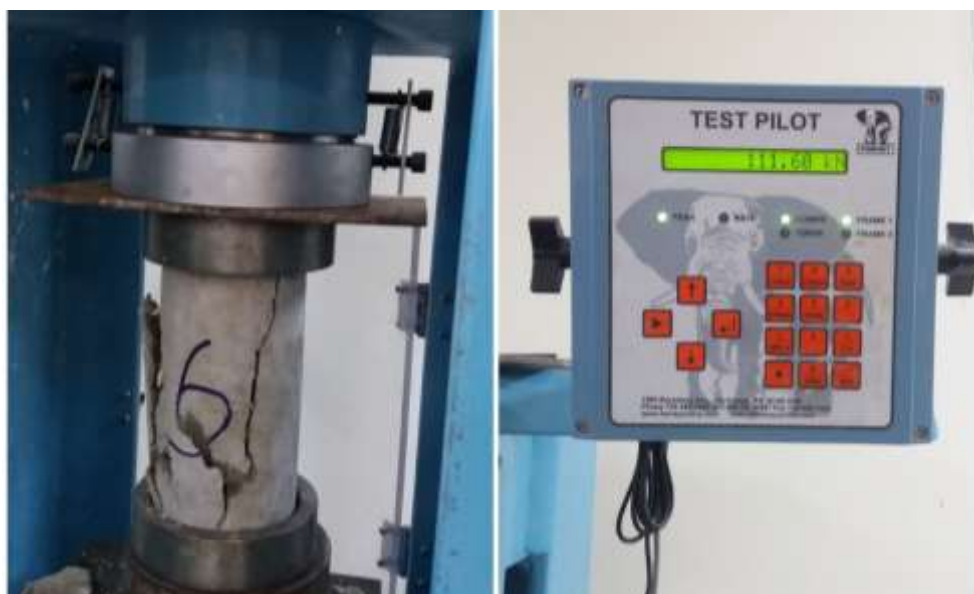
Figura N.º 14 Determinación de la resistencia a la compresión del concreto convencional.
