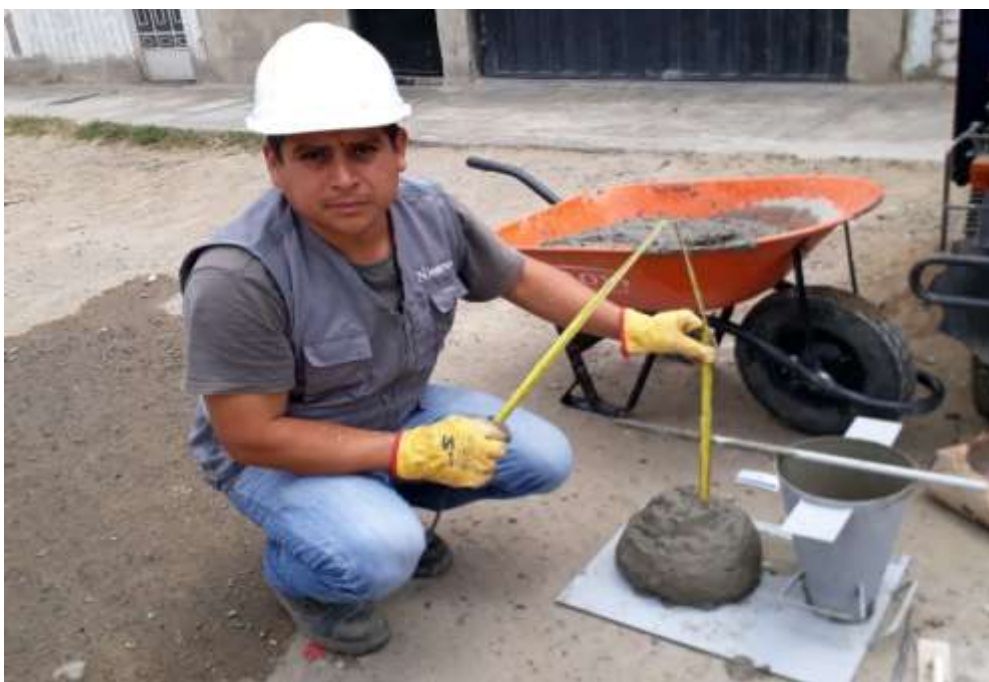
Figura N.º 10 Medición del asentamiento de concreto convencional.
