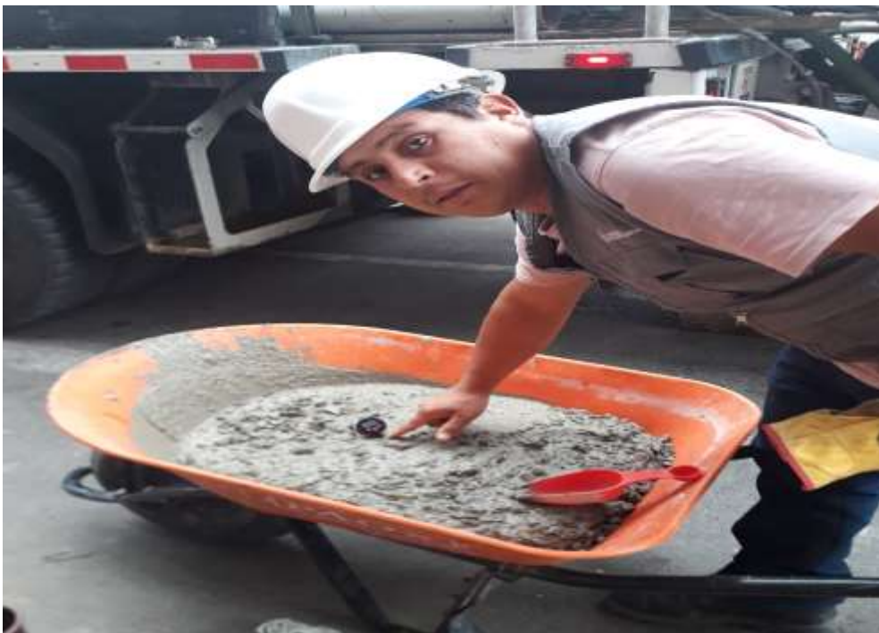
Figura N.° 02 Determinación de la temperatura de la mezcla de concreto premezclado en estado fresco.
