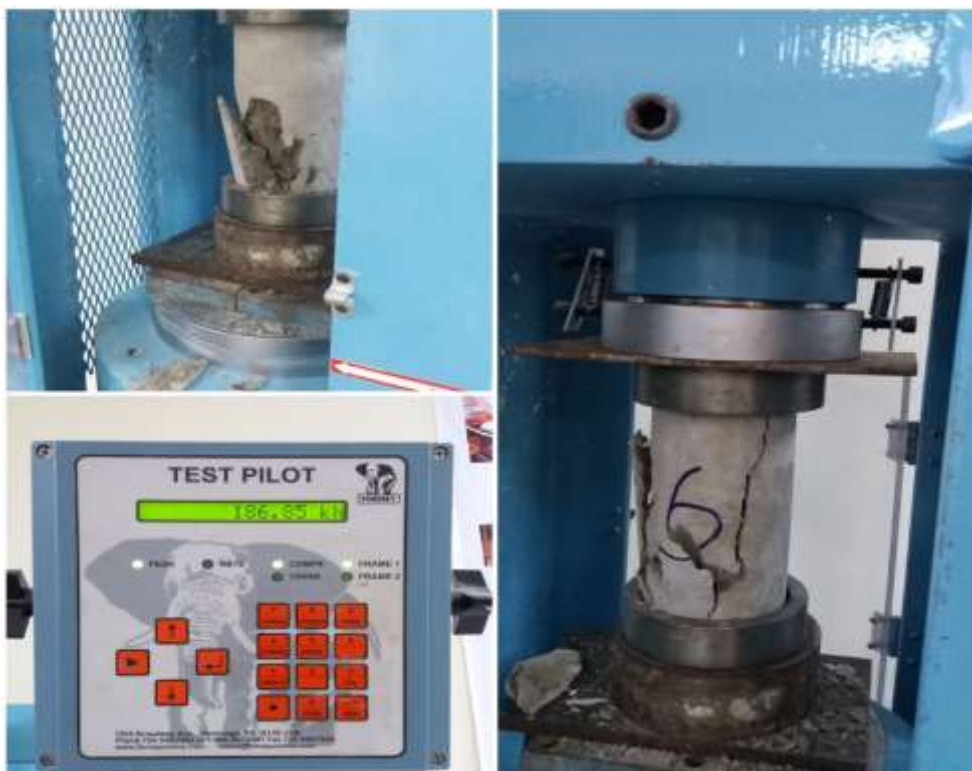
Figura N. ° 07 Determinación de la resistencia a la compresión del concreto en muestras cilíndricas.
