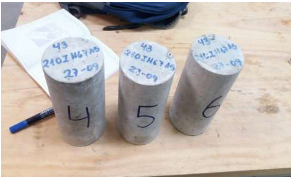
Figura N.º 05 Especímenes de concreto premezclado.
