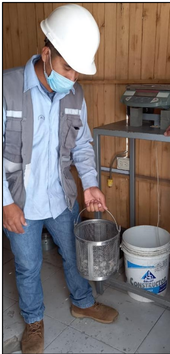
Figura 41: Peso específico y absorción del agregado grueso Fuente: Autores de tesis
