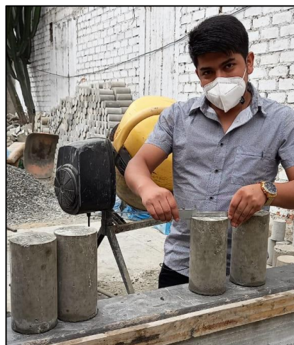
Figura 95: Toma de medidas de las probetas para ensayarlas a compresión Fuente: Autores de tesis
