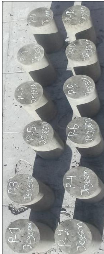
Figura 91: Desencofrado de probetas para someterlas al curado final Fuente: Autores de tesis
