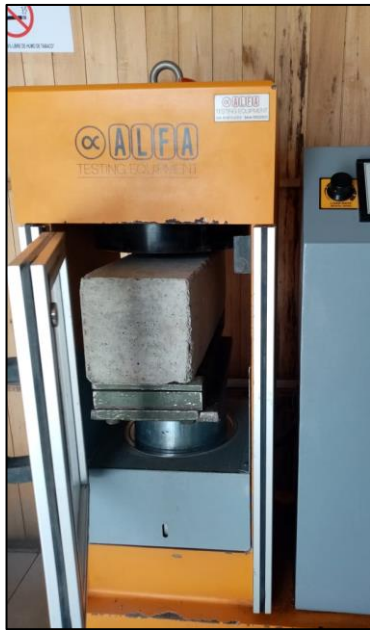
Figura 101: Ensayo a la flexión del concreto Fuente: Autores de tesis
