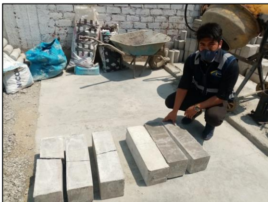
Figura 110: Probetas ensayas a flexión a los 14 días Fuente: Autores de tesis
