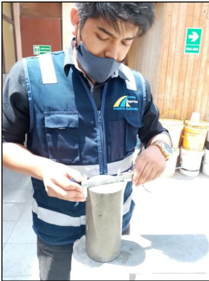
Figura 97: Tomando medidas a las dimensiones de la probetas cilíndricas Fuente: Autores de tesis
