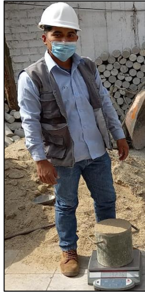
Figura 50: Peso unitario compactado del agregado fino Fuente: Autores de tesis
