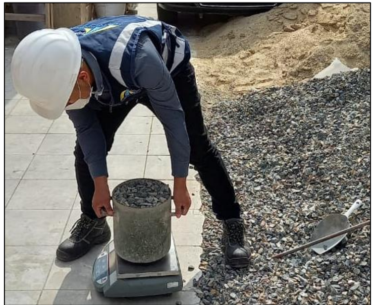
Figura 45: Peso unitario compactado del agregado grueso Fuente: Autores de tesis
