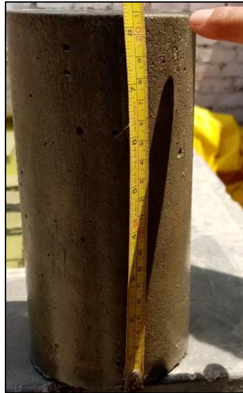
Figura 97: Tomando medidas a las dimensiones de la probetas cilíndricas Fuente: Autores de tesis
