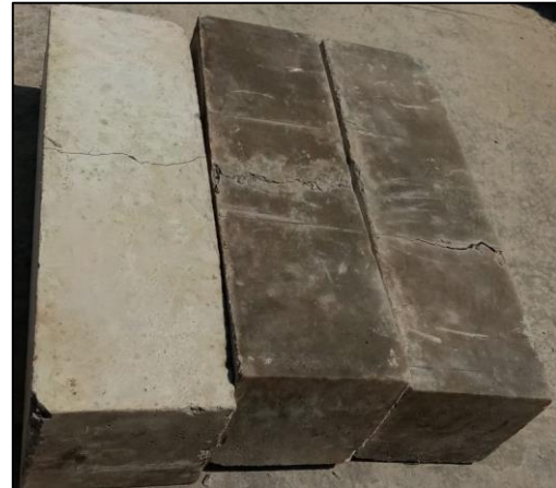
Figura 105: Rotura de probetas de concreto con fibras de acero más superplastificante Fuente: Autores de tesis
