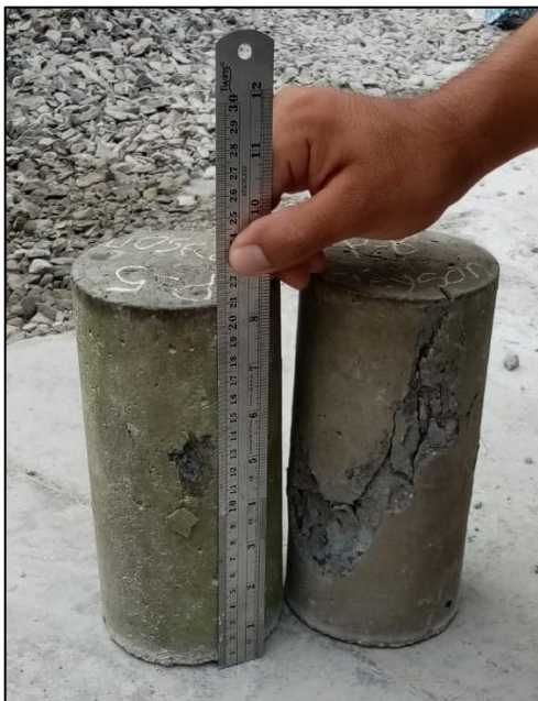
Figura 102: Toma de medidas en probetas cilíndricas, después de la resistencia a la compresión
