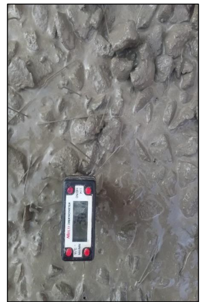
Figura 68: Temperatura de la mezcla del concreto con fibras de acero más aditivo superplastificante Fuente: Autores de tesis
