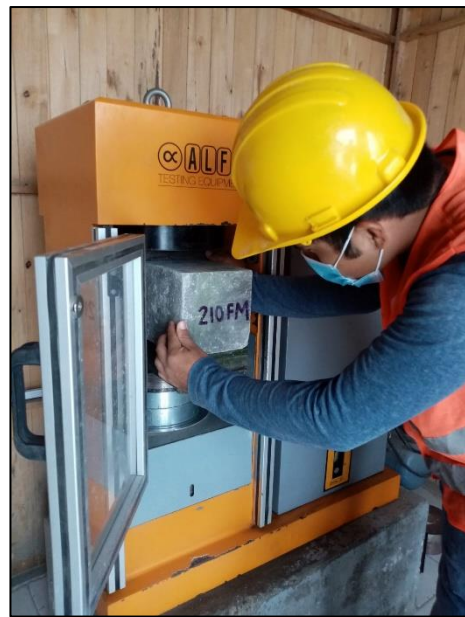
Figura 100: Verificación del ensayo de flexión Fuente: Autores de tesis
