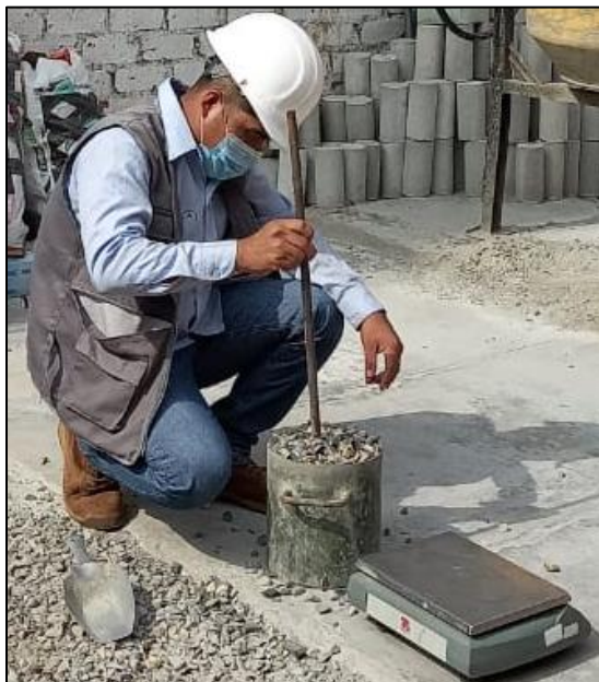
Figura 48: Chuseando para el peso unitario de la grava Fuente: Autores de tesis
