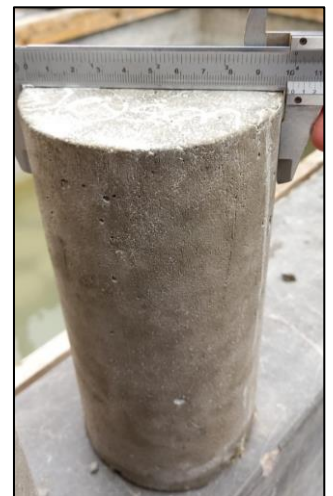
Figura 95: Toma de medidas de las probetas para ensayarlas a compresión Fuente: Autores de tesis
