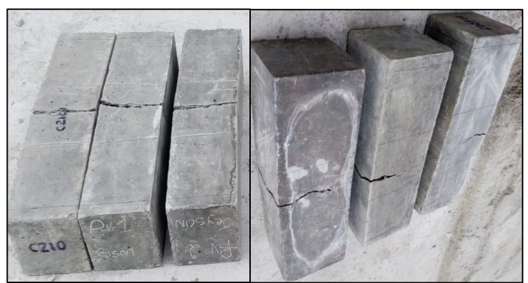
Figura 109: Resultado de probetas ensayas a flexión a los 28 días Fuente: Autores de tesis
