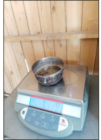
Figura 49: Peso del recipiente para el contenido de humedad Fuente: Autores de tesis
