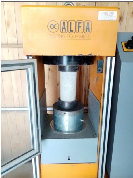
Figura 99: Ensayo a la compresión del concreto Fuente: Autores de tesis
