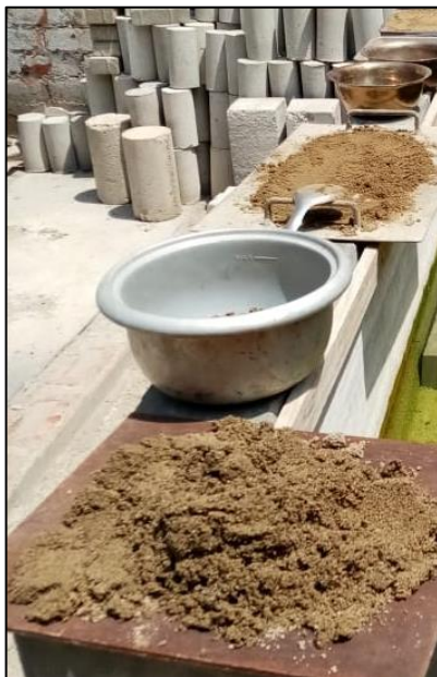
Figura 43: Mostrando el ensayo de absorción del agregado grueso Fuente: Autores de tesis
