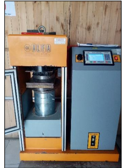
Figura 96: Máquina de compresión y flexión Fuente: Autores de tesis
