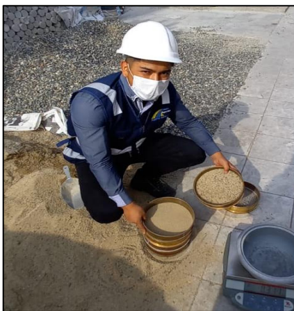
Figura 38: Análisis granulométrico del agregado fino. Fuente: Autores de tesis
