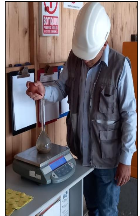
Figura 40: Análisis Peso específico y absorción del agregado fino. Fuente: Autores de tesis
