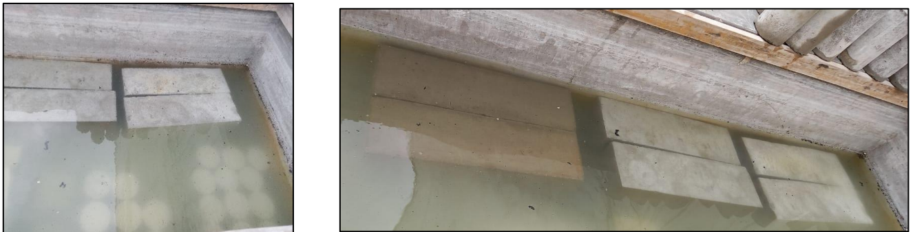
Figura 93: Curado de probetas cilíndricas y prismáticas Fuente: Autores de tesis
