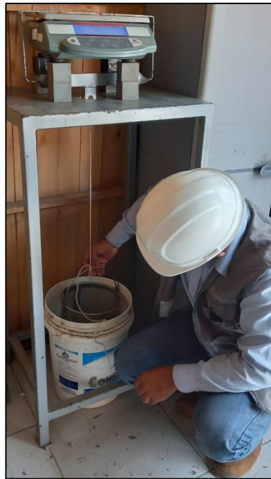
Figura 41: Peso específico y absorción del agregado grueso Fuente: Autores de tesis
