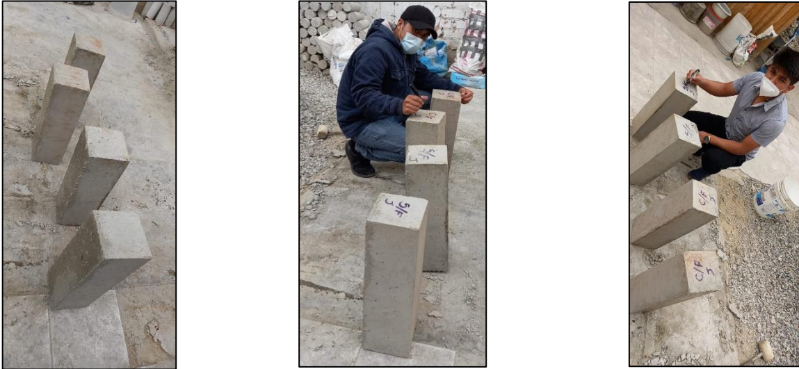
Figura 92: Desencofrado y colocación de marca en probetas Fuente: Autores de tesis
