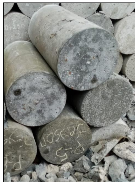
Figura 103: Vista de probetas cilíndricas después del ensayo a la compresión
