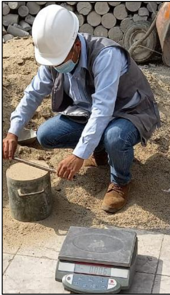
Figura 51: Peso unitario suelto del agregado fino Fuente: Autores de tesis
