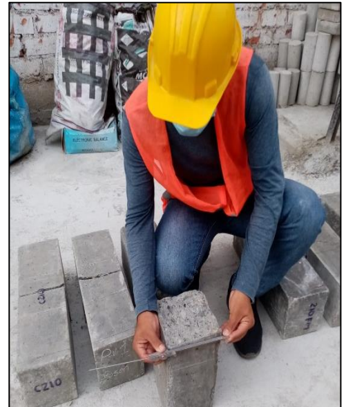
Figura 106: Toma de medidas en probetas prismáticas, después del ensayo a la flexión Fuente: Autores de tesis
