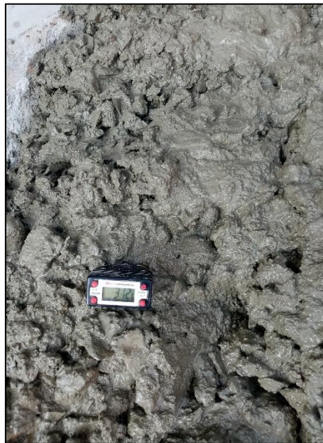
Figura 69: Temperatura de la mezcla del concreto tradicional Fuente: Autores de tesis
