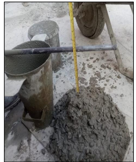
Figura 73: Consistencia del concreto con fibras de acero más aditivo superplastificante Fuente: Autores de tesis
