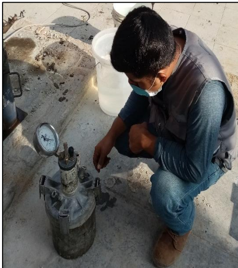
Figura 80: Ensayo del contenido de aire atrapado en el concreto Fuente: Autores de tesis
