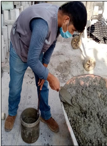
Figura 74: Ensayo del peso unitario del concreto Fuente: Autores de tesis
