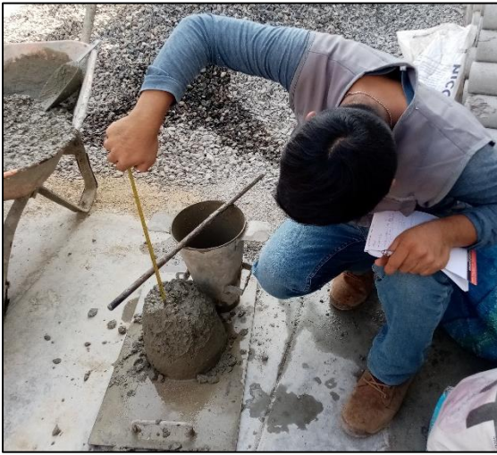
Figura 71: Ensayo de consistencia del concreto Fuente: Autores de tesis
