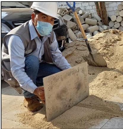
Figura 36: Método de cuarteo del agregado fino. Fuente: Autores de tesis
