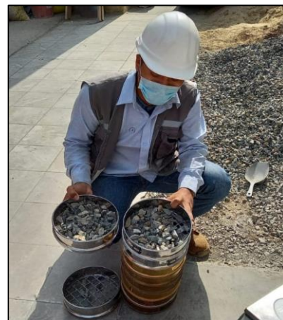
Figura 39: Análisis granulométrico del agregado grueso. Fuente: Autores de tesis
