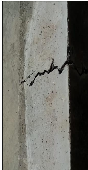
Figura 108: Corte central con de concreto con fibras de acero más superplastificante Fuente: Autores de tesis
