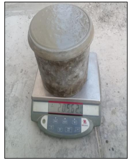
Figura 78: Muestra del peso unitario del concreto con fibras de acero más aditivo superplastificante Fuente: Autores de tesis
