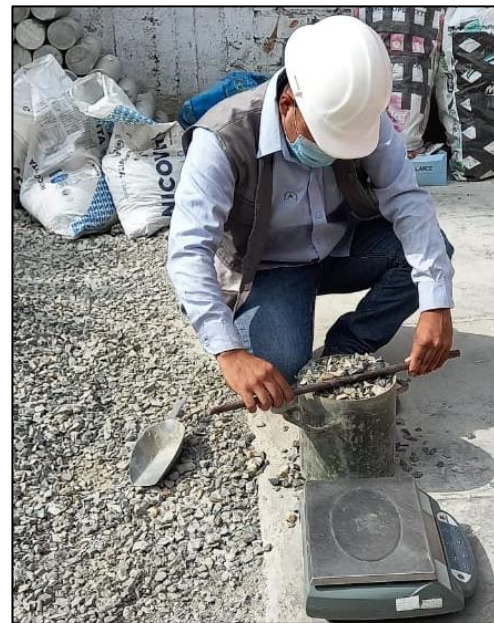
Figura 47: Enrazando para el peso unitario de la grava Fuente: Autores de tesis
