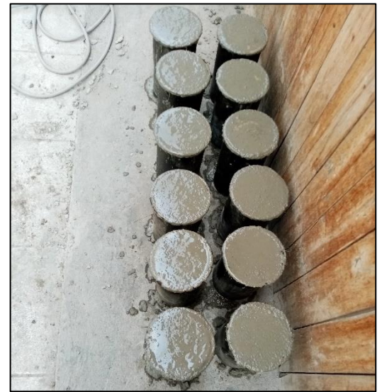
Figura 88: Probetas cilíndricas de concreto con fibras de acero más aditivo superplastificante Fuente: Autores de tesis
