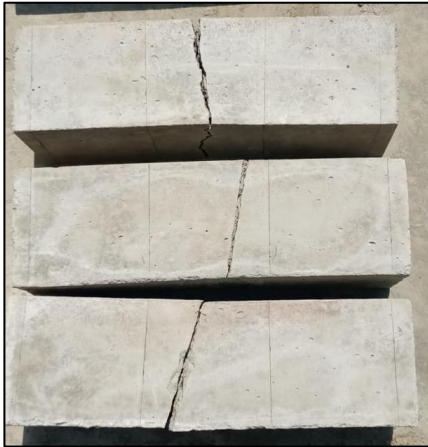
Figura 104: Rotura de probetas de concreto tradicional Fuente: Autores de tesis
