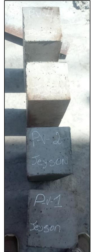
Figura 89: Probetas prismáticas de concreto con fibras de acero más aditivo superplastificante Fuente: Autores de tesis
