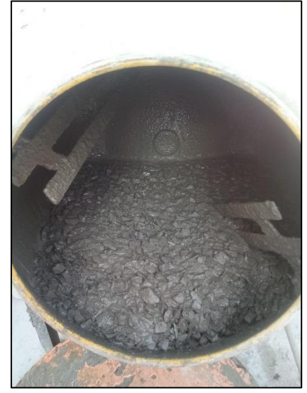
Figura 66: Mezcla del concreto con fibras de acero más aditivo superplastificante Fuente: Autores de tesis
