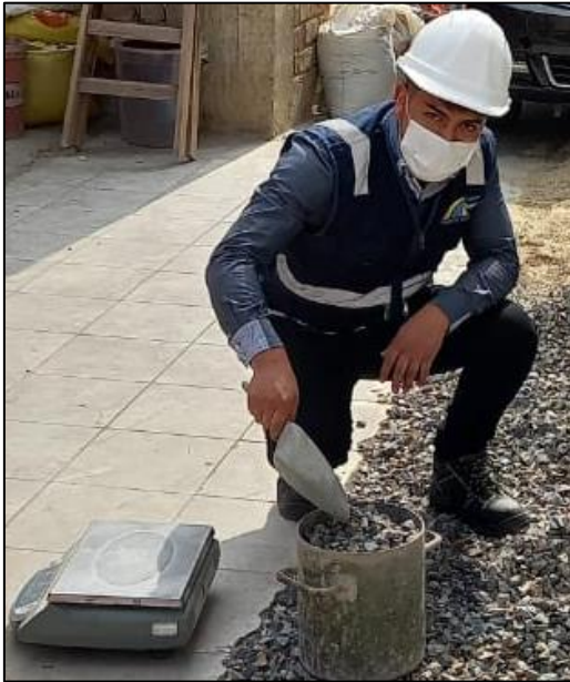
Figura 46: Peso unitario suelto del agregado grueso Fuente: Autores de tesis
