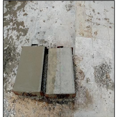
Figura 89: Probetas prismáticas de concreto con fibras de acero más aditivo superplastificante Fuente: Autores de tesis
