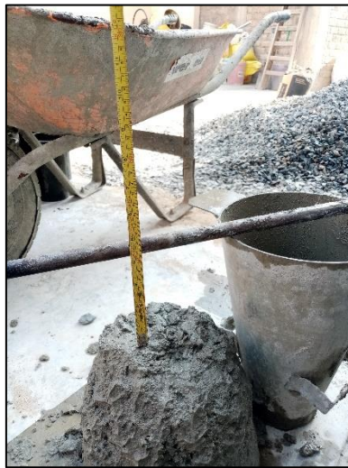
Figura 72: Consistencia del concreto tradicional Fuente: Autores de tesis
