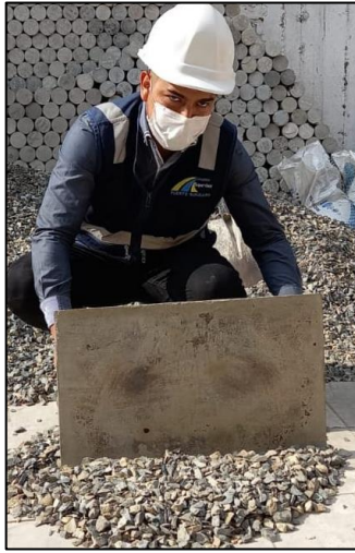
Figura 34: Método de cuarteo del agregado grueso. Fuente: Autores de tesis
