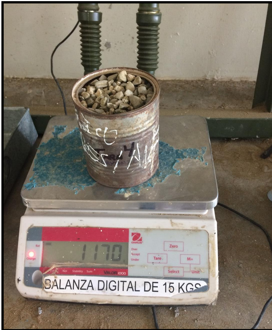
Imagen N°07: Pesando la muestra en estado natural, para realizar el ensayo de contenido de humedad.
