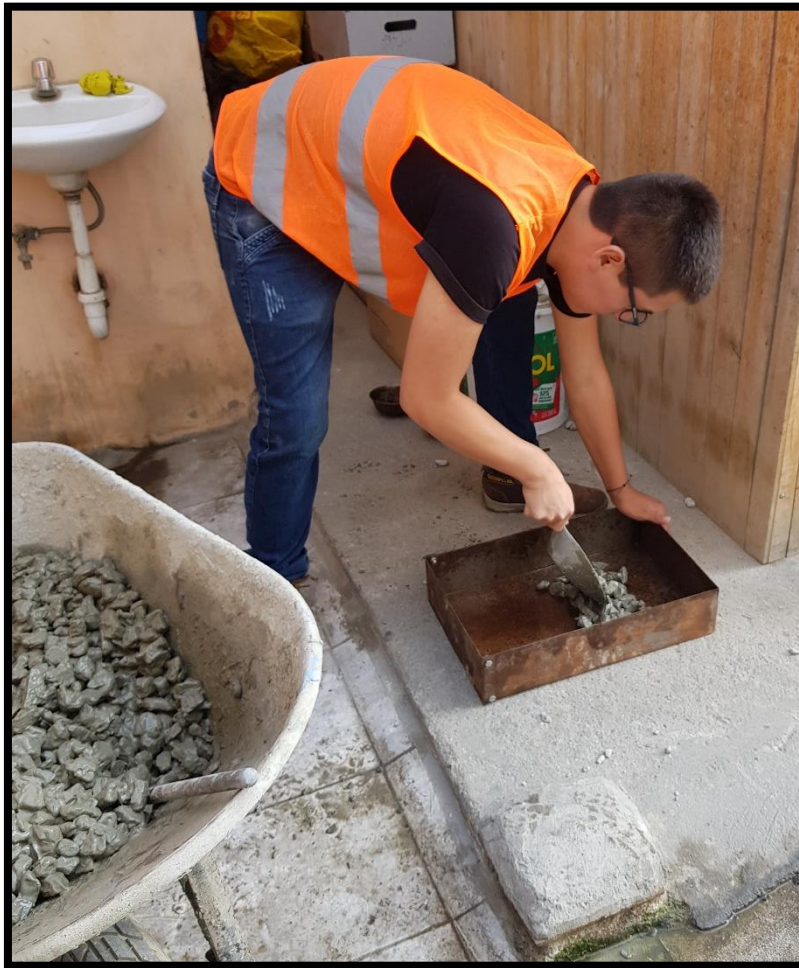
Imagen N°24: Elaboración de probetas rectangular, para el ensayo de infiltración.
