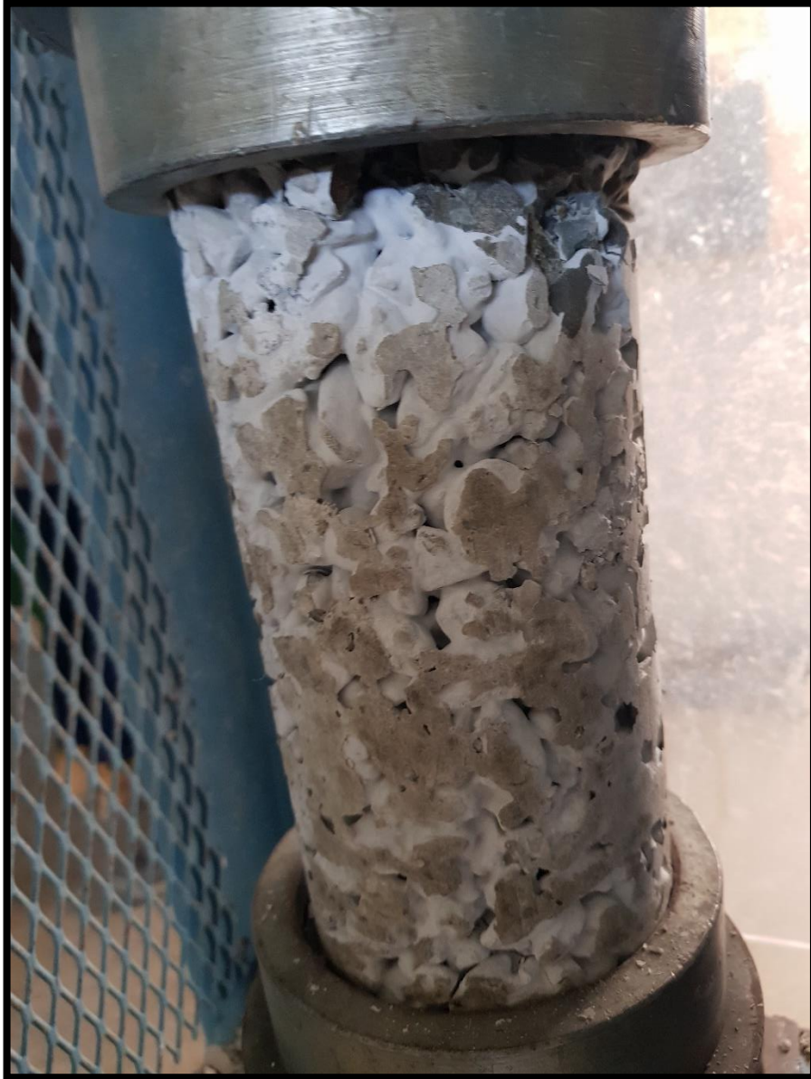
Imagen N°37: Falla de la probeta, elaborada con agregado de 3/4".
