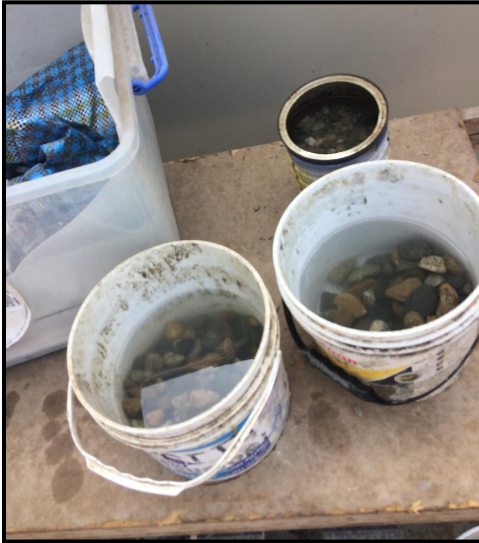
Imagen N°10: Material sumergido en agua por un periodo de tiempo de 24 horas.
