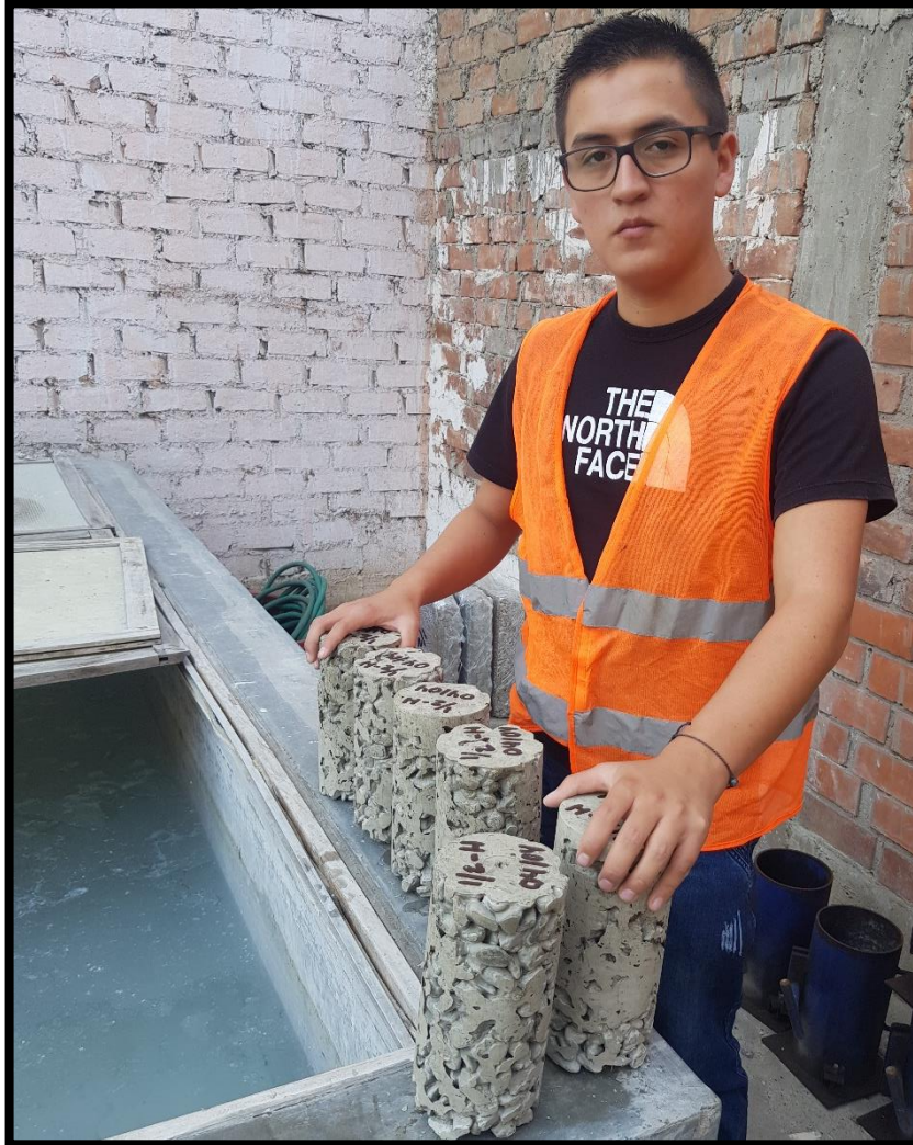
Imagen N°27: Desencofrado de probetas cilíndricas.
