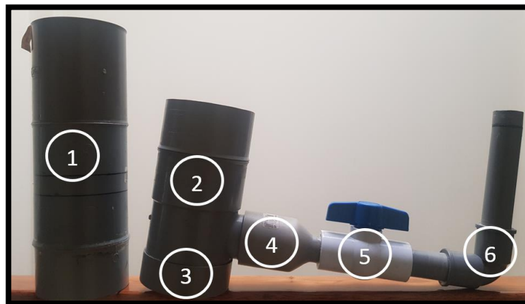
Imagen N°02: Montaje del permeámetro.
