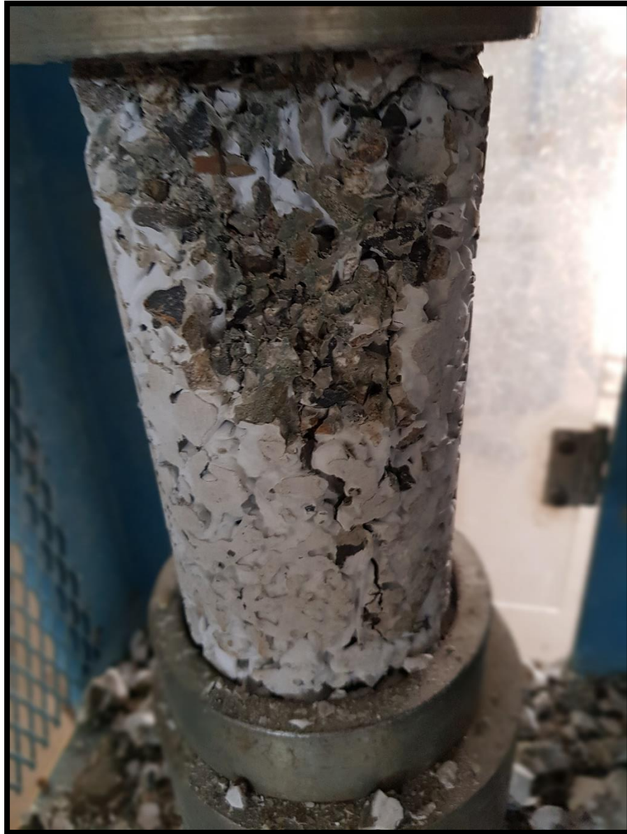
Imagen N°36: Falla de la probeta, elaborada con agregado de ½".
