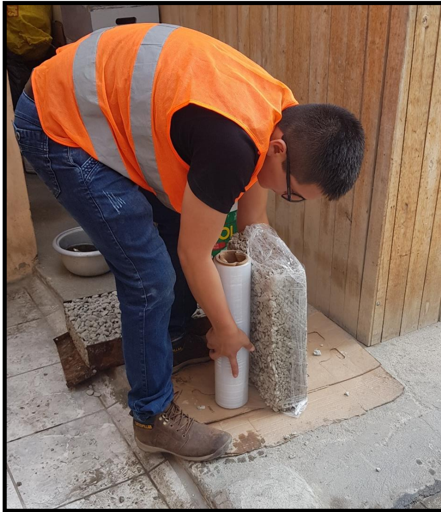
Imagen N°30: Curado de las probetas rectangulares con papel fill, para el ensayo de infiltración.
