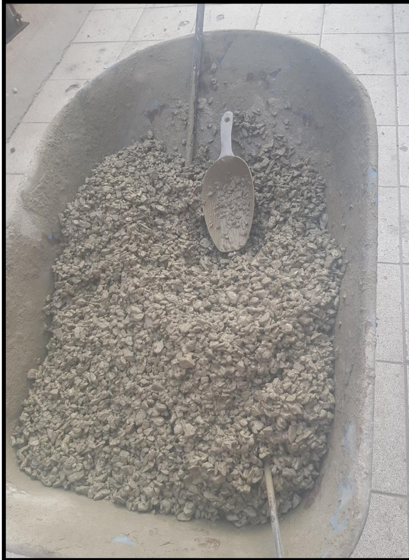
Imagen N°20: Mezcla en estado fresco, agregado de 3/8".
