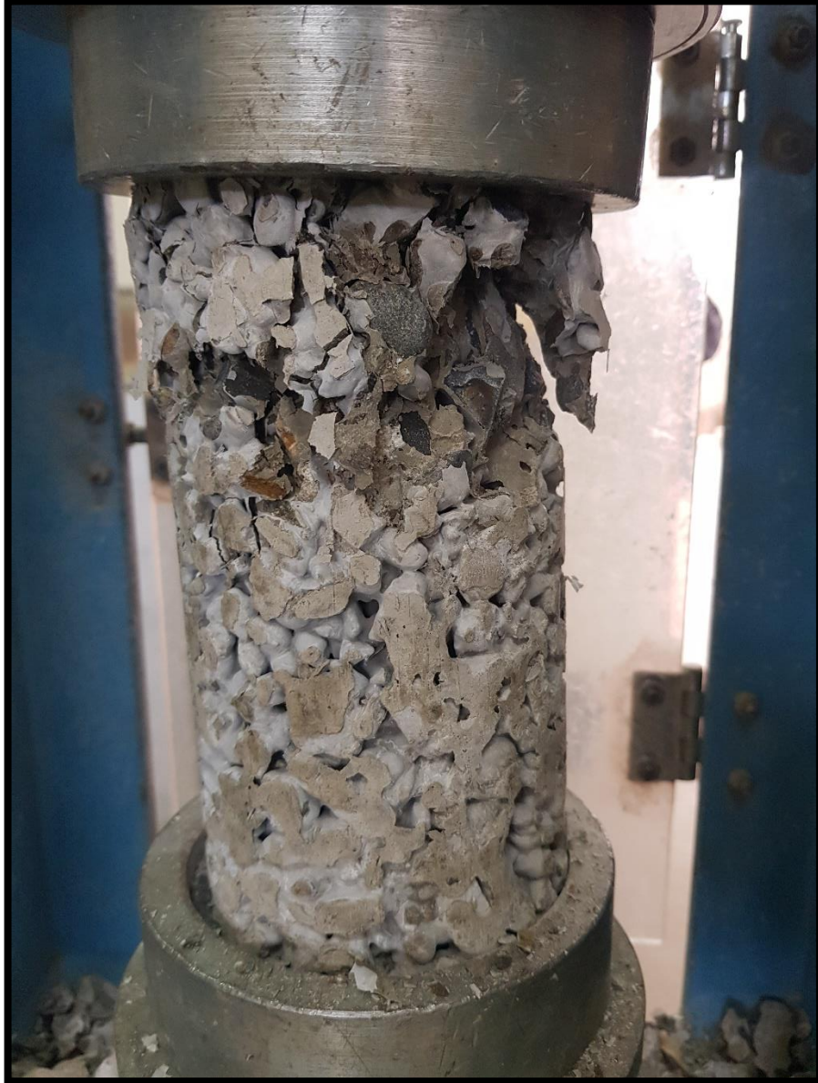
Imagen N°35: Falla de la probeta.
