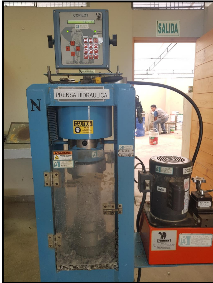
Imagen N°34: Realizando el ensayo de resistencia a la compresión en la compresora hidráulica.
