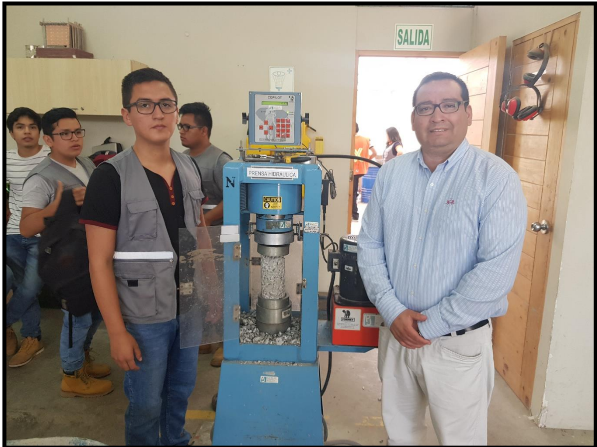
Imagen N°38: Realizando el ensayo de resistencia a la compresión con la inspección del ingeniero asesor de tesis.
