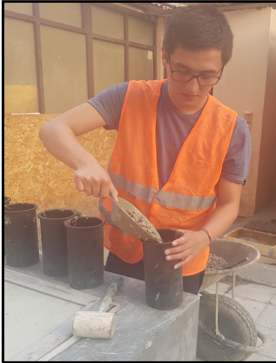
Imagen N°26: Elaboración de probetas cilíndrica para el ensayo de compresión.
