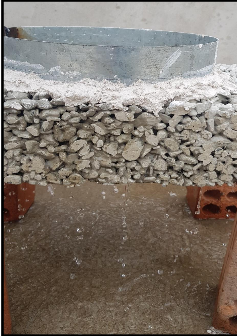
Imagen N°43: Realizando ensayo de infiltración a probeta rectangular elaborada con agregado de 3/8".
