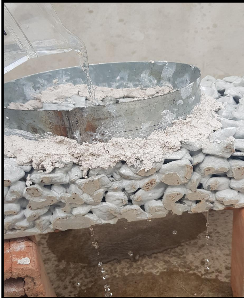
Imagen N°42: Realizando ensayo de infiltración a probeta rectangular elaborada con agregado de ¾".
