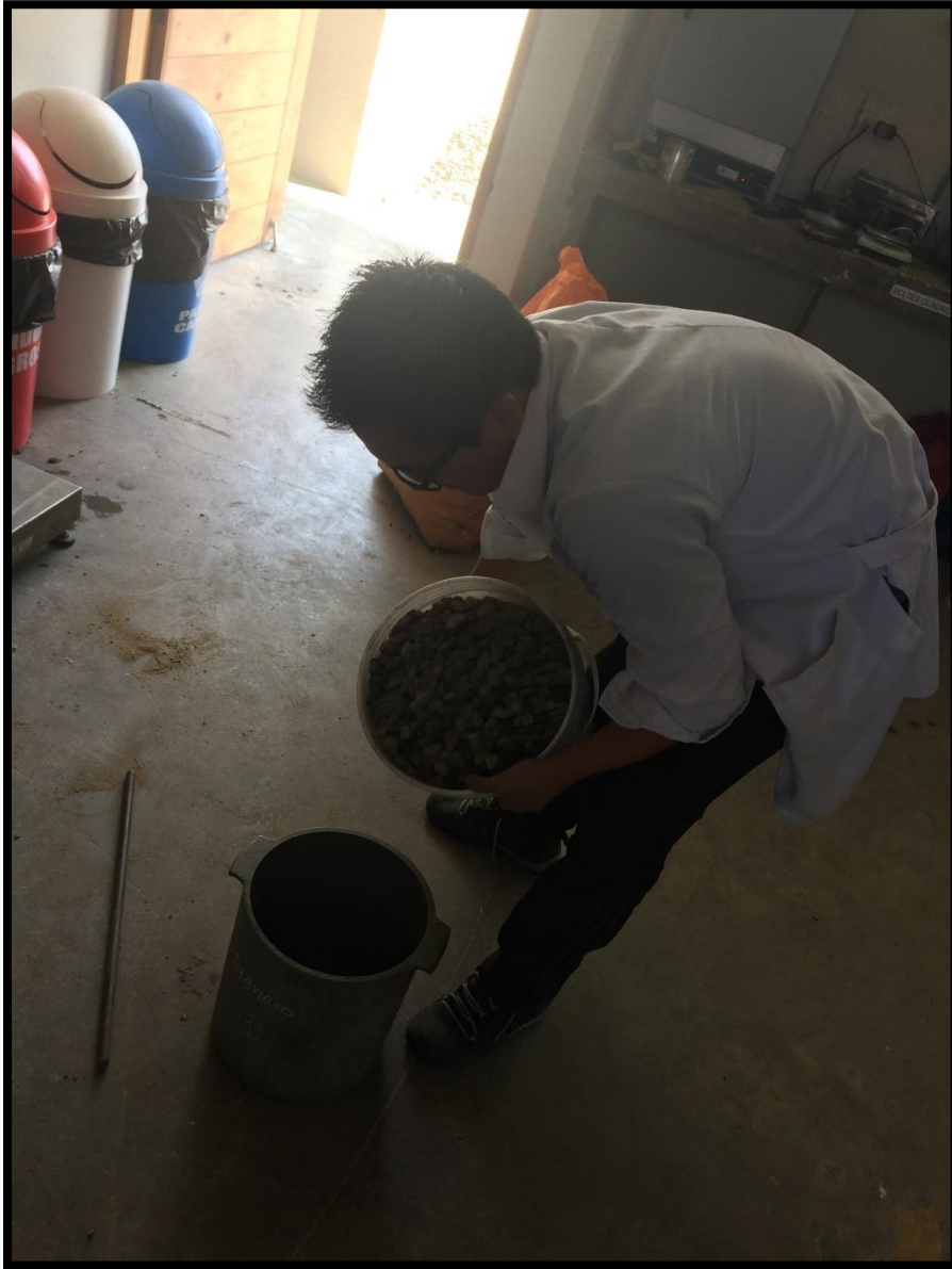
Imagen N°13: Realizando el vaciado del agregado en el recipiente, sin compactar.
