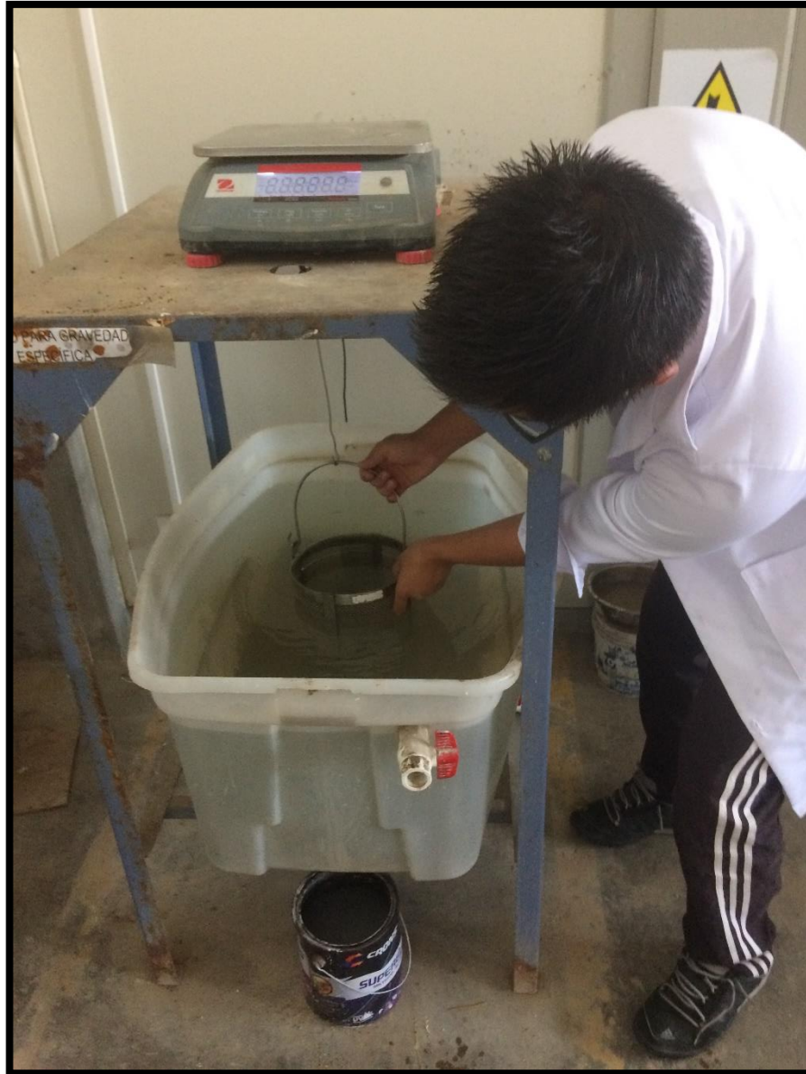
Imagen N°11: Colocando el agregado en la malla metálica para obtener el peso sumergido.
