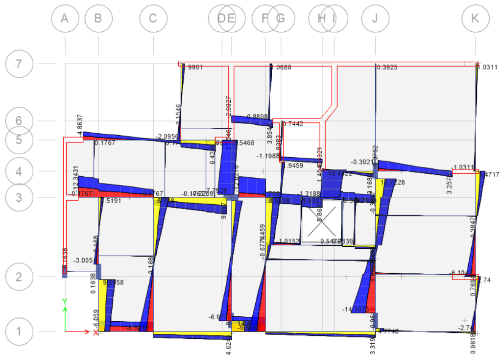
Figura 66. Momento de corte (V) en las vigas en general del nivel 6, según Nch.433.
