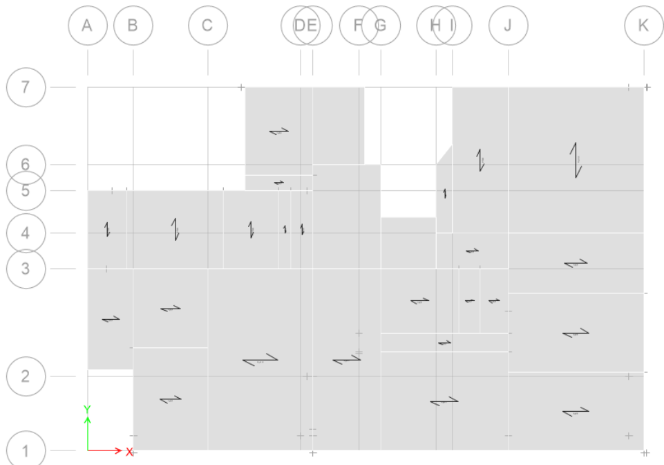
Figura 20: Vista en planta típica de losa, tercero y quinto nivel con ETABS.
