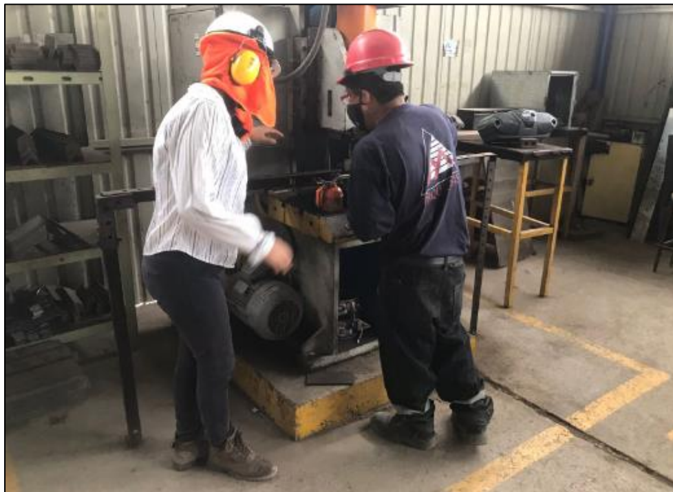
Figura 118: Perforación de ángulos. Fuente: proyecto 01
