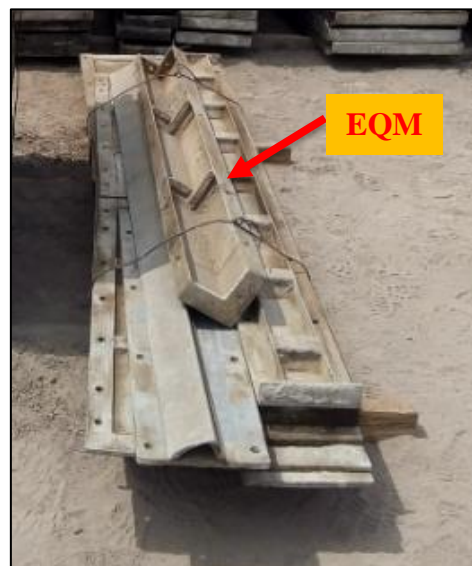
Figura 24: Esquinero (EQM). Fuente: Edificación Proyecto 02
