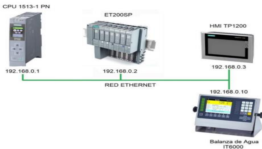
Figura 11. Arquitectura de red. Fuente: JYS Control Automation (2019)
